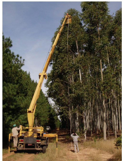
Foto 11 - Hidroelevador para cosecha de semillas eucalipto. Concordia.
