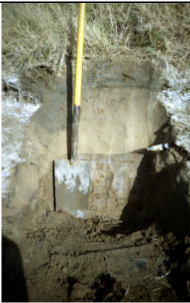
c) Suelo con horizonte nátrico enterrado (Bt). Este horizonte impide el drenaje profundo. Ambiente tendido.
