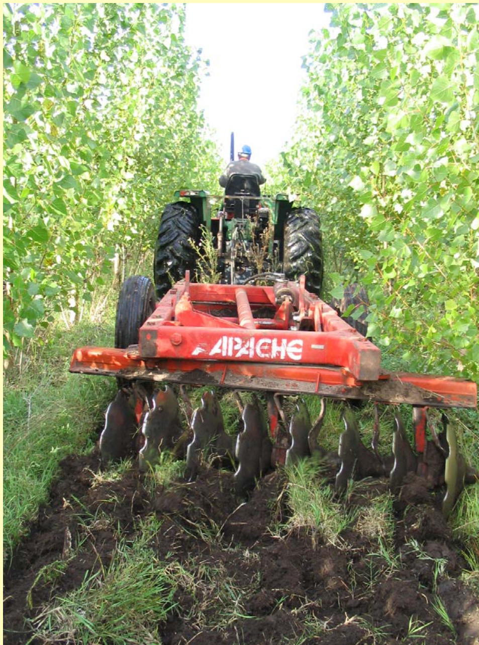
Labranza en la entrefila de una plantación de álamos de dos años de edad con una rastra de discos (primavera tardía)
