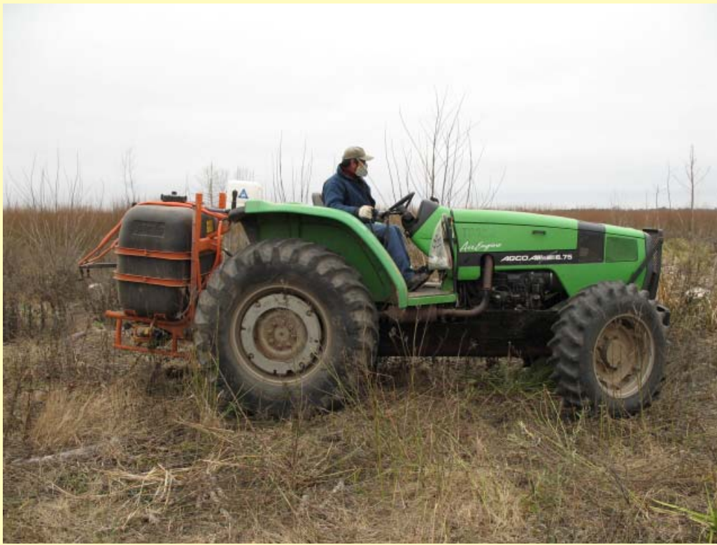
Pulverizadora de 600 l con botalón corto y enganche de tres puntos; aplicación invernal de glifosato + preemergente.
