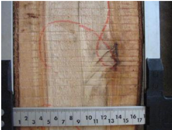
Fotos 5 y 6: Sección longitudinal de rollizos de eucaliptos sin podar (arriba) y podado (abajo) obtenidos de árboles de 5 años, donde se puede ver la generación de madera sin defectos por encima de la poda y el cilindro defectuoso queda reducido a los 12 cm centrales.
