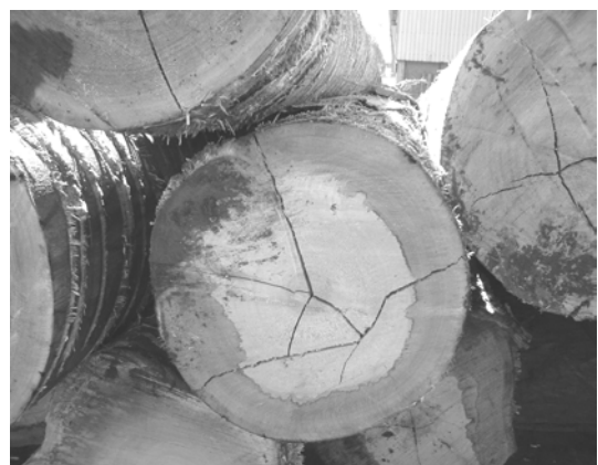
Foto 4. Rajaduras de 24 hs. de apeo.
