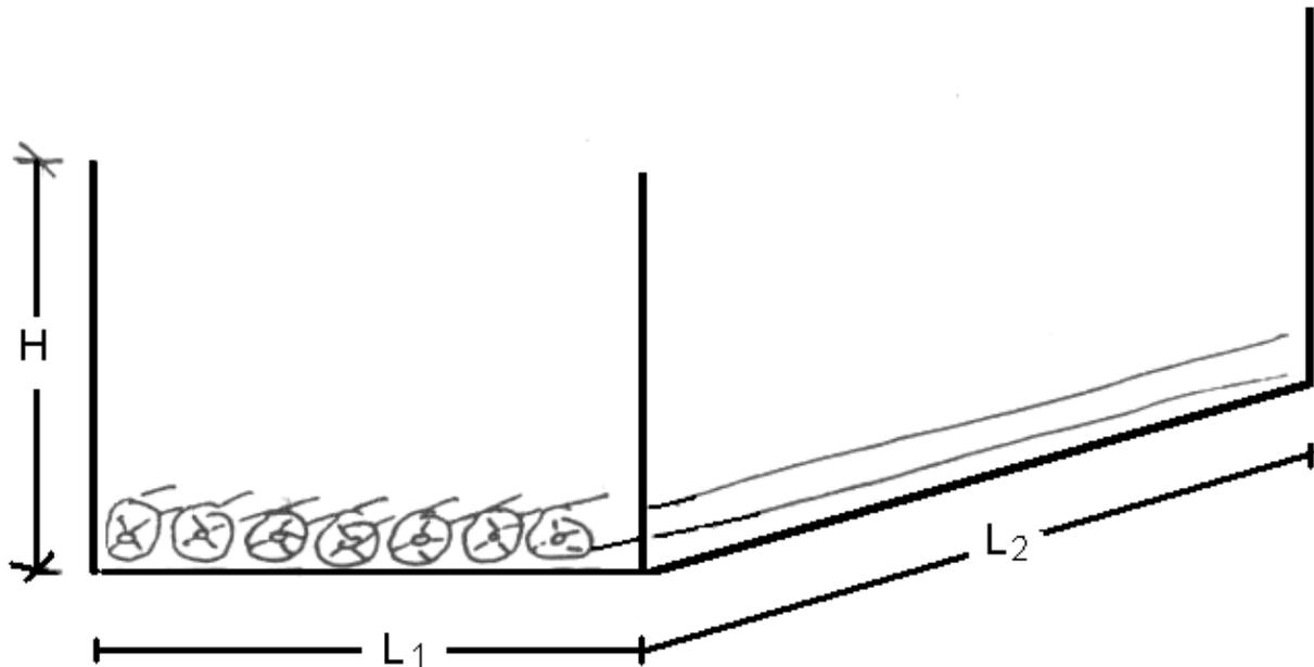
Figura 5.23: Cálculo de volumen de madera apilada
