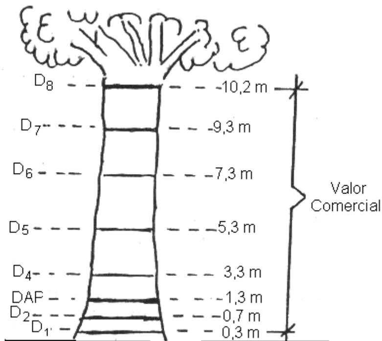
Figura 5.13: Puntos de medición para la cubicación de fustes en bosque natural
