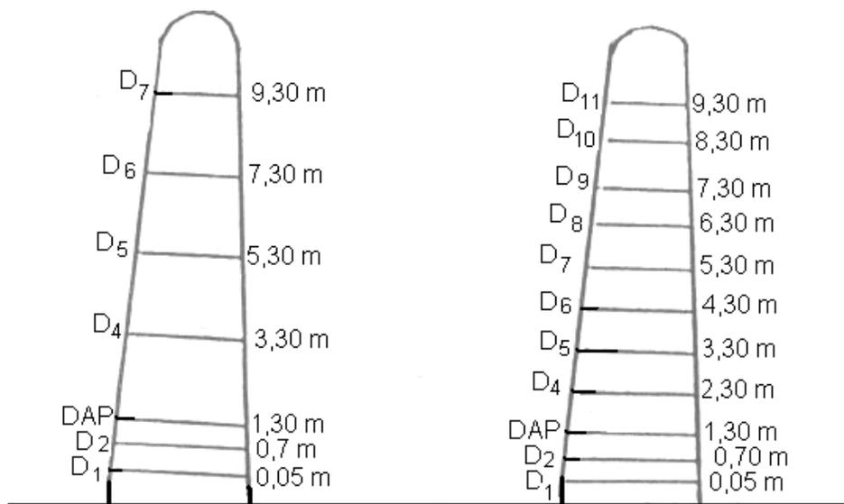
Figura 5.12: Puntos de medición para la cubicación de Pinus por la fórmula de SMALIAN
