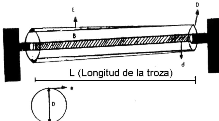
Figura 5.21: Forma de laminar la madera para producir paneles contrachapados
