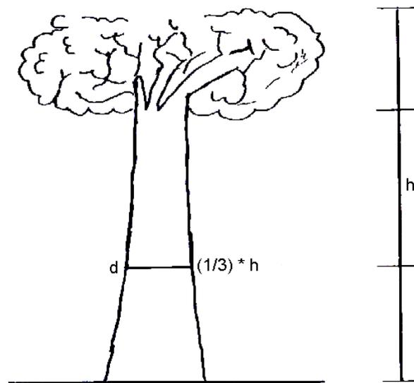
Figura 5.10: Medición del diámetro para calcular volumen por el método de HOSSFELD
