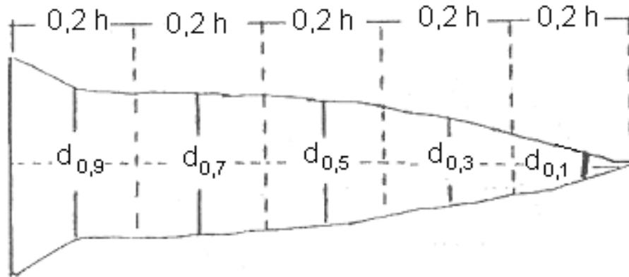
Figura: 5.17: Cubicación rigurosa por el método de HOHENADL
