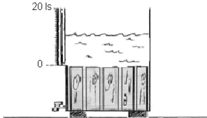
Figura 5.3: Cálculo del volumen por desplazamiento del líquido
