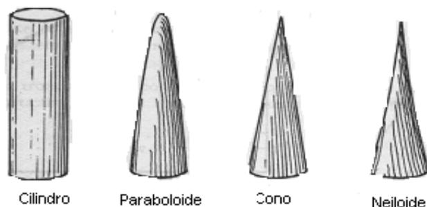
Figura 5.5: Sólidos geométricos o tipos dendrométricos que definen aproximadamente las formas de un árbol
