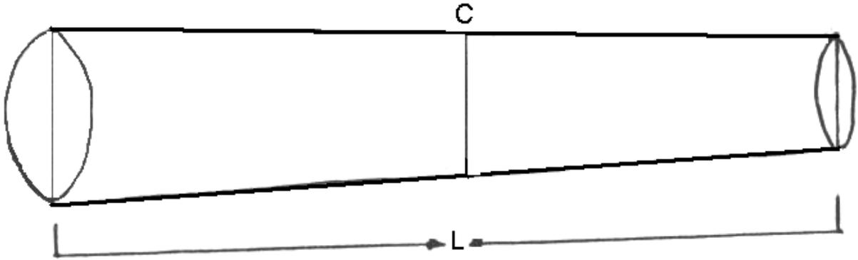
Figura 5.22: Medición del bolo para calcular el volumen 4° reducido
