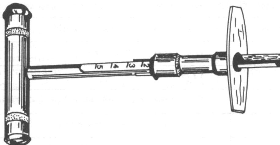
Figura: 5.24: Medidor de grosor de corteza o Sonda Sueca
