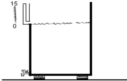
Figura 5.2: Esquema de un xilómetro
