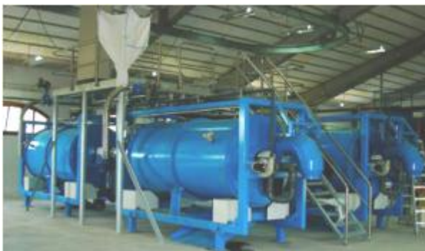
Foto 6. Reactores cilíndrico horizontales estático (izquierda) y rotativo (derecha)
