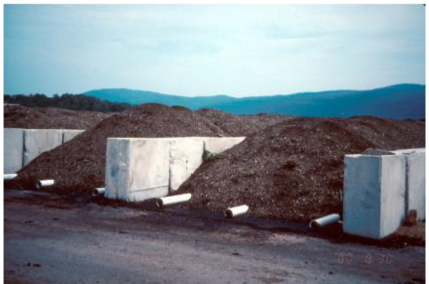
Foto 5. Aireación forzada (izquierda) e inducida (derecha)
