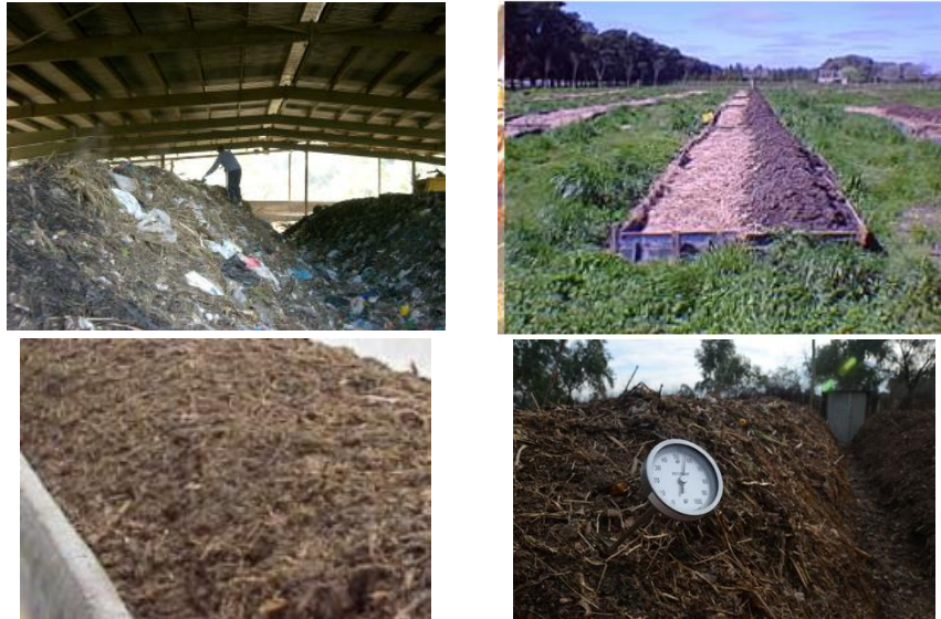
Foto 9. Recepción de material a compostar (arriba izq.), pila a cielo abierto (arriba der. y abajo izq.) y control de temperatura (abajo der.)
