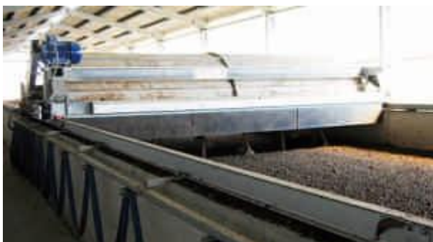
Foto 7. Reactor horizontal con volteadora sobre rieles (izquierda) y embolsadora de compost (derecha)
