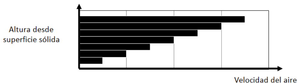
Figura 8. Capa laminar. En ella la velocidad del aire es creciente por encima de la superficie del suelo. Sobre la superficie no hay velocidad del aire por efecto de adherencia del mismo sobre dicha superficie.
