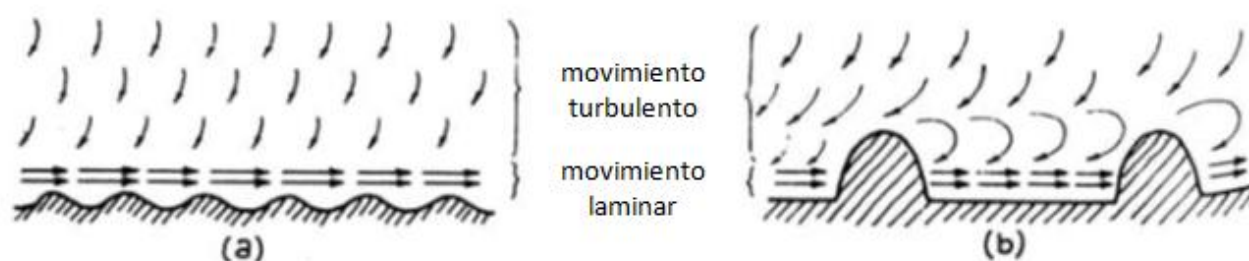
Figura 16. Esquema de la trayectoria del viento sobre una superficie con partículas pequeñas (a) que no sobresalen de la capa de aire laminar y partículas grandes (b) que si lo hacen y quedan sometidas a flujo turbulento (García Salmeron, 1967)
