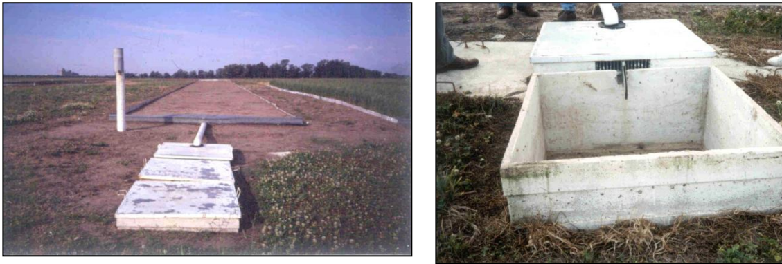
Figura 16. Parcelas para evaluar los parámetros de la USLE. INTA Paraná
