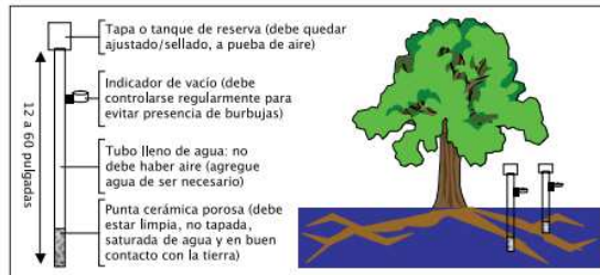
Diagrama de un tensiómetro y de una estación de dos tensiómetros instalados a diferentes profundidades del suelo.
