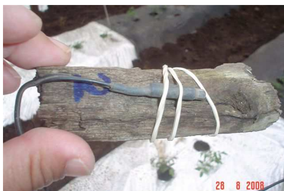
Imagen 2. Sensor de platino dispuesto para asegurar su ubicación horizontal en el suelo
