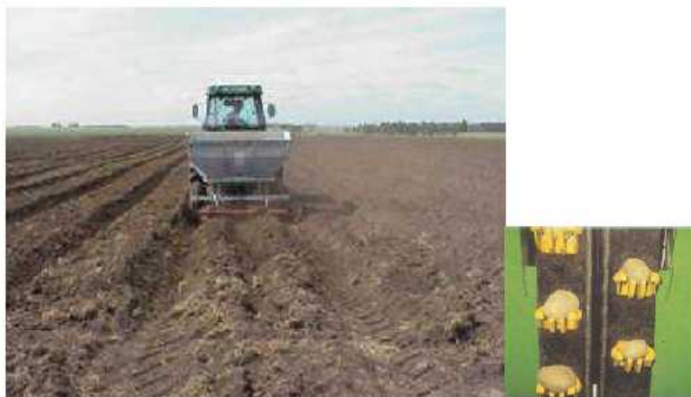
Figura 4 Plantación de papa en el SF Pcia de Buenos Aires y detalle de cangilones
