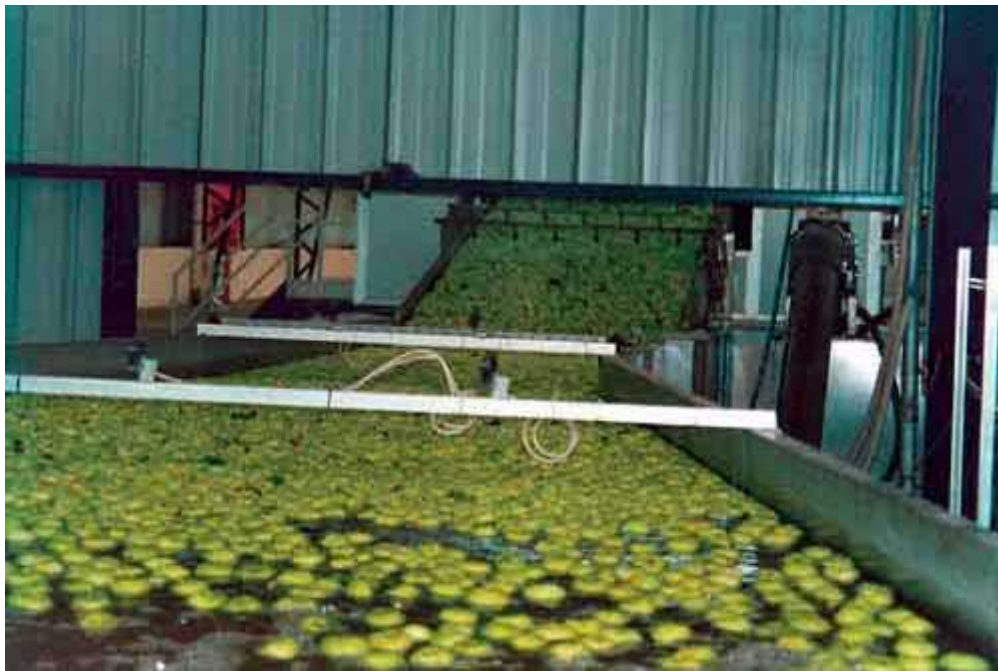
Figura 13: enfriamiento por inundación. Fuente FAO
