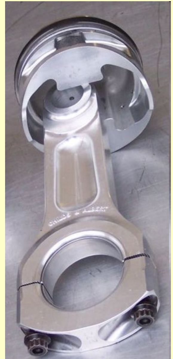
Biela: acero forjado en prensa
