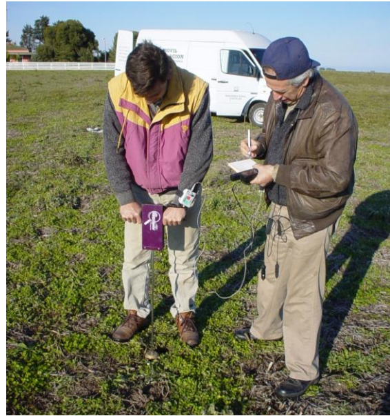
Figura XI.12: mediciones de resistencia a la penetración en ensayos de cubiertas a campo
