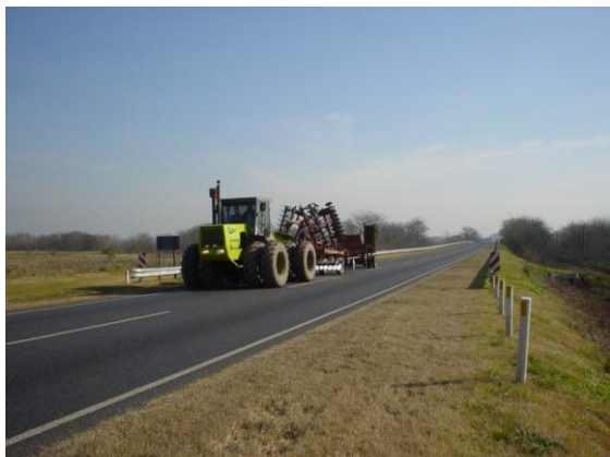
Figura XI.17: la circulación en ruta implica desgastes prematuros y desaparejos en las cubiertas
