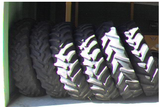
Figura XI.16: diseños con diferentes angulaciones de tacos en cubiertas traseras de tracción
