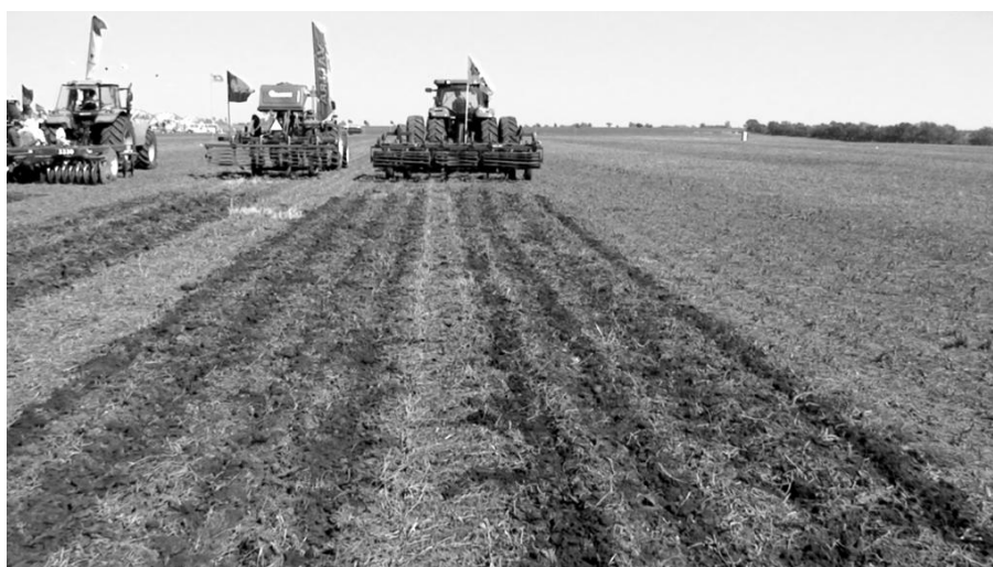
Figura 83. Trabajo realizado por un descompactador de brazos angulados y rolos desterronadores sobre rastrojo de soja
