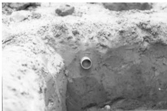
Figura 70. Determinación de densidad con cilindros
