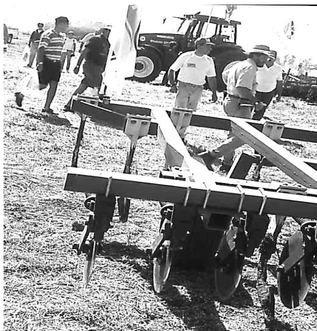
Figura 88. Escarificador de montantes rígidos con cuchillas individuales en la línea de acción de las rejas dispuestas en la parte delantera del bastidor
