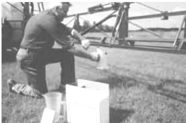
Figura 66. Evaluación del caudal erogado por las pastillas
