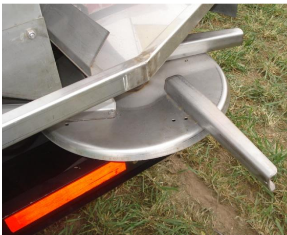
Figura 55. Modificación de la posición de las paletas en forma discontinua.
