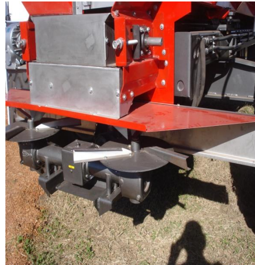
Figura 49. Fertilizadora centrífuga bidisco. Figura 50. Detalle de los platos giratorios
