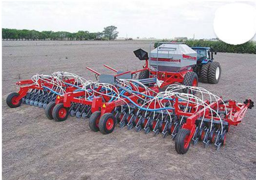
Figura 60. Sembradora Fertilizadora con transporte neumático (diseño air drill)
