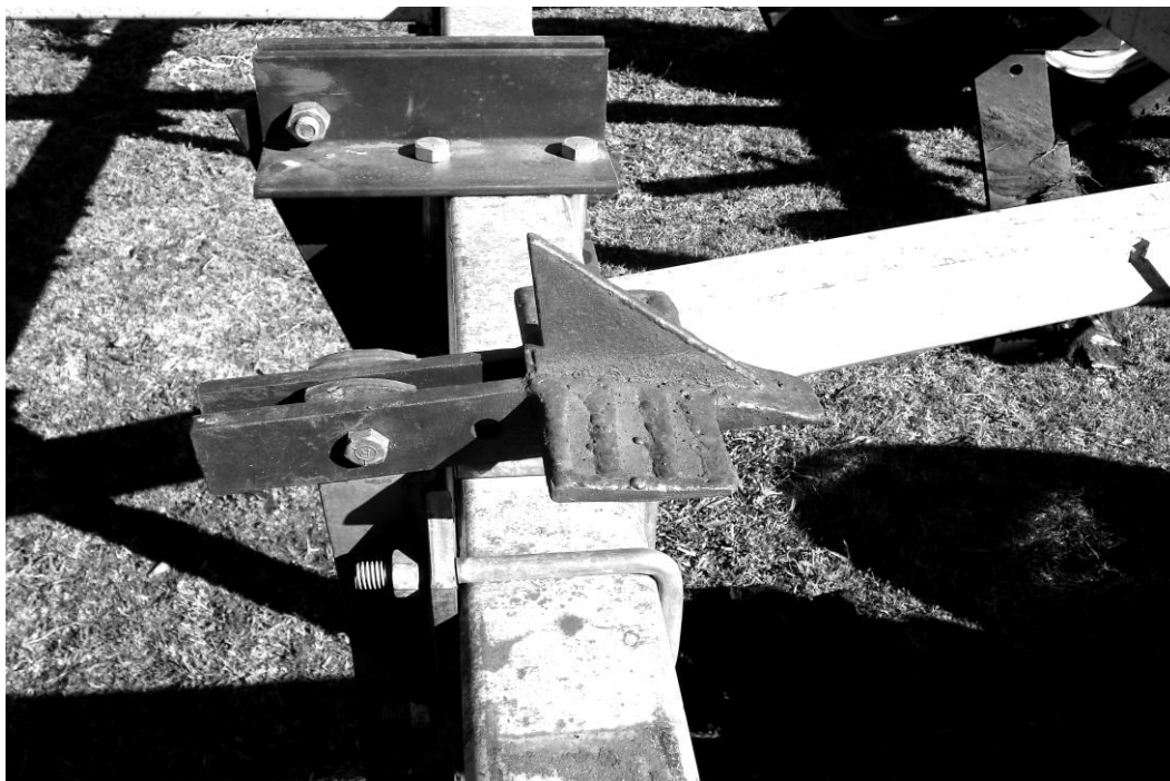
Figura 82. Rejas aladas con refuerzos estructurales y cresta central
