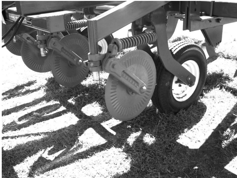
Figura 89. Cuchillas circulares onduladas de filo liso, de montaje individual en la parte delantera de un descompactador de montantes angulados lateralmente y lámina curva
