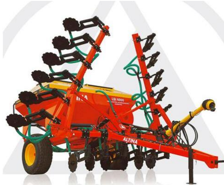
Figura 59. Fertilizadora neumática con mecanismos para la incorporación del fertilizante
