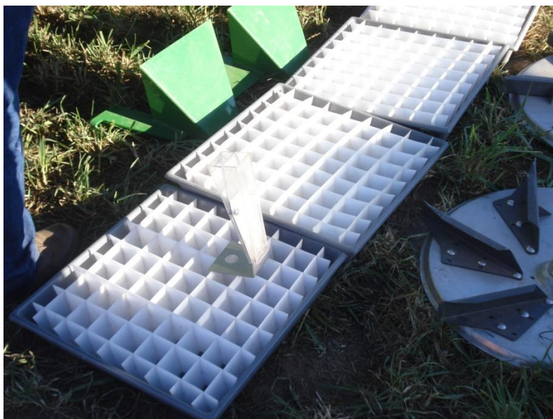
Figura 65. Vista de las cajas normalizadas para la recolección del material con los elementos para impedir el rebote y pérdida de fertilizante
