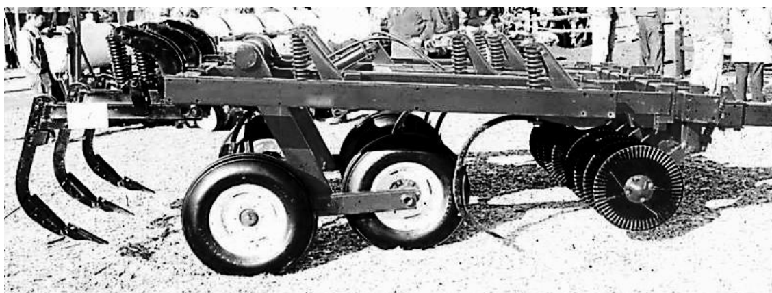
Figura 78. Escarificador combinado con cuchillas circulares, cinceles de arcos flexibles y descompactadores rígidos
