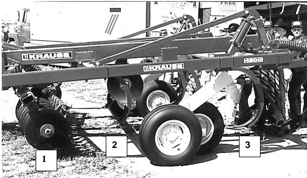
Figura 80. Escarificador combinado de rastras de disco desencontrada (1), cinceles y rejas convencionales superficiales (2) y descompactadores rígidos con rejas convencionales (3)
