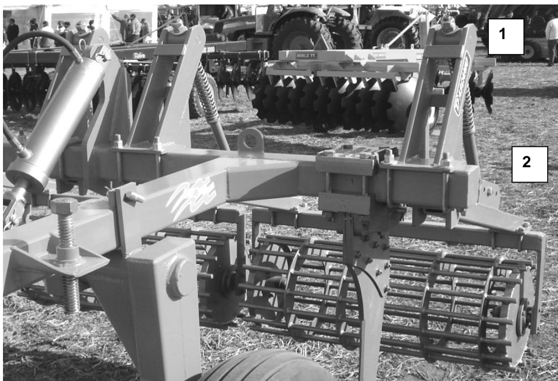
Figura 84. Detalle de los rolos complementarios de un descompactador y la regulación de los mismos. 1) Regulación de la tensión; 2) Regulación de la posición
