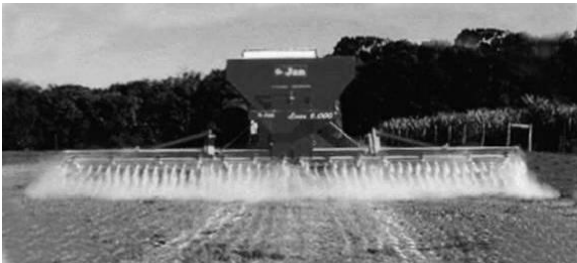
Figura 48. Aplicadora de enmiendas con botalón a tornillo sinfín
