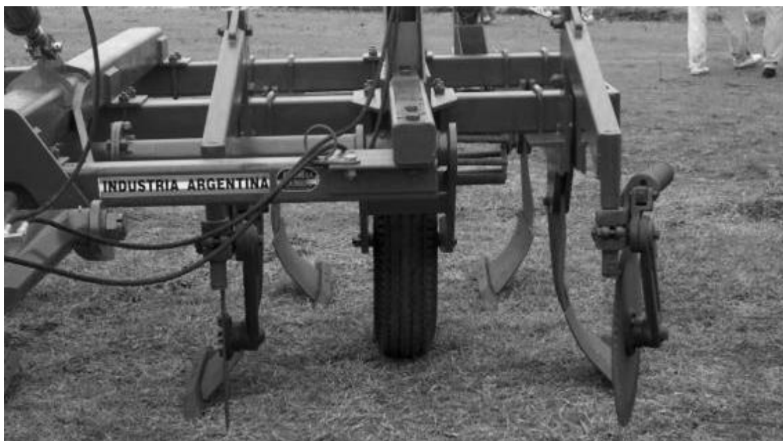
Figura 85. Descompactador de montantes angulados curvos y configuración por pares hacia el centro.
