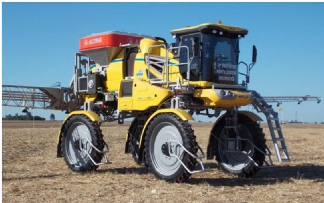
Figura 61. fertilizadora con asistencia neumática con botalón y difusores.
