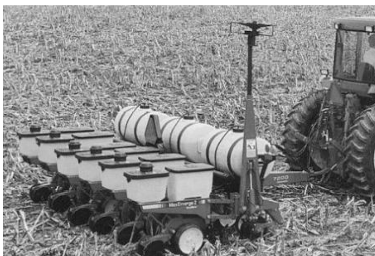
Figura 62. Sembradora con aplicación de fertilizante sólido y líquido
