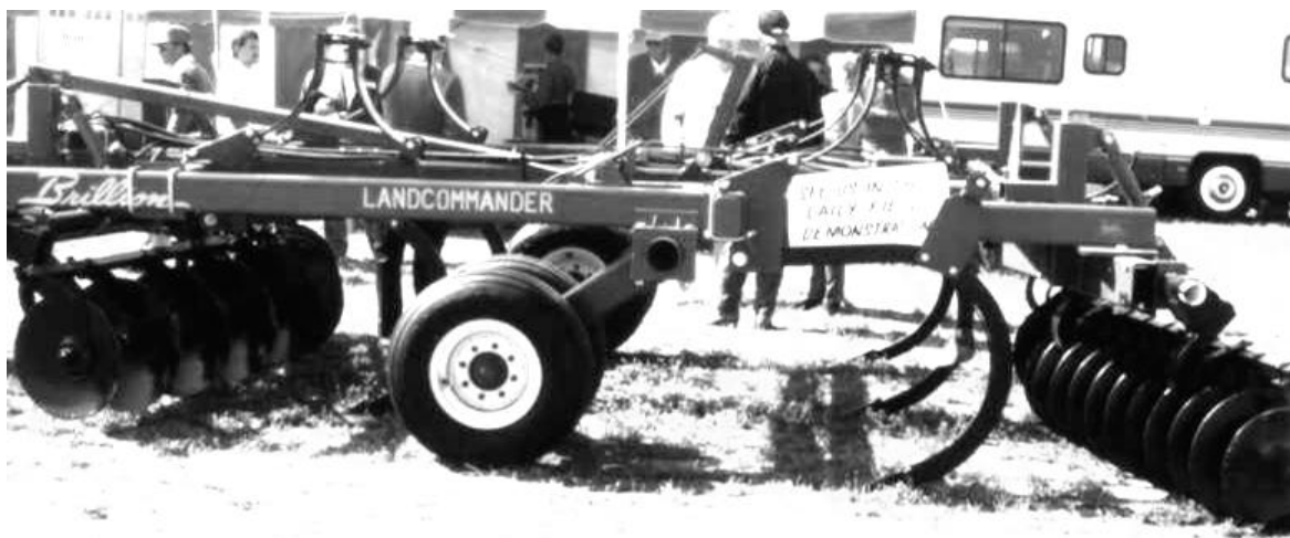
Figura 79. Descompactador de montantes rígidos combinado con paquetes de discos delanteros y traseros
