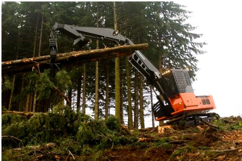
Figura 6: Shovel Logger realizando remoção de madeira em áreas de declividade.
