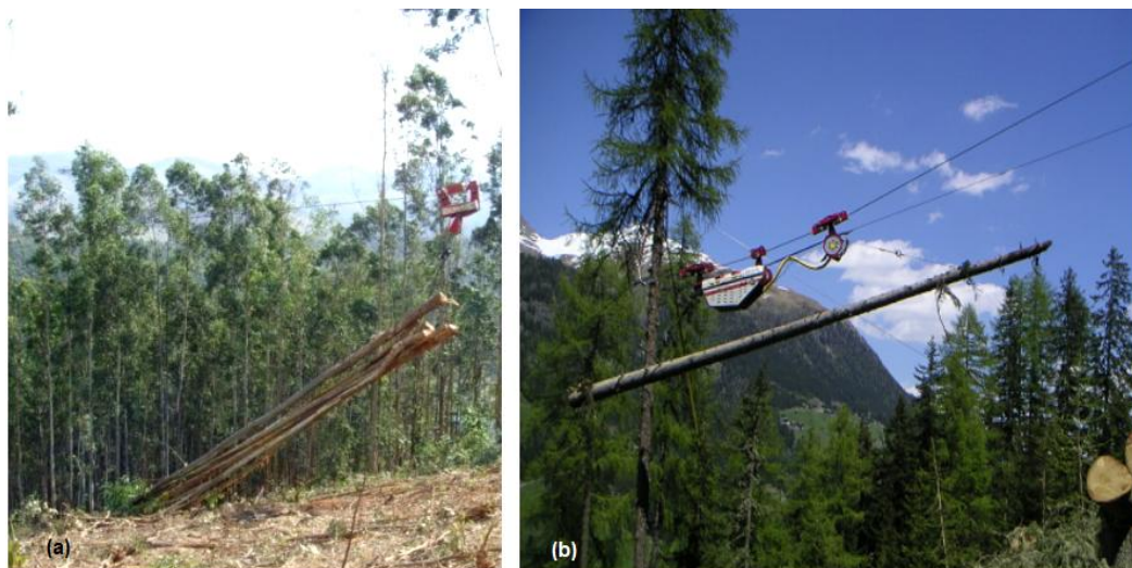
Figura 54: Exemplos de cabos por arraste (a) e cabos aéreos (b).
