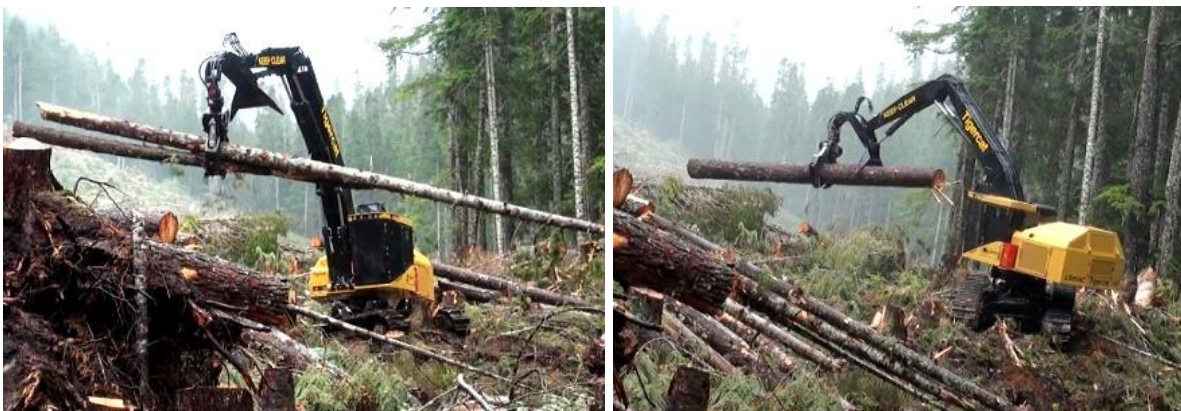
Figura 47: Shovel Logger Tigercat LS855C operando em terreno íngreme.
