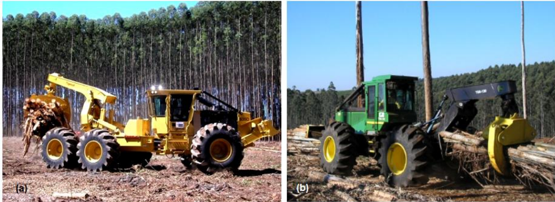
Figura 7: Skidder do tipo 6x6 (a) e 4x4 (b) realizando o arraste.
