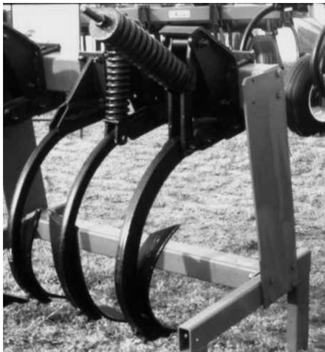
Figura 11: Rejas “rastrojeras” o helicoidales de distinto tamaño y disposición colocadas sobre montantes rígidos y flexibles
