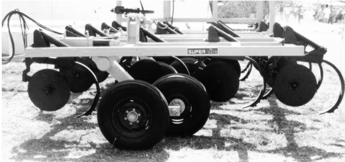
Fig. 22. Vista lateral de un escarificador de cincel, con cuchillas lisas tomadas en forma individual por delante del arco
