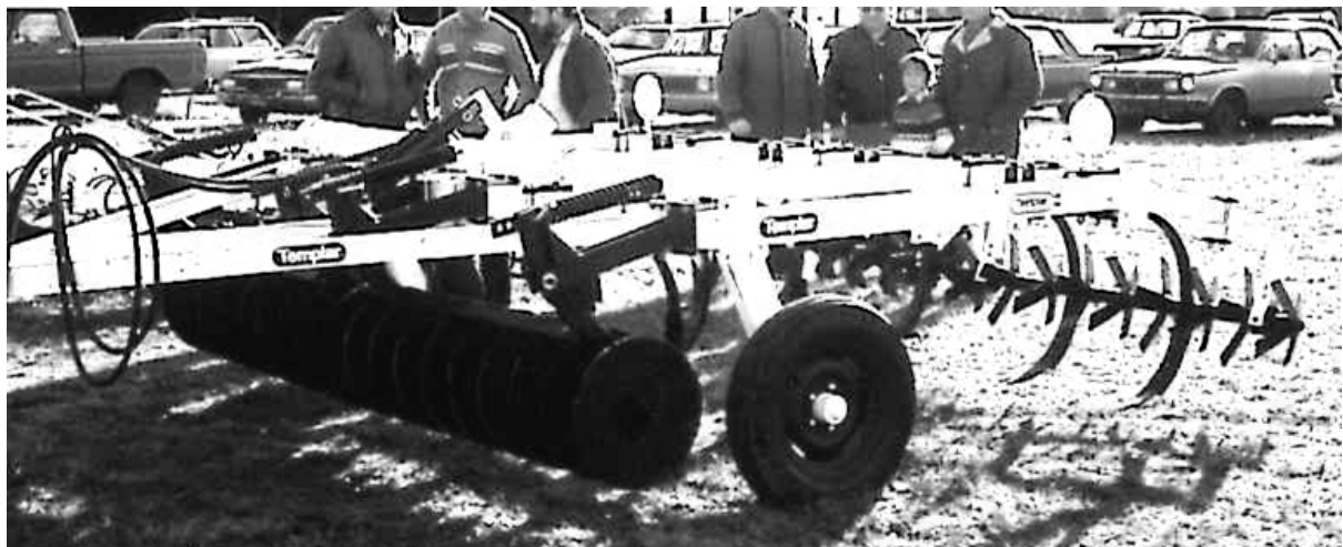
Figura 27. Cincel de arcos flexibles con paquete de cuchillas delanteras y mecanismos posteriores para el sellado de la labor y semi enterrado de residuos
