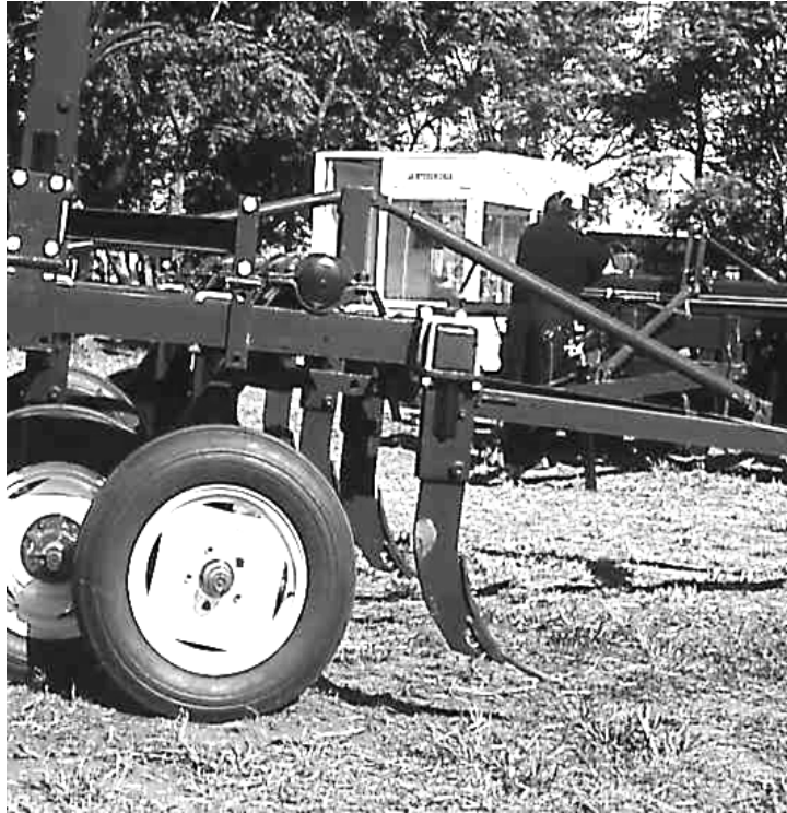
Figura 16. Vista lateral de un escarificador rígido con elevado ángulo de ataque del montante en relación con el ángulo de la reja.
