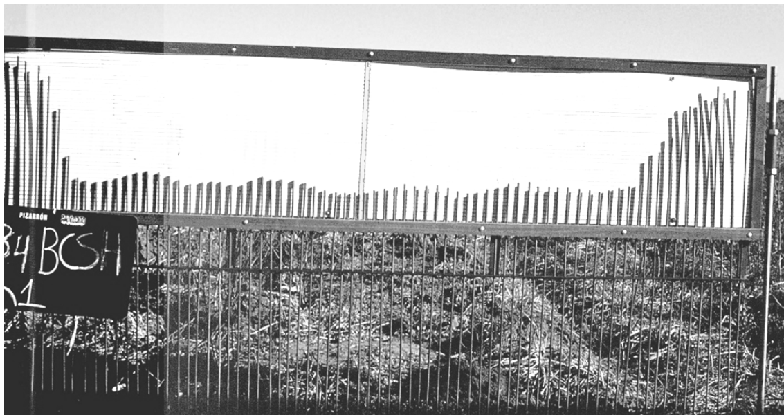
Figura 29 Fotografía de un perfilómetro de varillas correspondiente a la evaluación del trabajo de un descompactador de montantes angulados laterales tipo Paratill.
