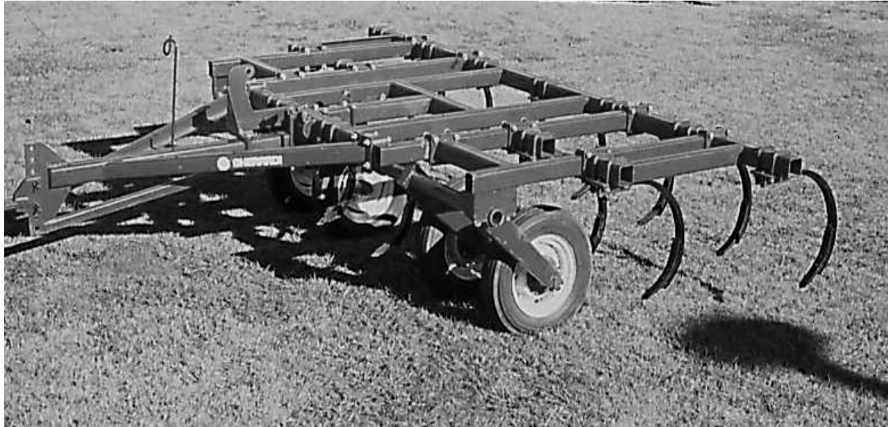
Fig. 17. Vista de la estructura del bastidor y características de distribución de los arcos en los primeros cinceles fabricados en el país
