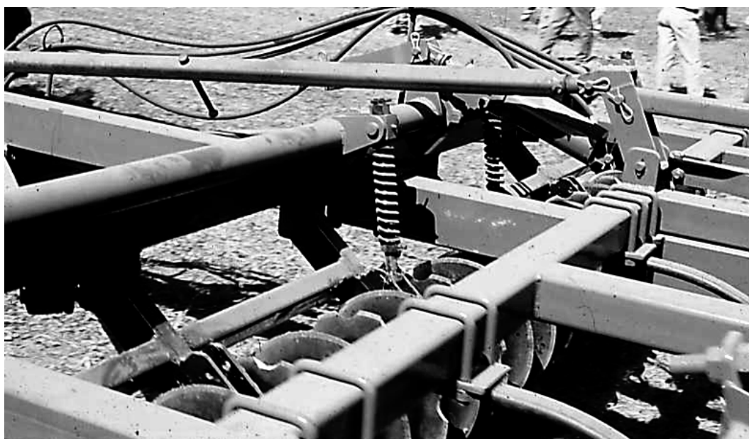
Figura 24. Cuchillas circulares lisas de borde entero y recortado alternadas, tomadas en conjunto en la parte delantera de un cinzel, con registro de tensión por sectores
