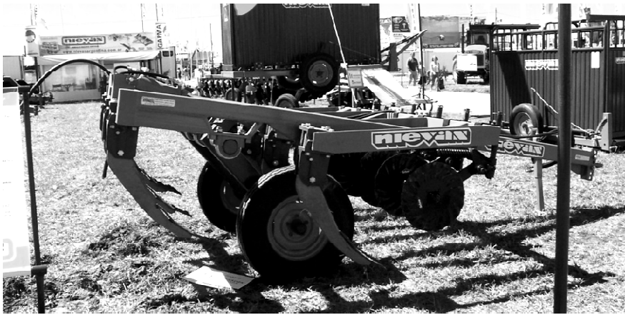
Figura 15. Vista lateral de un escarificador rígido con bajo ángulo de ataque tanto en la reja como en el montante.
