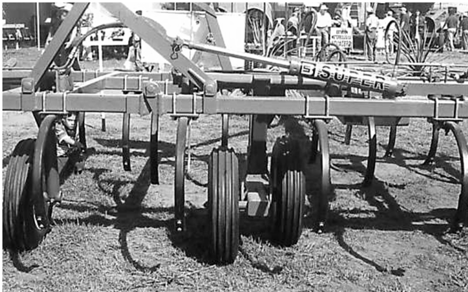
Figura 18 vista posterior de un escarificador de cinceles de arcos flexibles, donde se destaca la separación entre arcos y planos de acción.
