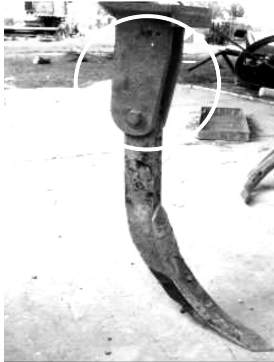
Figura 7: arco rígido y reja convencional con perno fusible y tres posibilidades de modificación del ángulo de ataque
