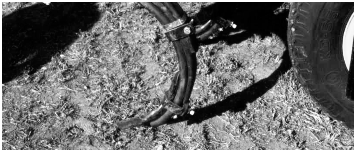
Fig. 4. Arco de escarificador flexible con 2 sobreactos de refuerzo para lograr mayor rigidez al conjunto.
