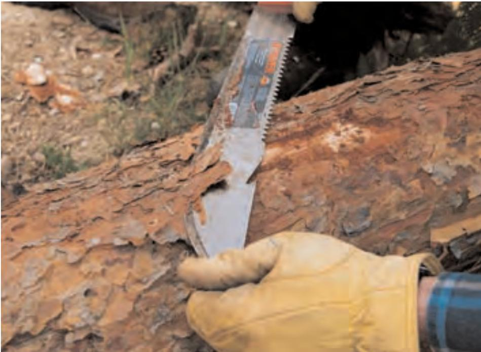
Fig. 20. Descortezamiento con cuchillo de una troza de pino silvestre.
