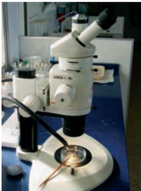
Fig. 27. Microscopio estereoscópico (lupa binocular).
