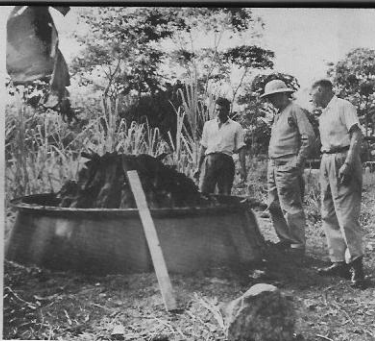
Procedimientos antiguos y modernos para hacer carbón. Con el borno, a la derecha, en terrenos del Instituto Interamericano de Ciencias Agrícolas, se ahorra de 2 a 3 veces más de tiempo; el rendimiento es aproximadamente el doble y se economiza mucha mano de obra.
