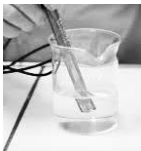
Figura 6- Peachímetro sumergido en una solución para medir el pH. El bulbo de vidrio queda sumergido en la solución. El lado interno de la membrana de vidrio tiene una solución de HCl 0,1 M y el lado externo de la membrana está en contacto con la concentración de protones es la de la solución del vaso.
