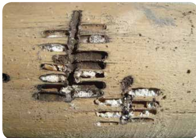
Cilindro central del debobinado con galerías de Megaplatypus mutatus (Neuquén 2011). Autor Natalia Acosta.
