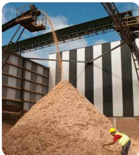
Cinta transportadora volcando chips en el sector de acopio. Autor Pablo Oliveri, gentileza UCAR-MAGyP.
