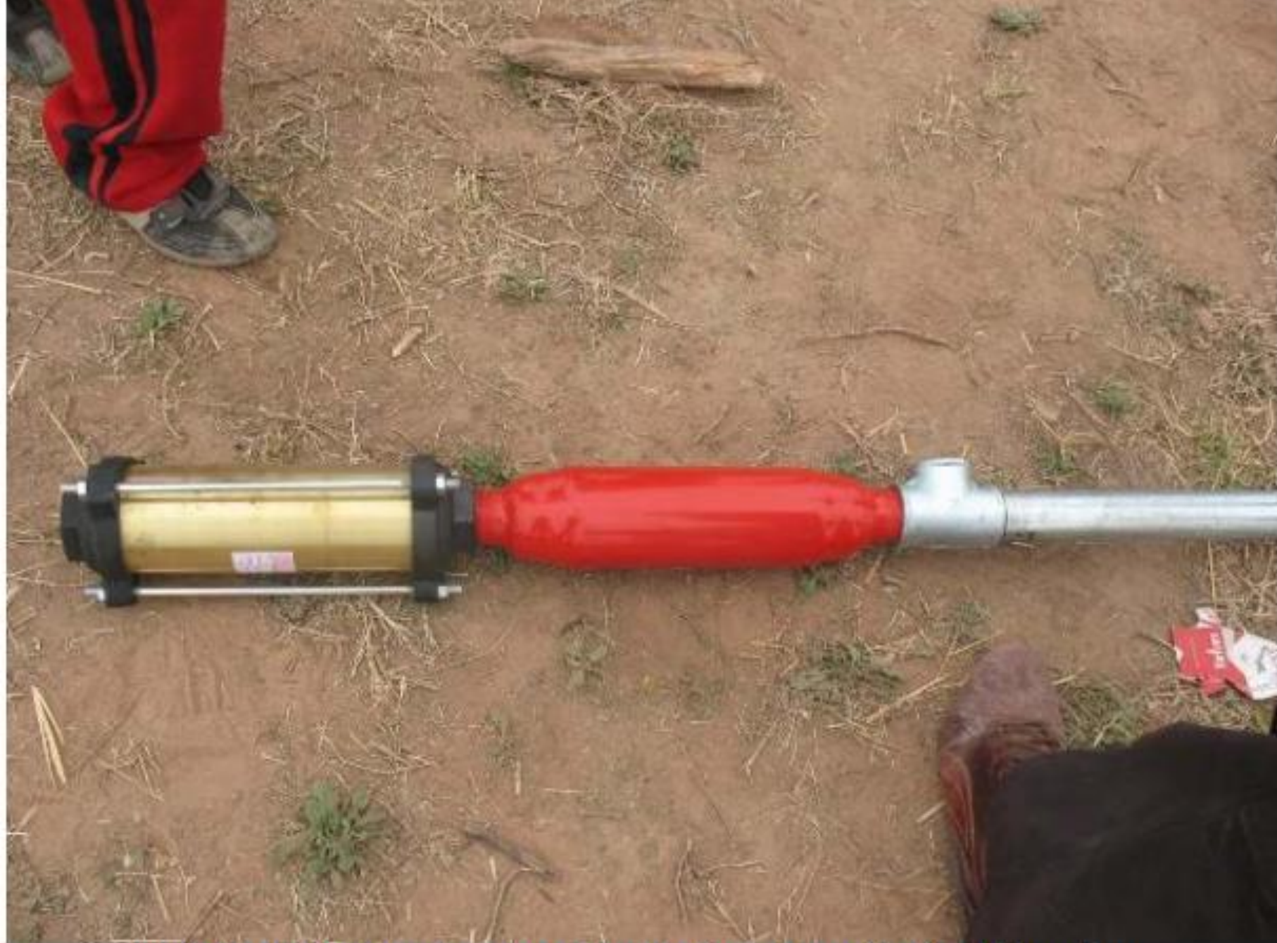
Detalle de la bomba con el pulmón y la cañería del molino.
