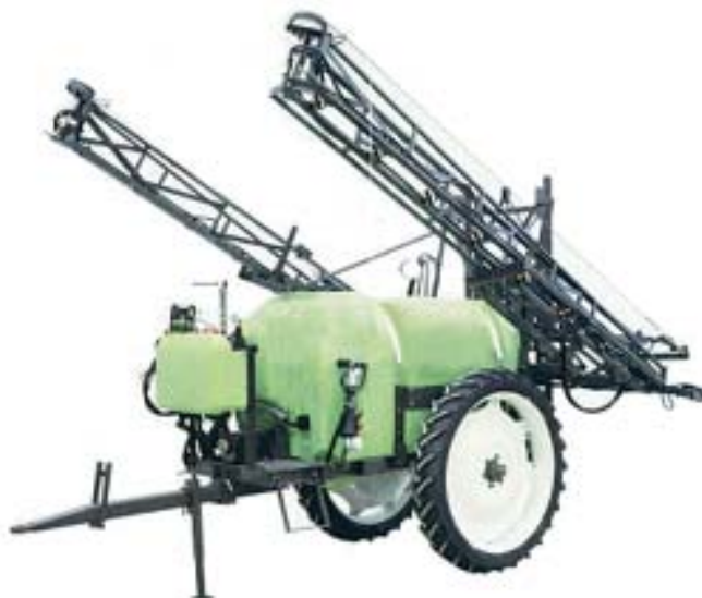
FIGURA IV.42: Plegado del botalón para el transporte de la máquina
