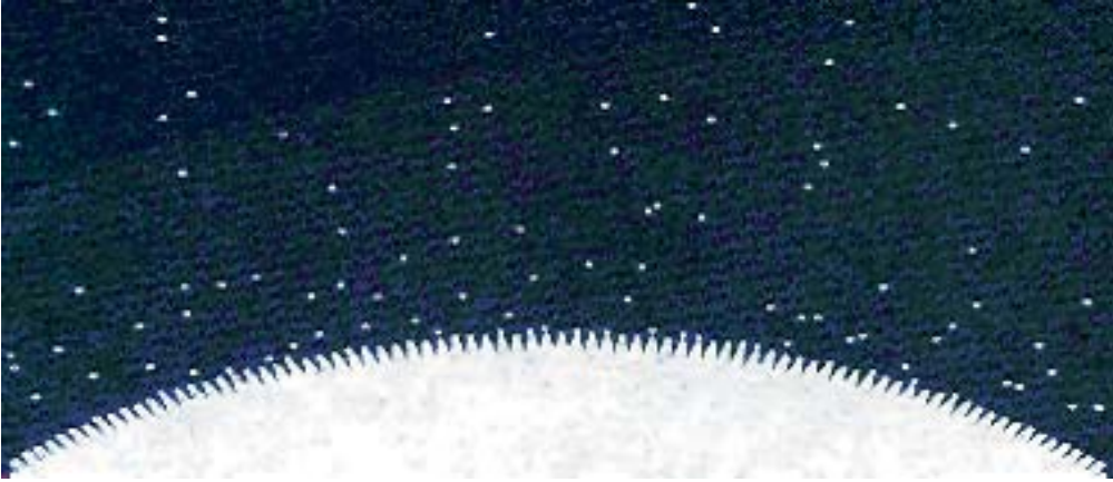
FIGURA III 32: Formación de gotas en un cabezal pulverizador rotativo
