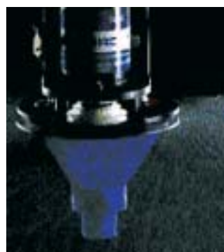
FIGURA III 32: Cabezal pulverizador rotativo
