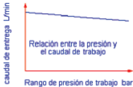
FIGURA IV.19: Gráfico del caudal en función de la presión del sistema, para una bomba de desplazamiento positivo.
