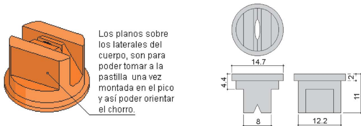
FIGURA III.6: Forma y dimensiones (en mm) de una pastilla de abanico plano
