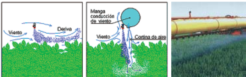
FIGURA IV.49: Representación esquemática del efecto del túnel de viento y vista del sistema.
