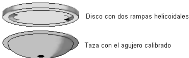
FIGURA III 24: Taza con orificio calibrado y disco o núcleo de turbulencia
