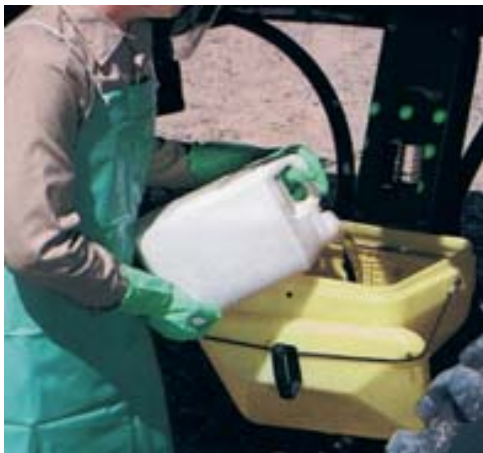
FIGURA IV.6: Dispositivo de carga de plaguicidas
