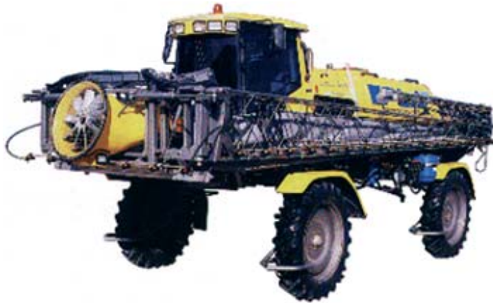
FIGURA IV.48: Máquina pulverizadora autopropulsada con botalón delantero plegado y túnel de viento incorporado
