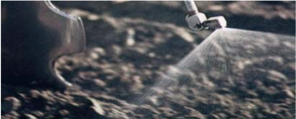
FIGURA III 29: Incorporación de herbicida con pastillas Gran Angular, montada sobre una rastra de disco
