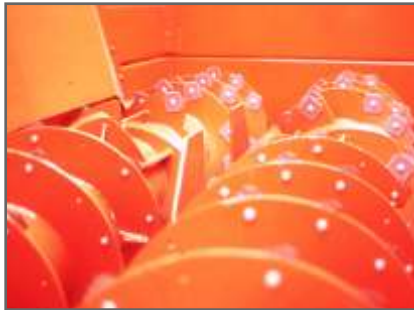
Figura 2.21. Dos sinfines horizontales con cuchillas periféricas.
