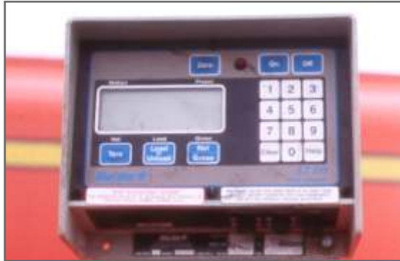
Figura 2.1. Las balanzas facilitan el control de carga y descarga mejorando el nivel de eficiencia en la alimentación.
