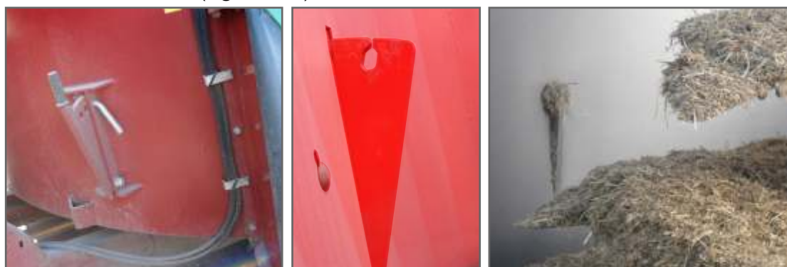
Figura 2.12. Exterior e interior de los frenos que determinan el grado de cortado o desmenzado de la fibra incorporada a la ración.
