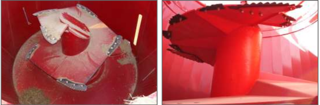
Figura 2.18. Vistas de sinfines de mezclado y corte de fibra de mixers verticales.
