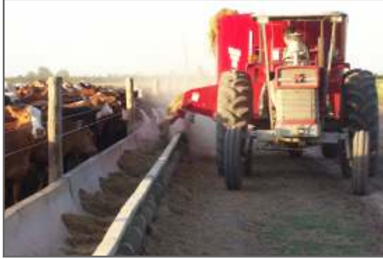
Figura 2.3. Cuando los lugares de descarga tienen altura constante no ofrecen mayores dificultades.
