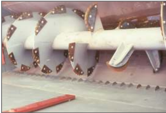
Figura 2.23. Sistema de un sinfín con cuchillas y barra batidora central.
