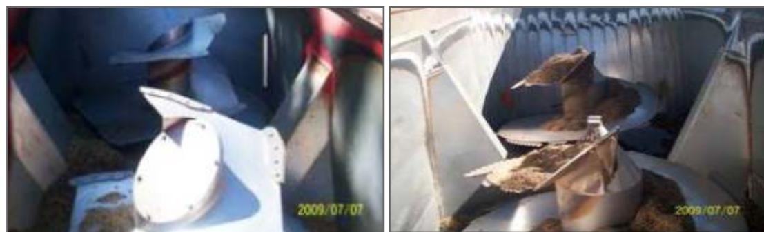
Figura 3.2. Mixers utilizados, detalles de tolvas y sinfines. Izquierda: Mixer "J" y derecha: Mixer "X".
