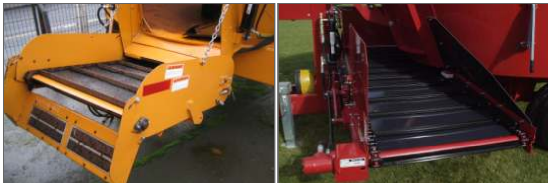
Figura 2.6. Sistema de descarga, de noria con barras y cadenas.
