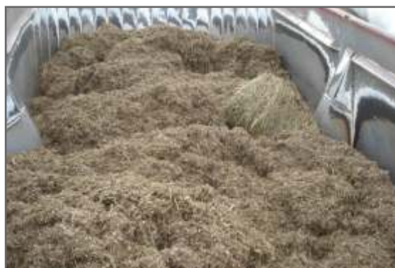
Figura 3.6. Se observa un núcleo de rollo que aún cuando se termina el proceso de mezclado, no llega a desmenuzarse ni integrarse en la mezcla realizada por el mixer testigo "X".
