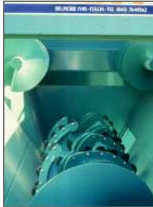
Figura 2.24. Vista del sinfín inferior trozador mezclador y de los dos sinfines cortos superiores.
