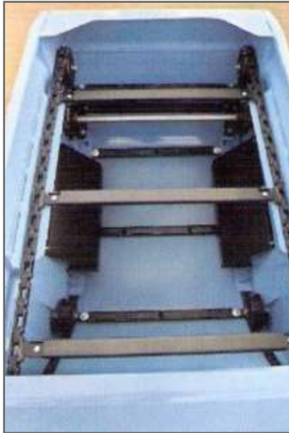
Figura 2.29. Sistema mezclador por rastra giratoria periférica.
