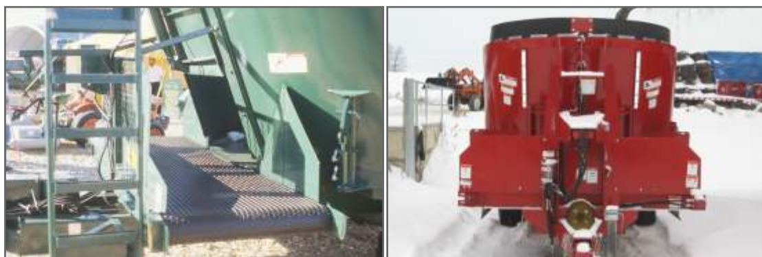
Figura 2.7. Sistema de descarga frontal con cinta de caucho que permite entregar el forraje a ambos lados del acoplado.
