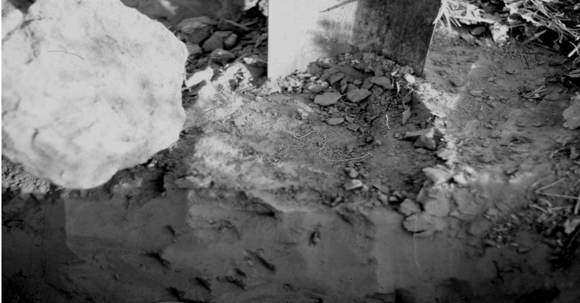
Foto 2: Capa densificada de la situación de Alta Compactación.
