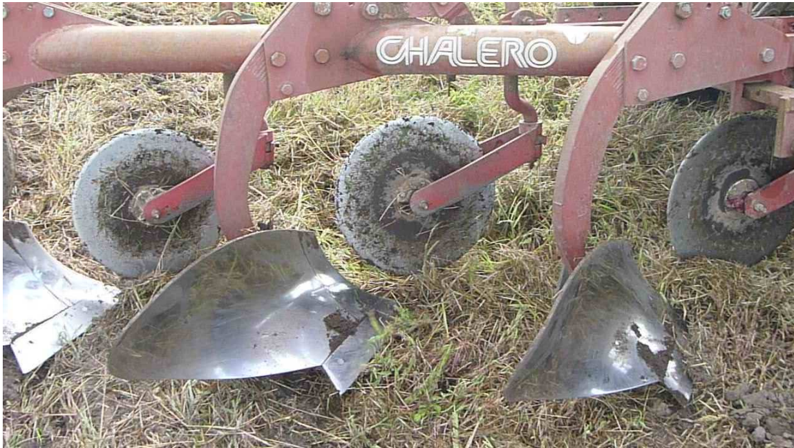
Foto 4. Vista lateral de un arado de reja y vertedera.
