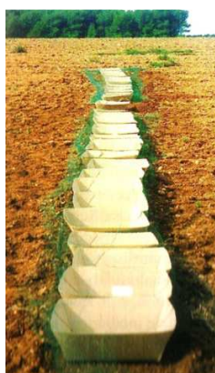
Figura 7: Colocación de cajas para determinar el ancho de trabajo. Debe dejarse lugar para el pasaje de las ruedas del tractor y de la fertilizadora.
