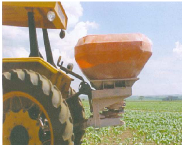
Figura 2: Fertilizadora montada. Debe verificarse la altura del dosificador (se trabaja en control de posición) y la nivelación anteroposterior y transversal
