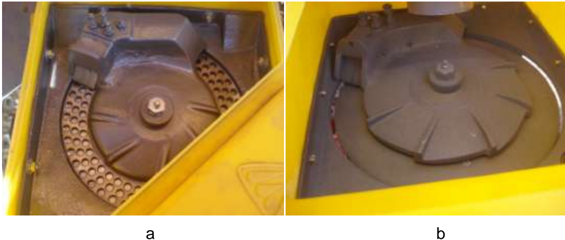
Figura 4. a) Tolva con placa semillera con 3 hileras de alveolos, conjunto enrasador de 3 elementos y conjunto de elementos de regulación de la caja de gatillos. b). Placa interruptora (cabezal o cono portagatillos), con visualización de la contraplaca y sus mecanismos de fijación, gatillos enrasadores y sistema de regulación del enrase y la expulsión de la semilla.
