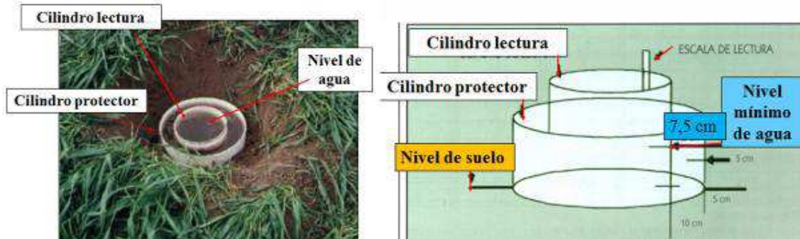
Figura 3 Permeámetro de doble anillo para medir velocidad de infiltración e infiltración básica
