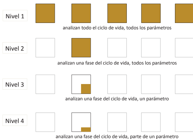
Figura 12. Esquema de los sistemas de certificación ambiental de edificios, según abarcan más o menos el ciclo de vida (Societat Orgànica, 2012).
