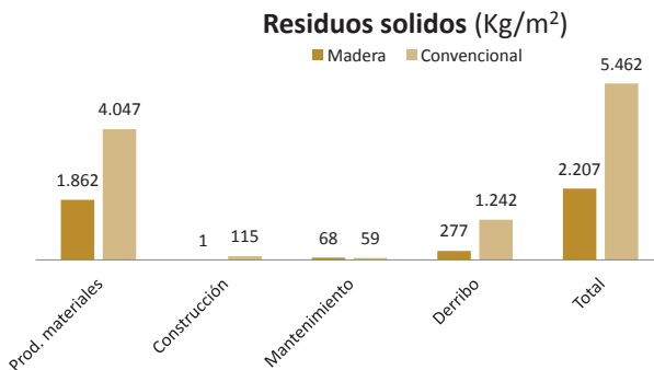
Figura 10. Construcción en madera vs tradicional. Residuos sólidos generados en el ciclo de vida (kg/m 2 ) ( La sostenibilidad en la construcción industrializada . Tesis, Wadel, 2009).
