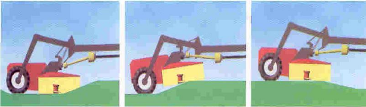
Sistema de siega-acondicionado flotante, que permite seguir las irregularidades del terreno.
