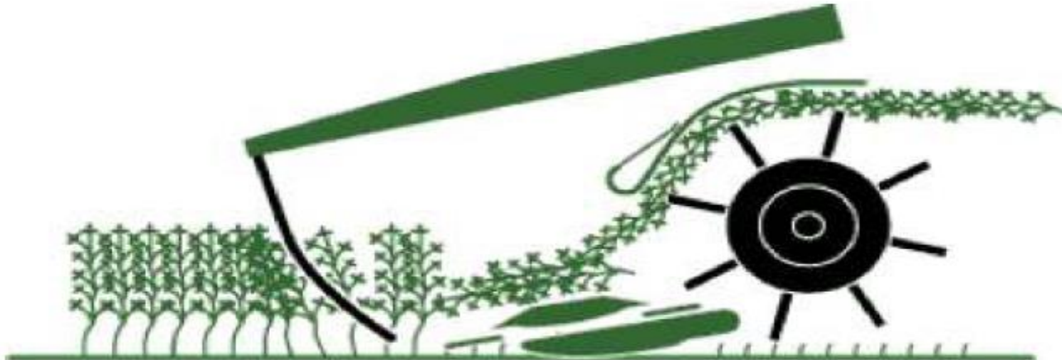
Figura 4.43. Esquema de trabajo de un acondicionador de dedos o impeller.
