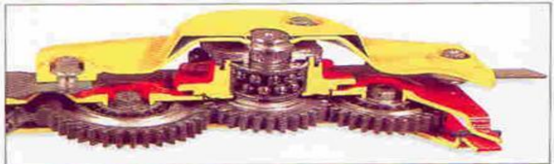
Segadora de discos ovalados. Detalle de la fijación del disco y de su sistema de accionamiento.
