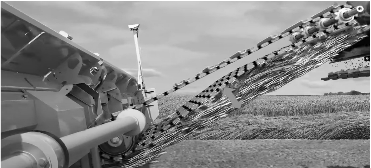
Fig. 76 El uso de sensores de flujo en el acarreador permite ajustar el tiempo de respuesta del sistema.
