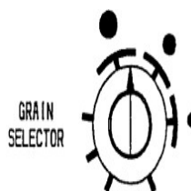
Fig. 74 Diferentes tamaños de grano generan diferentes intensidades de señal en los sensores, por lo que se debe indicar el tipo de grano a cosechar. Por ejemplo en la figura se selecciona el punto grande para maíz y porotos, el punto mediano para trigo y cebada y el punto pequeño para trébol, alfalfa o colza.
