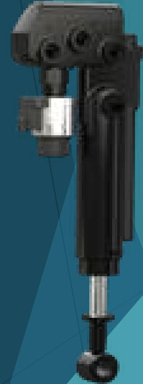
DeltaForce reemplaza los resortes o pulmones de aire en su sembradora actual con cilindros hidráulicos y celdas de carga que miden la cantidad de peso que se ejerce en las ruedas limitadoras de profundidad de cada surco y lo mantienen constante.
