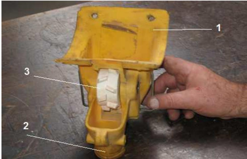
**Figura 5. Dosificador tipo Chevron (Referencias: 1 carcasa; 2 orificio de descarga; 3 rodillo).**
