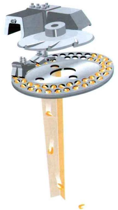
**10: Detalle de placa horizontal hileras de alvéolos.**
