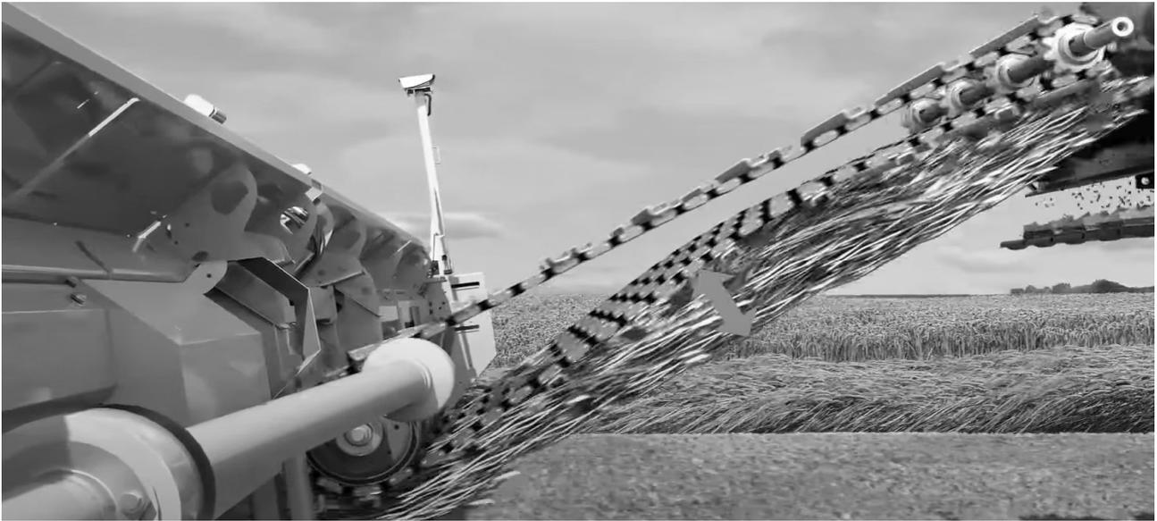
Fig. 72 El uso de sensores de flujo en el acarreador permite ajustar el tiempo de respuesta del sistema.
