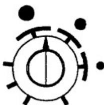
Fig. 70 Diferentes tamaños de grano generan diferentes intensidades de señal en los sensores, por lo que se debe indicar el tipo de grano a cosechar. Por ejemplo en la figura se selecciona el punto grande para maíz y porotos, el punto mediano para trigo y cebada y el punto pequeño para trébol, alfalfa o colza.
