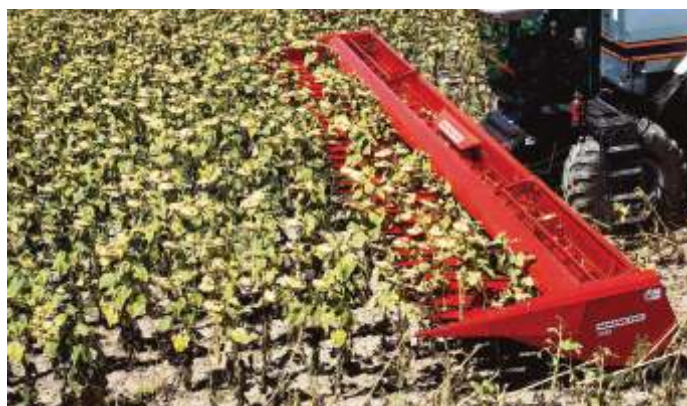
Figura 4. Vista de un cabezal girasolero trabajando. La función es separar los capítulos de la planta, con la menor cantidad de tallos posibles.
