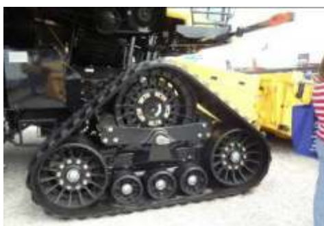
Figuras 23: Cosechadoras con orugas de caucho de buena prestación para disminuir la compactación y el huellado característico que producen los neumáticos tradicionales.
