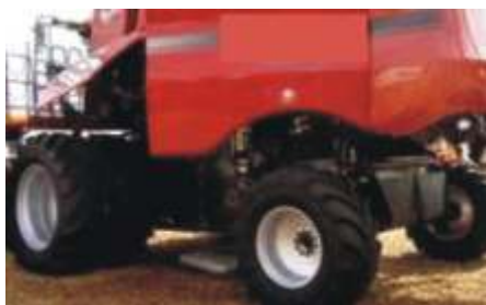
Figuras 21: Cosechadoras y tolvas equipadas con neumáticos radiales de alta flotabilidad y buen ancho.
