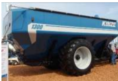
Figuras 21: Cosechadoras y tolvas equipadas con neumáticos radiales de alta flotabilidad y buen ancho.
