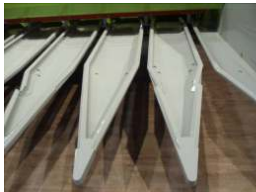
Figura 11: Cabezal de última generación con bandejas con extremos agudos y bordes redondeados.
