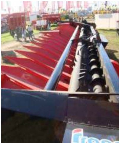
Figura 13: Cabezal girasolero con sistema de tambor giratorio.
