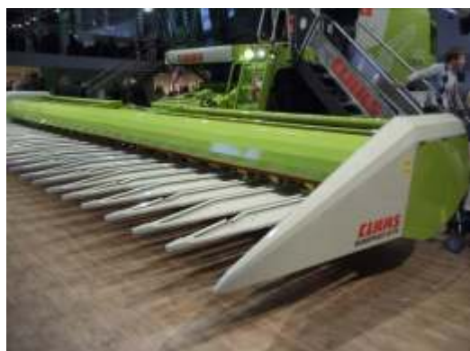
Figura 11: Cabezal de última generación con bandejas con extremos agudos y bordes redondeados.
