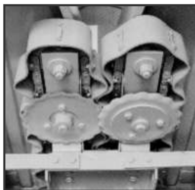
Figura 9. Detalle de los discos de corte autoafilables de alta duración.
