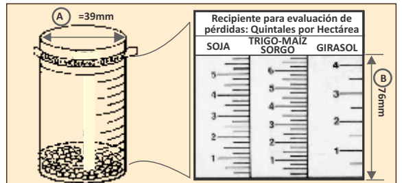
Figura 5. Recipiente evaluador de pérdidas de cosecha. Los números en la graduación representan en forma directa, los qq/ha perdidos. INTA PRECOP 2007.
