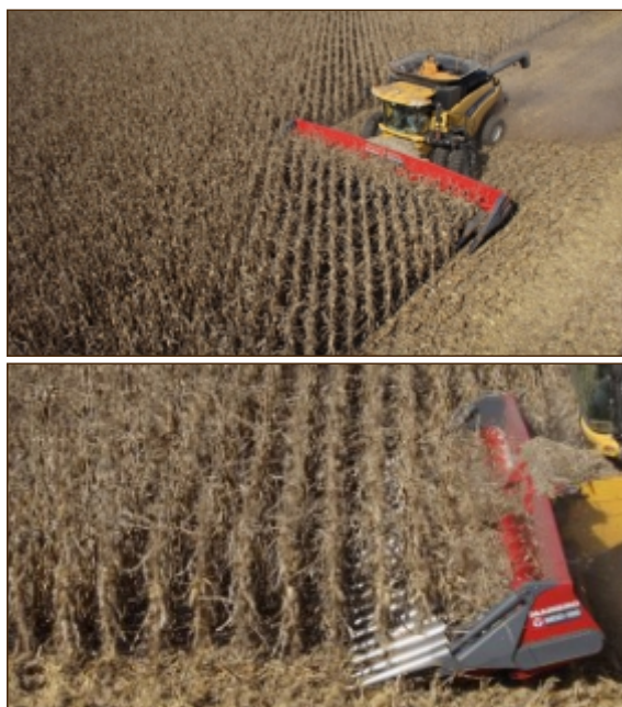
Figura 24: Cabezal Mainero MDD 100 trabajando a 45°(izq) y 90° (der) respecto a la línea de siembra
