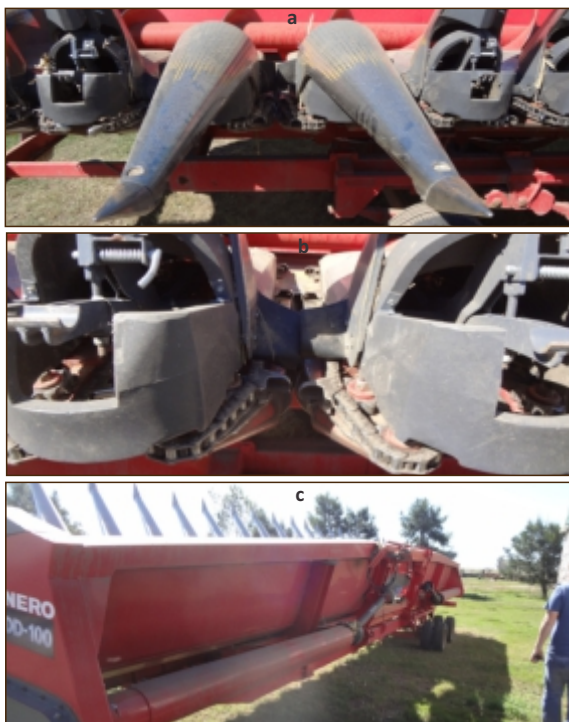
Figura 25: -a) Nuevos puntones de acero inoxidable, más agudos y de bajo perfil. -b)Detalle de nueva garganta de las chapas espigadoras y cucharas más anchas.-c)Detalle del nuevo chasis
