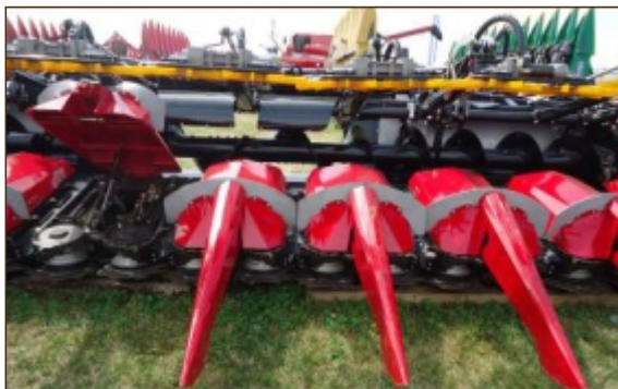
Figura 27: Cabezal Geringhoff para cosechar a cualquier distancia entre hileras. Para el 2015 con sistema de cosecha multi espacio entre hileras o al cruce tipo nuevo cabezal Mainero; se lo ve complicado, pesado y recién para el 2015 estará en el mercado.
