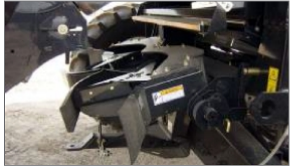
Figura 45: Esparcidor de granza centrífugos neumáticos de última generación. Existen otros diseños que funcionan verticalmente, también de manera muy eficiente.
