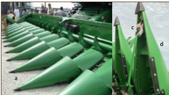
Figura 28: Cabezal de maíz de John Deere con tres opciones de tratamiento del tallo. Izquierda: cero daño del tallo. Centro: troceado sin cortar el tallo sólo con cuchilla del rolo. Derecha: rolo agresivo, más corte con hélice para labranza tradicional o reducida, los kit son opcionales de acuerdo al tipo de producto.
