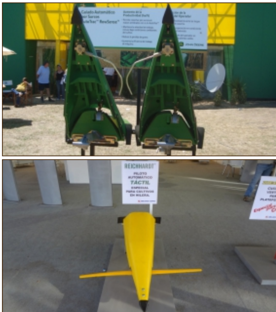
Figura 35: Palpadores de tallo para cabezales maiceros de materiales flexibles. Der: John Deere, Izq: Reichhardt Abelado Cuffia.
