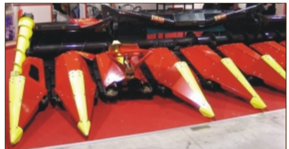
Figura 31: Otro adelanto que se debería incorporar a los cabezales argentinos es la regulación automática de la separación de la chapa cubre rolo, para que ésta se adapte automáticamente en tiempo real a cada zona del lote o hilera en particular. La patente la posee la firma DRAGO de Italia.
