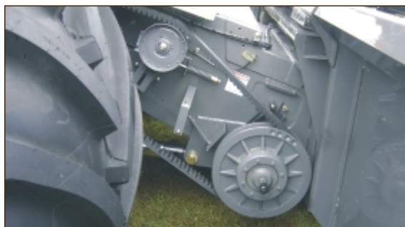
Figura 22: Mando del cabezal por medio de polea variadora, lo cual, permite regular la velocidad de giro del cabezal maicero, desde la cabina del operario, y de esta manera, lograr la coordinación perfecta entre altura del cultivo, velocidad del cabezal y de avance de la cosechadora.
