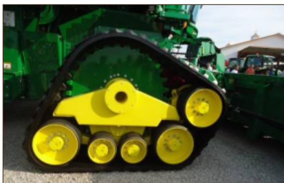
Figura 40: Nuevo sistema de oruga triangular irregular de John Deere con una forma particular de enfrentar la "onda" que le propone la deformación del suelo, simula la baja resistencia de rodadura de un neumático de gran diámetro, fue una innovación muy importante del Farm Progress Show 2013. ¿Será este el futuro en el traslado de las cosechadoras? La patente no es exclusiva de John Deere en este sistema.
