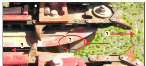
Figura 17: Sectores de sincronización de las cadenas alzadoras con la velocidad de avance del cabezal
