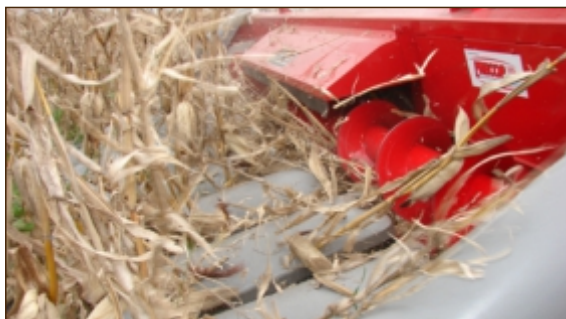
Figura 18: cabezal trabajando con buena coordinación entre velocidad de avance y régimen de los rolos espigadores. El espigado se produce en la 3/5 parte del recorrido.
