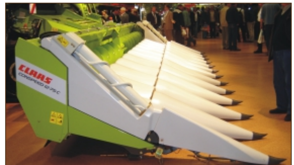
Figura 32: Detalle del cabezal Claas, donde se pueden apreciar los dos capot laterales equipados con rolos giratorios que facilitan la conducción e ingreso de las plantas de maíz; este equipamiento posee ventajas significativas en maíces con cierto % de vuelco.
