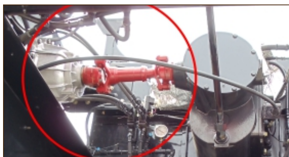
Figura 21: Sistema CVT de CASE que permite coordinar la velocidad de giro del cabezal con la velocidad de avance de la cosechadora en más, menos, un 20%, (a) vista del mando que va al cabezal, (b) vista cercana del mando del cabezal, (c) mando del rotor en vista posterior del CVT.
