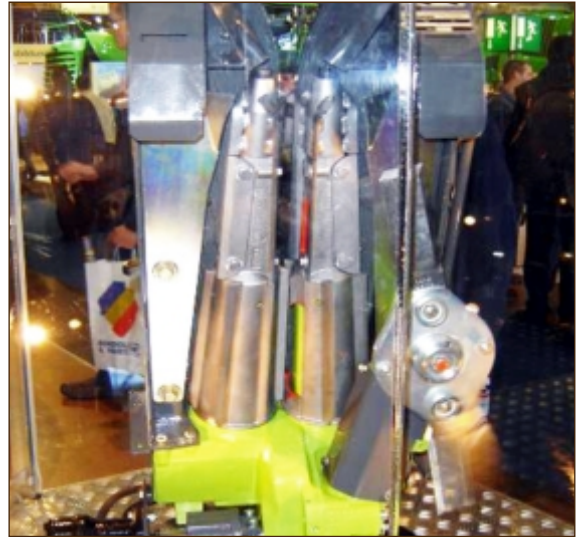
Figura 30: Otras novedades observadas en el diseño de cabezales, se las puede observar en los rolos espigadores cónicos, presentados experimentalmente en Europa, por la firma CLAAS, con una lógica de diseño dado que el tallo de la planta de maíz también es cónico, o sea, más grande abajo que arriba. Por otro lado, un rolo cónico podría bajar la planta con baja velocidad hasta las 3/5 parte del recorrido del rolo, provocar un espigado suave, y luego acelerar bruscamente la bajada de la planta para evitar que la misma ingrese a la cosechadora.
