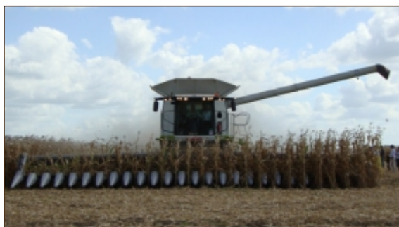
Figura 26: Cabezal Allochis de aluminio. 26 surcos.
