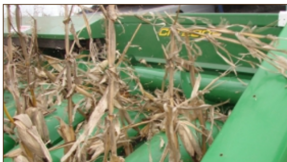
Figura 19: Mala regulación del cabezal, produciendo el espigado demaciado atrás con el consecuente incremento de material no grano que ingresa a la cosechadora
