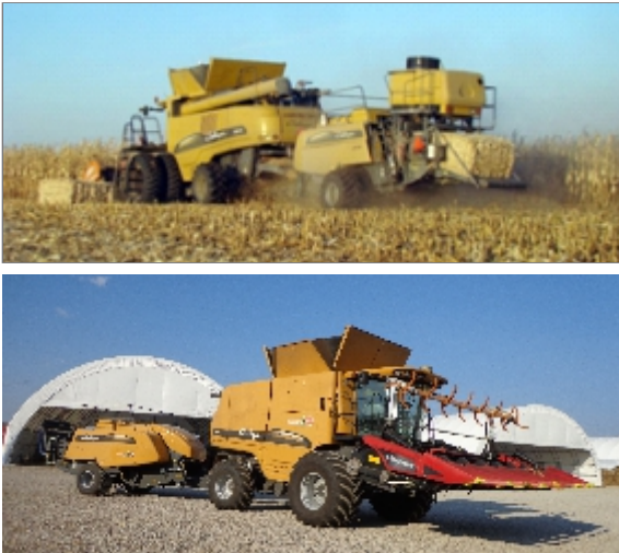
Figura 44: Cosechadora con cabezal maicero especial que corta la planta desde el 8 o nudo hacia arriba y que trabajan en tándem con una megafardadora provista de motor propio y que henifica el material no grano que sale por la cola de la cosechadora (marlo, chala y un tercio de los tallos)
