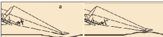
Figura 10: -a) Punteras Regulables en altura. Registro fácil y capaz de mantener la última regulación luego del transporte. Fuente: Mainero
