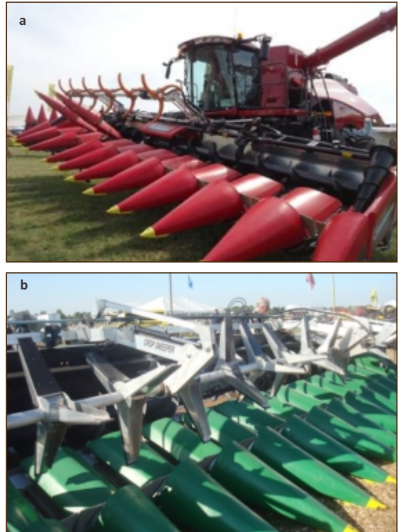
Figura 36: -a) Molinete pateador Crop Sweeper para trabajar en cultivos de maíz volcados o caídos. Presenta la posibilidad de ser regulable en su posición horizontal y vertical lo cual permite levantarlo para poder trabajar en cultivos normales, sin tener que extraerlo. Fuente: INTA 2009. -b) Cabezal Geringhoff con pateador para maíz caído de nuevo diseño, un producto muy prolijo (procedencia: Alemania).
