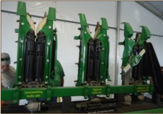
Figura 28: Cabezal de maíz de John Deere con tres opciones de tratamiento del tallo. Izquierda: cero daño del tallo. Centro: troceado sin cortar el tallo sólo con cuchilla del rolo. Derecha: rolo agresivo, más corte con hélice para labranza tradicional o reducida, los kit son opcionales de acuerdo al tipo de producto.
