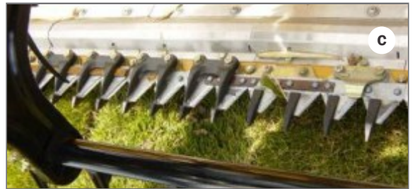
Figura 38. Cabezal CASE con alimentación por lonas trabajando en el cultivo de Soja, observar como se trasladan las plantas hacia el embocador, el cual alimenta al cilindro de manera uniforme y sin bollos, ni desgrane. Fuente: INTA PRECOP 2008.
