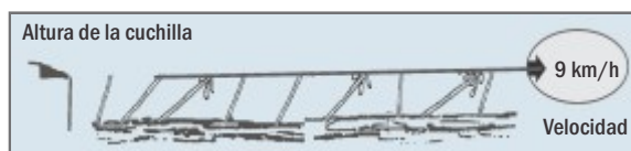
Figura 8. Tallos desuniformemente inclinados, algunos de ellos con vainas cortadas por altura real de corte alta, debido a la excesiva inclinación de la planta antes de ser cortada. Fuente: INTA PRECOP 2008.
