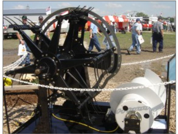
Figura 31. Detalle del Molinete orbital "Orbit Reel" de origen americano. A = Detalle de la forma de entrada y salida del diente, y B = Modificación del excéntrico o guía del diente para permitir acercarse más al molinete al cabezal, eliminando la zona de acumulación. (Figuras 30y31)HCC, Inc. - www.hccincorporated.com
