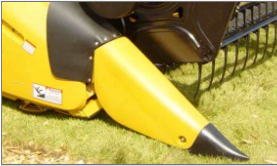
Figura 16. Separador lateral de diseño agudo y bajo peso.
