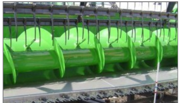
Figura 20. Sinfines de gran diámetro con dedos retráctiles en todo su largo y en el centro o zona de entrega dispuestos a 90°. Fuente: INTA PRECOP 2008.
