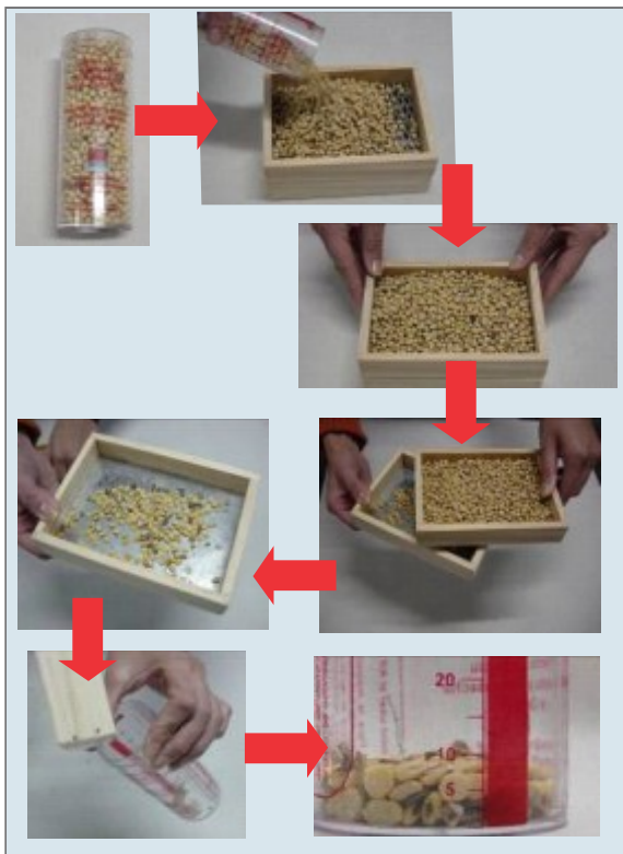
Figura 25. Pasos para la utilización en forma correcta del kit de evaluación de daño mecánico visible en soja. Fuente: INTA PRECOP, 2004.
