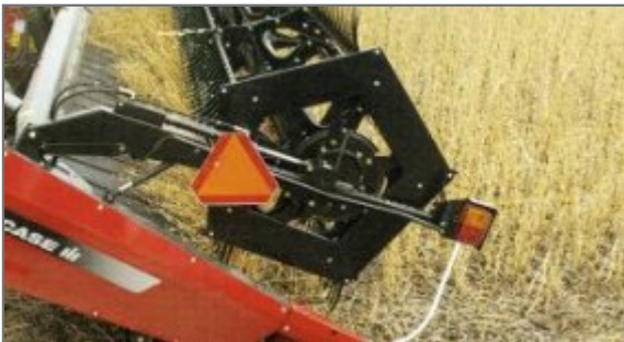
Figura 38. Cabezal CASE con alimentación por lonas trabajando en el cultivo de Soja, observar como se trasladan las plantas hacia el embocador, el cual alimenta al cilindro de manera uniforme y sin bollos, ni desgrane. Fuente: INTA PRECOP 2008.
