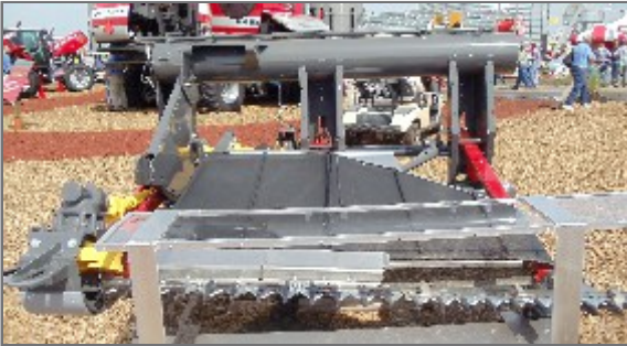
Figura 41. Nuevo cabezal Draper flexible de 5 lonas, hydraflex de 35 y 40 pies de ancho, con doble cuchilla cardanica, sincronizada, con copiado por sensores sin ruedas, por ahora solo experimental.
