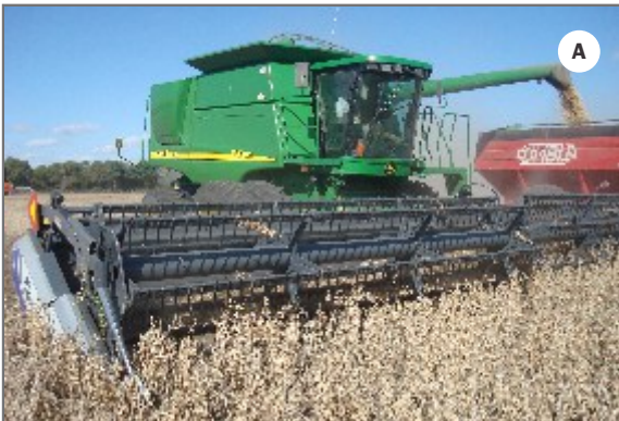
Figura 39 A. Cabezal de alimentación por lonas flexibles (primero fabricado en latinoamerica), marca Piersanti, de origen nacional, trabajando en Soja.
