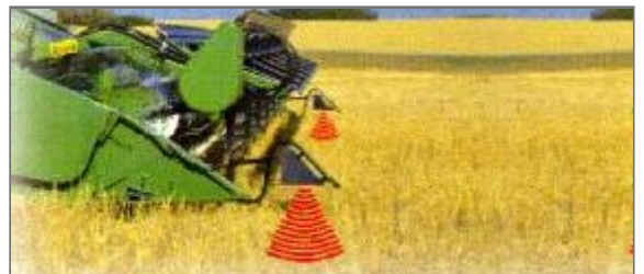
Figura 43. Esquema del sensor ultrasónico colocado a ambos extremos de un cabezal de gran ancho de labor. Fuente: www.norac.ca
