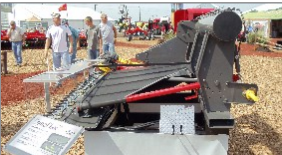
Figura 42. Nuevo cabezal Dynaflex de AGCO con flexible hidroneumatico y mando de cuchillas doble sincronizado, molinete orbital, con copiado de sensores sin ruedas.
