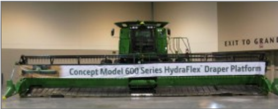
Figura 41. Nuevo cabezal Draper flexible de 5 lonas, hydraflex de 35 y 40 pies de ancho, con doble cuchilla cardanica, sincronizada, con copiado por sensores sin ruedas, por ahora solo experimental.
