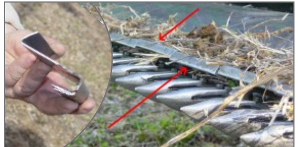
Figura 19. Vista de las chapas individuales que componen el kit para reducción de pérdidas por desgrane y su ubicación, una vez colocadas en la barra de corte. Fuente: INTA PRECOP 2004.
