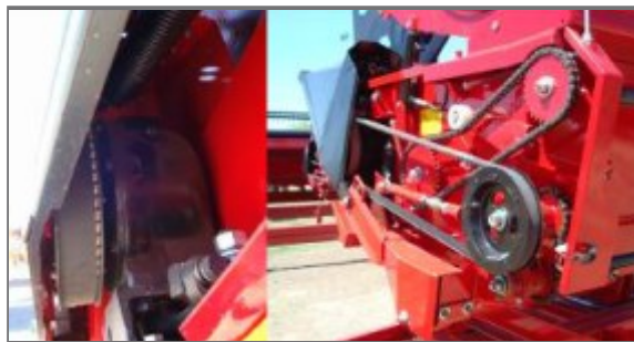
Figura 44. Nuevo sistema de transmisión sincronizado para caja de cuchillas de plataformas de origen nacional.
