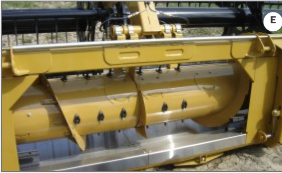
Figura 40. A = Cosechadora CAT / Claas de 516 HP sistema de trilla y separación híbrido. Trilla convencional con acelerador Mega y doble rotor axial de separación. Cabezal flexible, flotante autonivelante de nueva generación. B = Lateral del cabezal con doble molinete, doble cuchilla y doble sinfín, montado en un bastidor único de 40 pie de ancho. C = Detalle de la doble cuchilla, parte central superpuesta. D = Detalle del doble molinete de 20 pie. E = Detalle del doble sinfín con bancada central.
