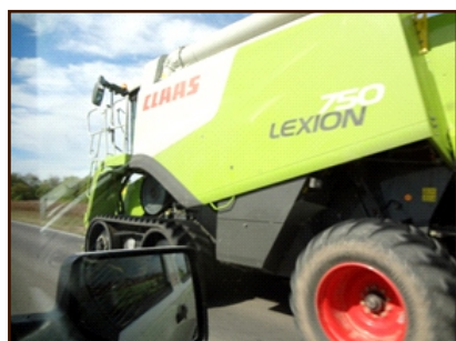
Figura 22: Cosechadora equipada con sistema de oruga que no supera los 3.50 m de ancho.
