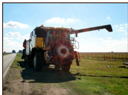
Figura 24: Equipar a la máquina con neumáticos duales brinda una mayor flexibilidad a la hora del traslado.
