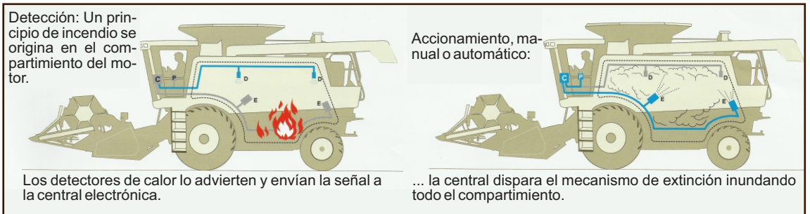
Figura 30: Modo de acción del sistema de protección contra incendio Georgia GVS 200
