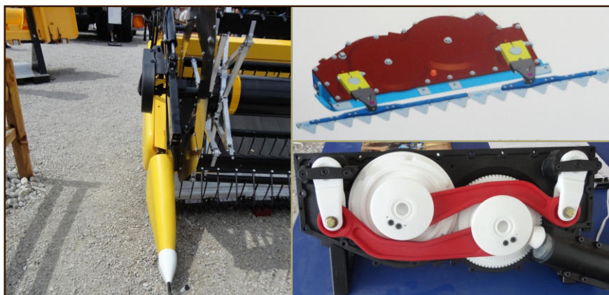
Figura 12. Nuevo cabezales Draper New Holland 2012 equipado con caja Sincro Drive Gearbox ubicada en el centro de gravedad de la plataforma y puntones laterales de agudos de menor ancho.
