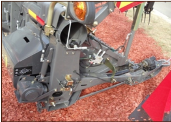
Figura 10: Mando cardánico para el accionamiento de las cuchillas.
