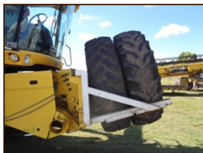
Figura 24: Equipar a la máquina con neumáticos duales brinda una mayor flexibilidad a la hora del traslado.
