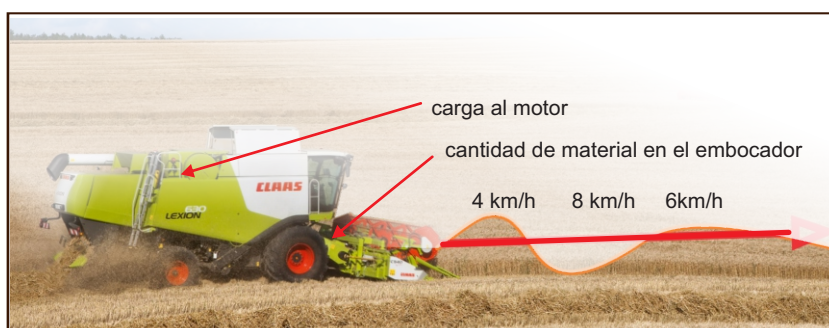
Figura 5. Cosechadora inteligente: autorregulación de la velocidad de avance, para mantener el flujo de alimentación constante, frente a cambios de ambientes y de rendimiento.
