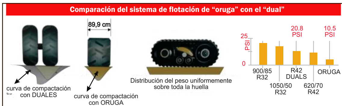
Figura 19: Cuadro comparativo del sistema por orugas de caucho respecto a los otros sistemas de traslado de cosechadoras. Fuente: Claas Estados Unidos. Farm Progress Show 2011.
