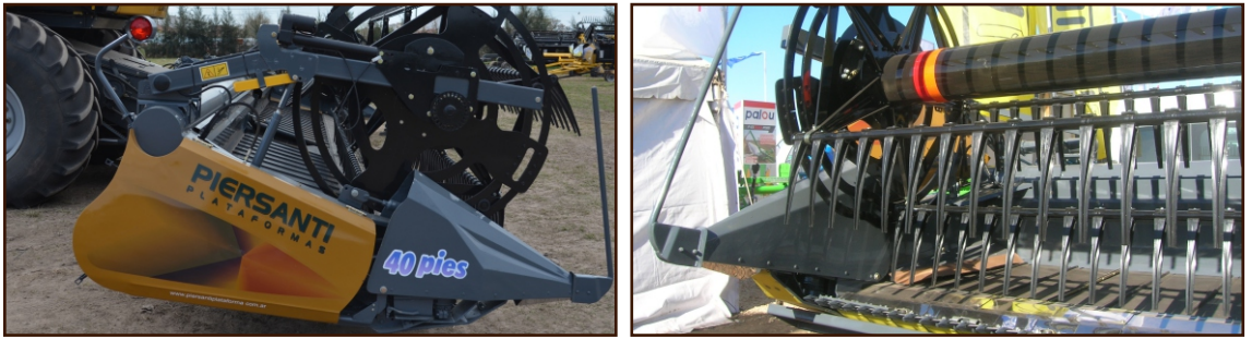
Figura 13: Detalle del nuevo molinete del draper Piersanti
