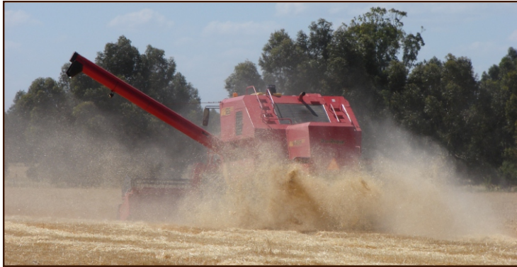
Figura 28: Nube de paja y granza en trigo generada en la cola de la cosechadora
