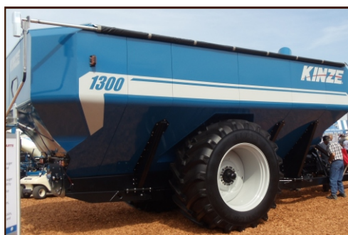
Figura 18. Cosechadoras y tolvas equipadas con neumáticos radiales de alta flotabilidad y buen ancho.
