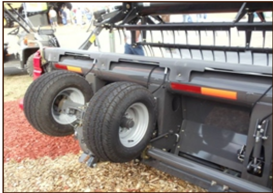
Figura 11: Sistema de copiado de terreno con doble neumático.
