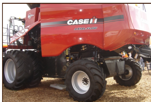
Figura 18. Cosechadoras y tolvas equipadas con neumáticos radiales de alta flotabilidad y buen ancho.
