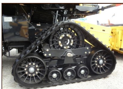
Figura 20. Cosechadoras con orugas de caucho de buena prestación para disminuir la compactación y el fuelleado característico que producen los neumáticos tradicionales.
