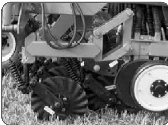
Figura 51. Sembradora de grano fino con paralelogramo deformable.
