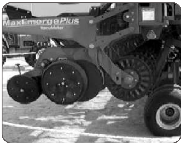
Figura 34. Cuchilla de borde liso solidaria al carro de siembra.
