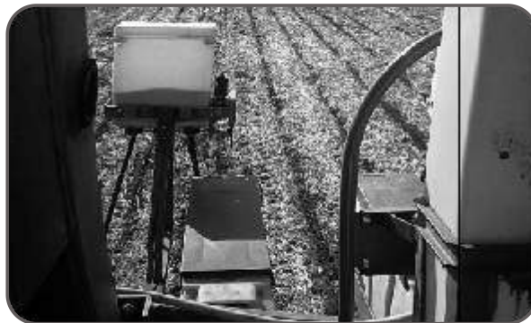
Figura 38. Imagen del terreno luego del trabajo de la sembradora con barredor de residuos.
