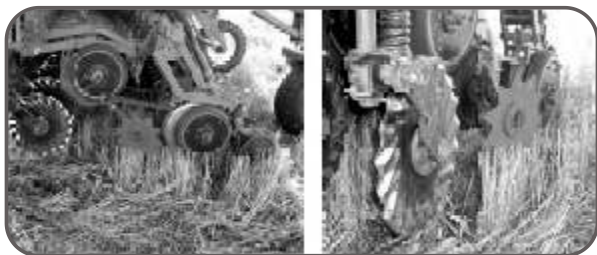
Figura 37. Vista de un barredor de rastrojo traccionado y su ubicación en el tren de siembra.
