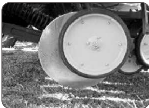
Figura 53. Sistema abridor monodisco típico.
