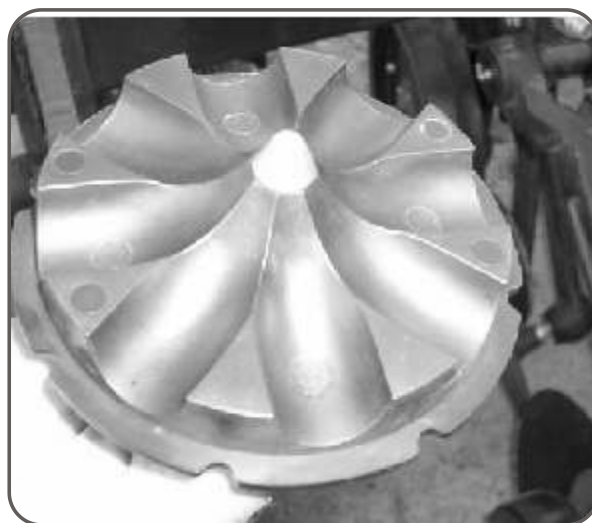
Figura 61. Sistema de distribución de semilla tipo araña con suavizador de impacto especial para semilla de Soja.
