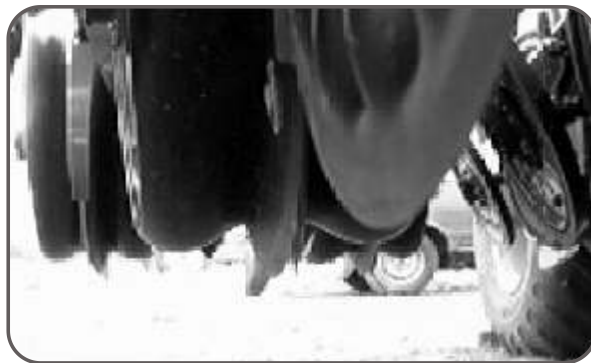
Figura 42. Vista de rueda tapadora, nótese la depresión aledaña al disco abridor.
