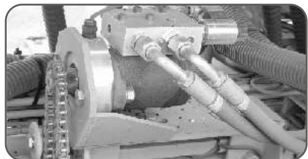
Fig. 4: detalle de uno de los 3 motores hidráulicos variadores de vueltas del tren cinemático para dosificar variable tanto semilla como fertilizante.
