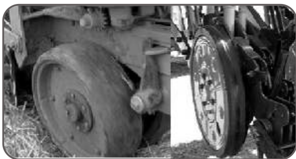
Figura 41. Izk.: Rueda controladora de profundidad de caucho de ancho normal, Der.: Rueda controladora de profundidad de reducido ancho y gran largo de pisada.
