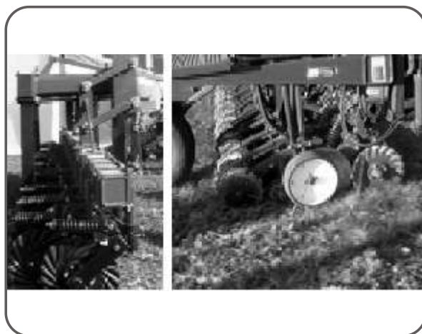
Figura 54. Izq.: Paquete de cuchillas adaptable a sembradoras con sistema abridor de monodisco; Der.: Paquete de cuchillas para sistemas monodisco de fábrica.
