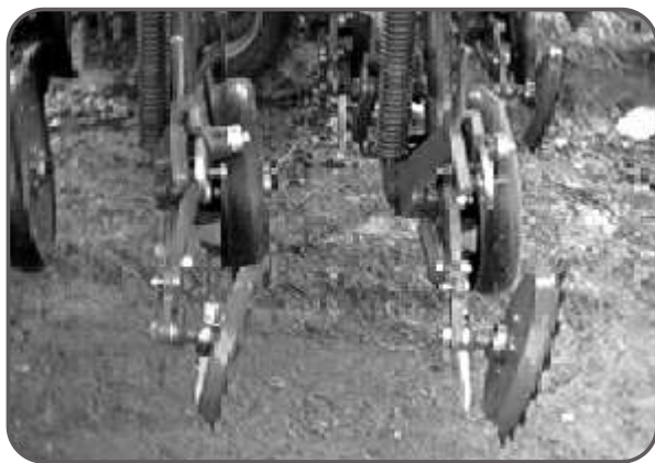
Figura 52. Cuerpos de siembra de una sembradora de grano fino. Nótese: la adecuada distancia entre los cuerpos.
