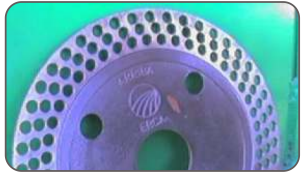
Figura 5. Placa de siembra para Soja con tres hileras de alvéolos.
