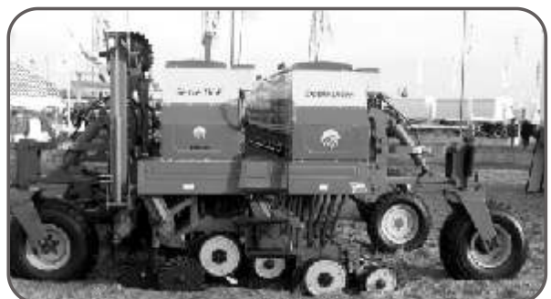
Figura 66. Sembradora con sistema de paralelogramo y chasis a baja altura.
