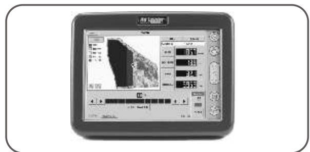
Figura 3. Pantalla del nuevo monitor Insight de AgLeader, mostrando la confección de un mapa de rendimiento en colores en tiempo real, superpuesto a un mapa de híbridos de Maíz.
