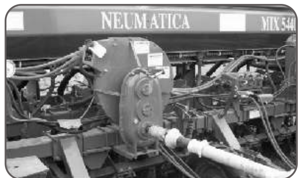
Figura 19. Vista de la bomba hidráulica encargada de abastecer al sistema de vacío.
