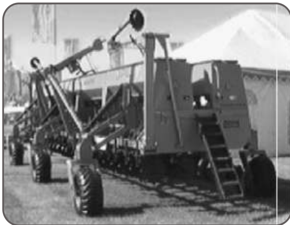
Figura 1. Vista lateral de una típica sembradora con depósito de semilla y fertilizante tipo monotolva (tolva única).
