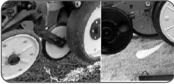
Figura 43. Izk.: Ruedas apretadoras, Der.: lengüetas apretadoras (Cola de castor).
