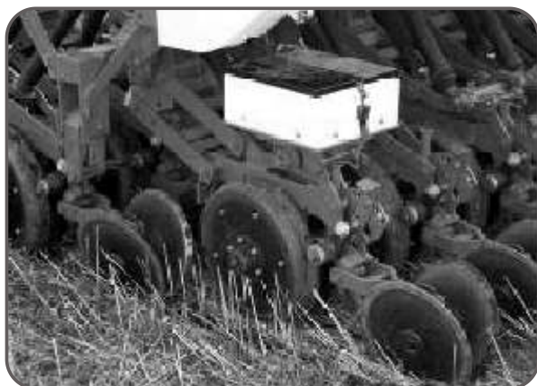
Figura 68. Sembradora con sistema dual y paralelogramo.
