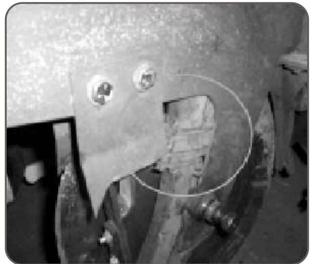
Figura 26. Vista lateral de la ubicación del caño de bajada entre el doble disco plantador. Detalle: fotocélula de lectura para monitores de siembra.
