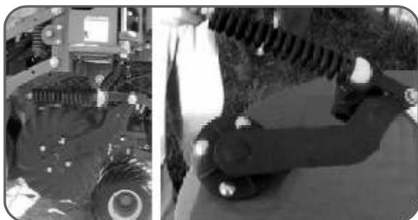
Figura 33. Izq.: Soporte de cuchilla fijo adherido al bastidor de la sembradora, Der.: Soporte de cuchilla de ángulo variable y presión constante de diseño nacional.
