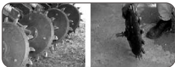
Figura 58. Izq.: Rueda tapadora de diseño estrellado que cumple además funciones de apretado de la semilla. Der.: Detalle de la rueda tapadora con suplemento dentado tipo barredor.
