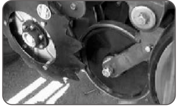
Figura 45. Rueda apretadora con banda externa de acero inoxidable.
