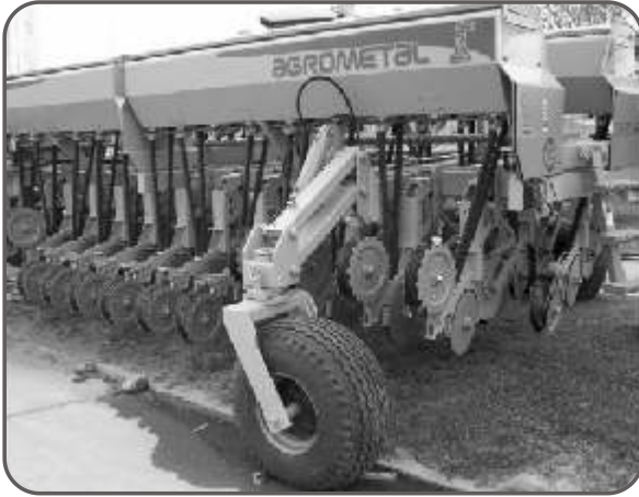
Figura 71. Máquina intersebradora específica para la siembra en forma solapada de Soja sobre Trigo.
