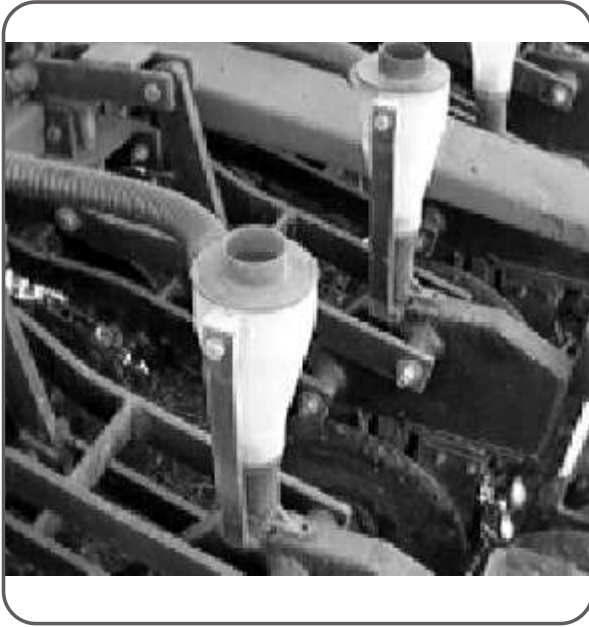
Figura 62. Detalle de ciclón que posibilita la pérdida de velocidad de la semilla y salida del aire sobre cada tubo de bajada.
