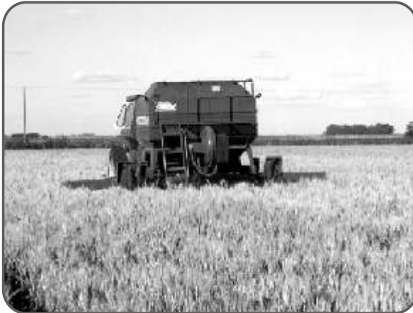
Figura 72. Sembradora Air Drill para siembra de Soja solapada en Trigo.
