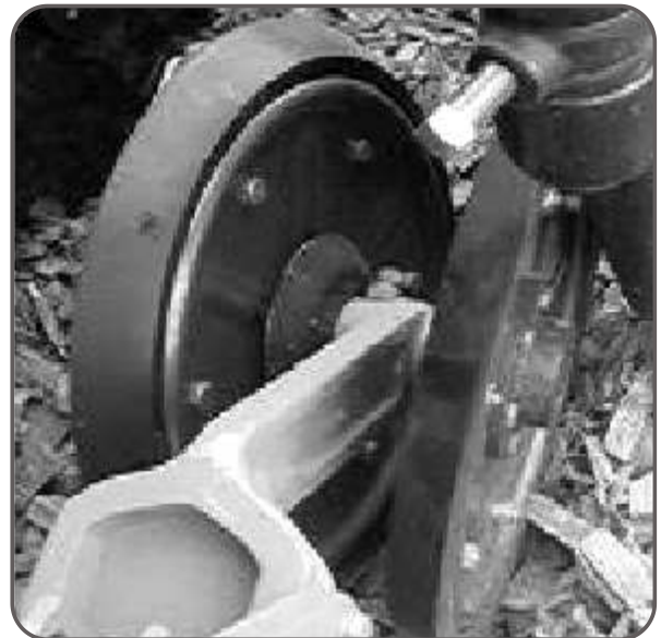
Figura 57. Ruedas tapadoras biseladas como sistema de control de profundidad trasero.
