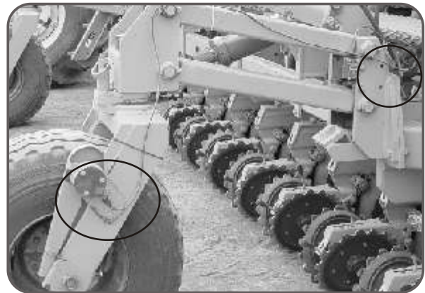
Fig. 3: sensor en la rueda y activador de siembra cuando la máquina está clavada.
