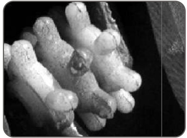
Figura 13. Vista de las ruedas expulsoras, en este caso para una placa de tres hileras de alvéolos.
