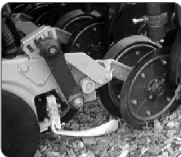
Figura 56. Sistema de control trasero de profundidad.
