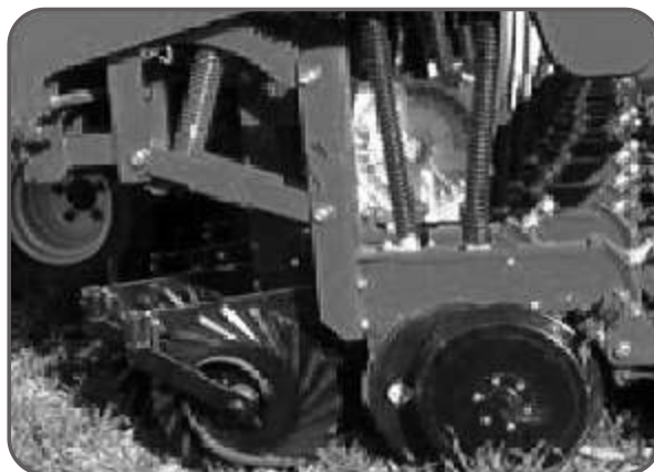
Figura 35. Cuchilla solidaria al carro de siembra con profundidad de trabajo excesiva.
