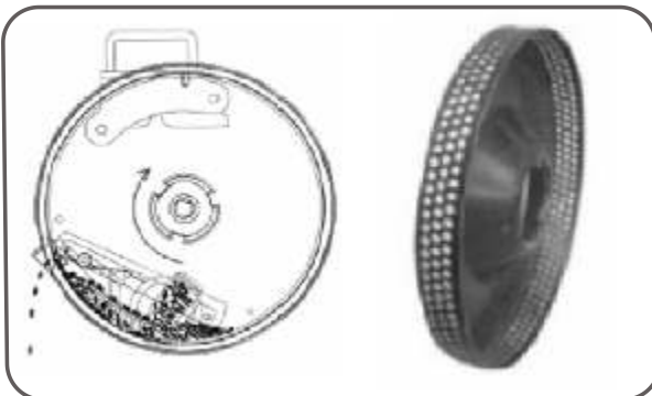
Figura 17. Sistema distribuidor mecánico con placa vertical alveolada (Hilcor/Yomel), donde el caño de bajada es más corto y más ancho que el convencional.
