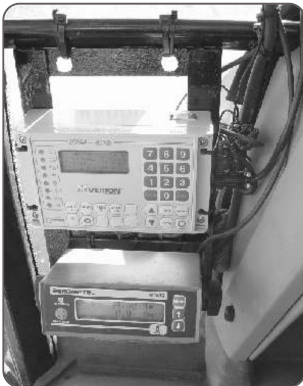
Fig 1: ubicación en el tractor del monitor Verion (arriba) y monitor de siembra Agrometal (abajo).
