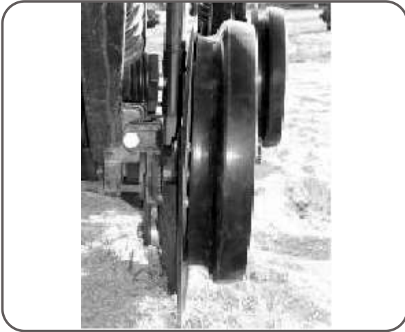
Figura 55. Nuevo sistema de mono disco cónico.
