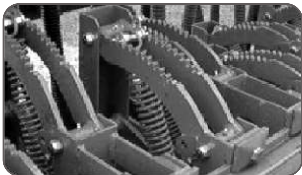
Figura 40. Vista del carro de siembra y los resortes de carga variable que le dan presión al abre surco de doble disco.
