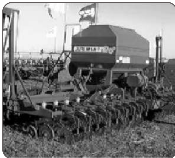
Figura 60. Sembradora Air Drill con doble disco abre surcos y sistema de paralelogramo de fabricación nacional.
