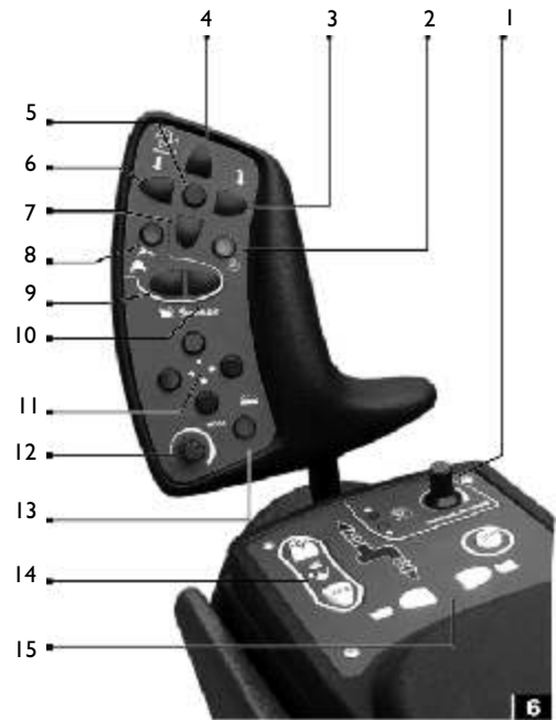
Figura 259. Descripción de los comandos de una cosechadora moderna: 1) Regulador de altura del cabezal, 2) Automático del control de altura del cabezal y de la barra de corte, 3) Inclinación derecha del basculante, 4) Subir plataforma, 5) Nivelar - basculante, 6) Inclinación izquierda del basculante, 7) Bajar plataforma, 8) Descarga de granos, 9) Abretubo de descarga, 10) Cierratubo de descarga, 11) Posición del molinete (adelante/atrás, arriba/abajo), 12) Regulación de velocidad del molinete (1M), 13) Indicador de automático/manual de la velocidad del molinete, 14) Acelerador del motor, 15) Abre cierra tapa de la tolva. Además al mover todo el joystick hacia adelante y atrás, se gobierna la velocidad de la cosechadora con velocidad hidrostática.
