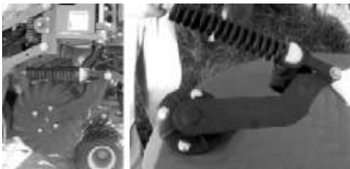
Figura 47. Izq.: Soporte de cuchilla fijo adherido al bastidor de la sembradora, Der.: Soporte de cuchilla de ángulo variable y presión constante de diseño nacional.
