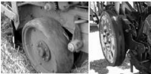
Figura 55. Izq.: Rueda controladora de profundidad de caucho de ancho normal, Der.: Rueda controladora de profundidad de reducido ancho y gran largo de pisada.
