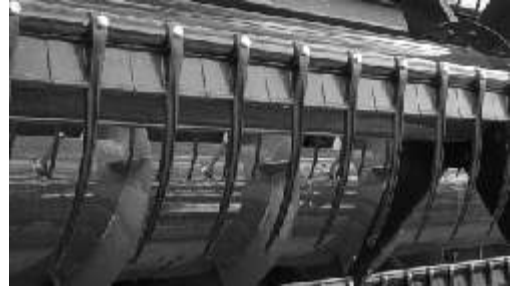
Figura 147. Detalle de los dientes plásticos de forma cónica. Presentan la ventaja de menor envoltura de plantas que sus similares de acero. La púa plástica debe estar construida de plástico resistente a los rayos solares (aditivos "UV") y también ser altamente flexibles, con buena memoria, siendo además resistentes a la rotura.
