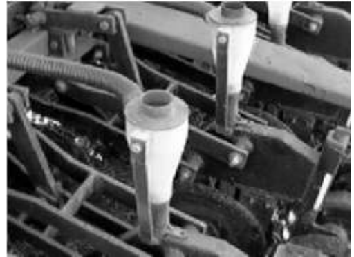
Figura 76. Detalle de ciclón que posibilita la pérdida de velocidad de la semilla y salida del aire sobre cada tubo de bajada.
