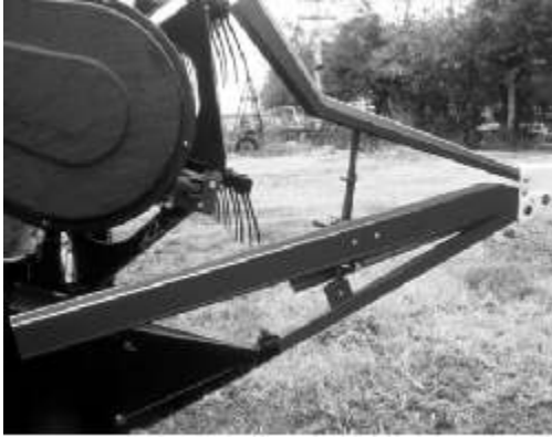
Figura 179. Vista del puntón lateral derecho.
