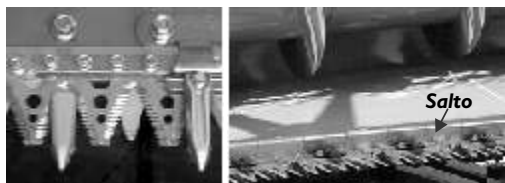
Figura 129. Vista de los nuevos diseños de barra de corte de 2" x 2" con recorrido de 3,5" (cabezales serie 600). Fuente: John Deere Company. El sistema funciona bien en el 70% de los casos pero está siendo reemplazado (ver aclaración siguiente).
