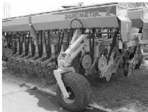
Figura 85. Máquina intersembradora específica para la siembra en forma solapada de Soja sobre Trigo.
