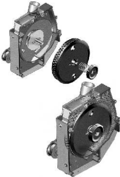
Figura 30. Esquema mostrando el sistema distribuidor mecánico con placa vertical tipo Great Plaint (EE.UU.), donde la carga se realiza por arriba de la placa muescada y un engrasador lo deja monograno, siendo la entrega al caño de bajada similar a un distribuidor neumático, por lo que se aconseja que el mismo sea curvo.
