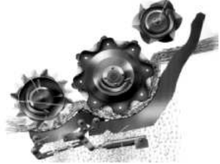
Figura 194. Sistema de trilla con acelerador y colado de grano progresivo.
