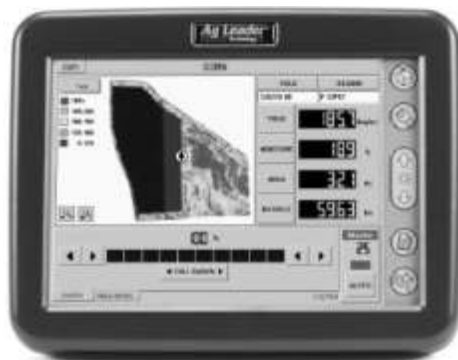
Figura 265. Pantalla del nuevo monitor Insight de AgLeader, mostrando la confección de un mapa de rendimiento en colores en tiempo real, superpuesto a un mapa de híbridos de Maíz.
