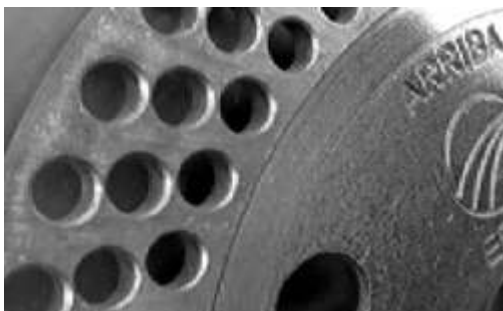
Figura 23. Placa de siembra con alvéolos de doble frezado. Observar que el frezado de carga es suave para facilitar la carga, evitando los daños mecánicos a la semilla.
