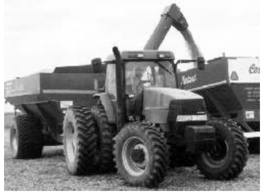
Figura 236. Los acoplados tolva autodescargables con neumáticos de alta flotación deben, en lo posible, ser traccionados por tractores 4 x 4 articulados, o 4 x 4 asistidos con duales en el tren trasero (ideal todos los neumáticos radiales), esto le confiere una armonía de presión sobre el suelo de todo el equipo..
