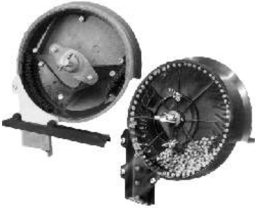
Figura 29. Esquema mostrando el sistema distribuidor mecánico de placa vertical acanalada con cepillos (Kinze, EE.UU), Der.: Obsérvense los cepillos de sostén de las semillas.
