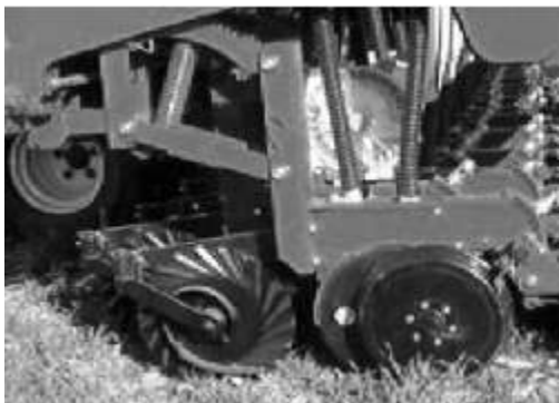
Figura 49. Cuchilla solidaria al carro de siembra con profundidad de trabajo excesiva. (Problema de regulación).
