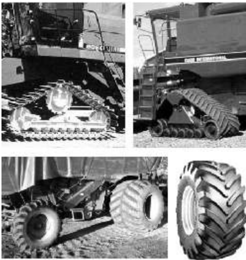
Figura 234. Sistemas de traslado de alta flotabilidad: A) Semiorugas metálicas, B) Semiorugas de caucho, C) Neumáticos tipo Terra – Tyre de muy baja presión de inflado y alta flotabilidad, D) Neumático radial con tacos a 45°.
