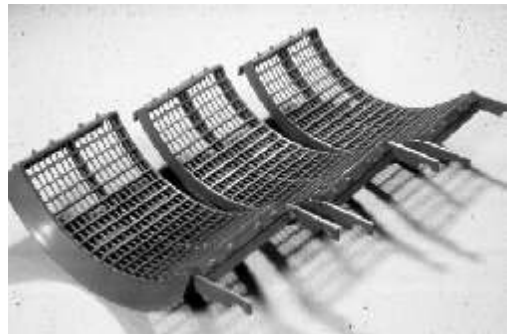
Figura 201. Cóncavos de trilla de la cosechadora axial (generalmente dispuestos en tres tramos).
