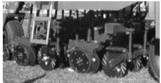
Figura 81. Sembradora con sistema abresurco montado en paralelogramo secundario, buen desahogo de residuos.
