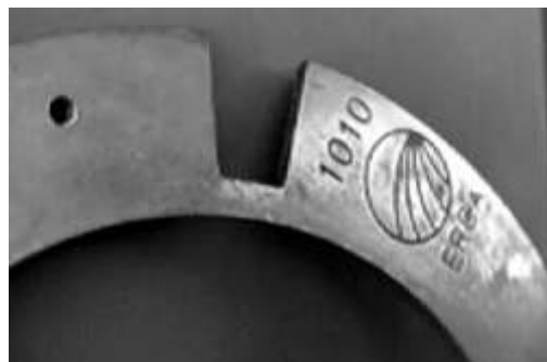
Figura 25. Vista de la contraplaca recomendada para Soja y su orificio de salida.
