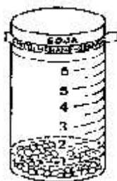
Figura 248. Recipiente diseñado por INTA, para evaluación de pérdidas.
