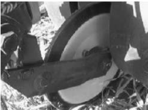
Figura 58. Rueda apretadora con bordes engomados con reducido ancho de pisada.
