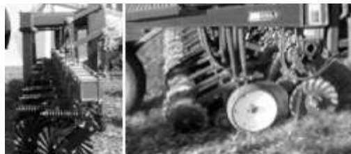
Figura 68. Isq.: Paquete de cuchillas adaptable a sembradoras con sistema abridor de monodisco, Der.: Paquete de cuchillas para sistemas monodisco de fábrica.
