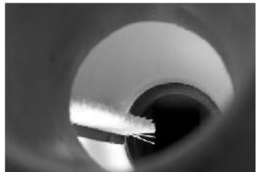
Figura 77. Detalle del cepillo dentro del ciclón, que mejora la entrega de semilla en este tipo de máquina de origen nacional.
