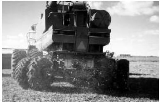
Figura 235. Cosechadora 8 x 4. Vista trasera de un equipamiento ideal para transitar en situaciones extremas. Rodados duales con cubiertas internas tipo pala, lo que permite mayor flotabilidad y alta transitabilidad.
