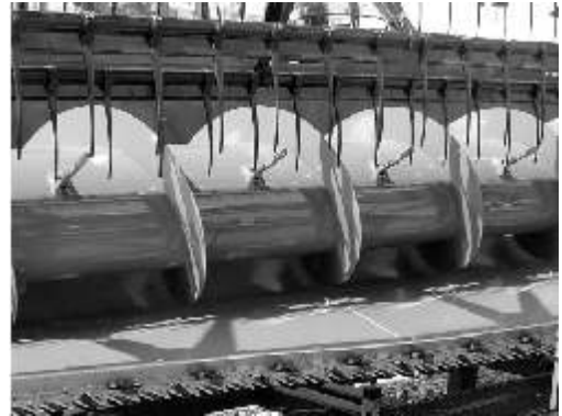
Figura 174. Sinfín con dedos retráctiles en todo su ancho.
