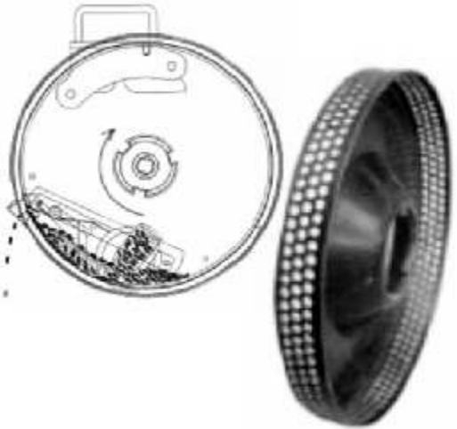
Figura 31. Sistema distribuidor mecánico con placa vertical alveolada (Hilcor/ omel), donde el caño de bajada es más corto y más ancho que el convencional.
