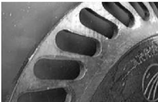
Figura 24. Placa de siembra de alta densidad, con orificios oblongos. Este tipo de placas también son utilizadas para alta velocidad de siembra.
