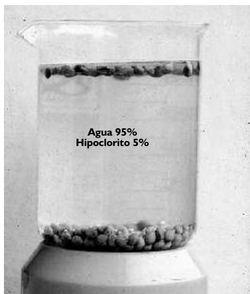
Figura 223. Método del Hipoclorito: evaluación química del porcentaje de daño mecánico en Soja.
