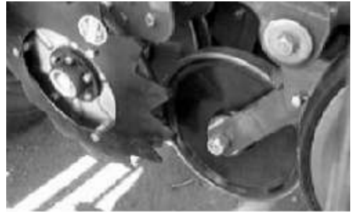
Figura 59. Rueda apretadora con banda externa de acero inoxidable.
