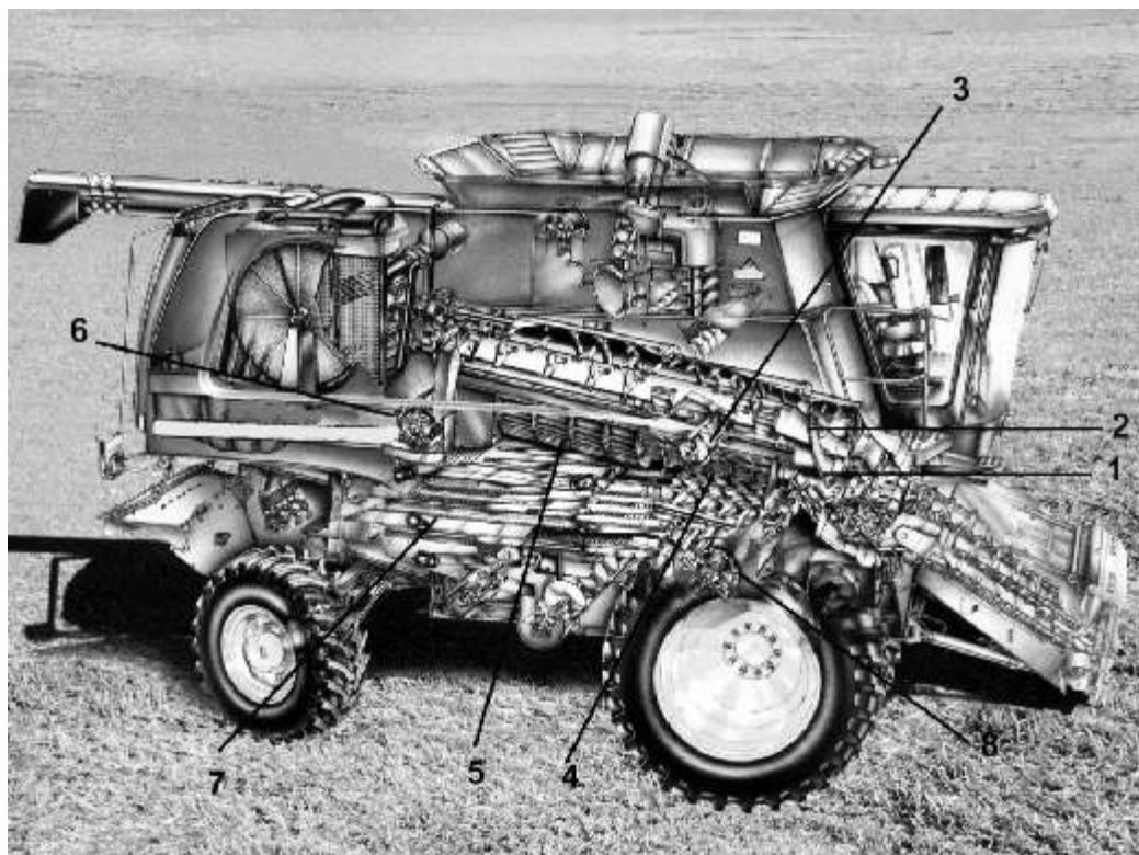
Figura 196. Esquema de una cosechadora de flujo axial (John Deere Ind.): 1) Cono de entrada, 2) Rotor, 3) Barras batidoras, 4) Cóncavos de trilla, 5) Cóncavos de separación, 6) Despajador de descarga, 7) Zarandas de limpieza, 8) Turbina de aire.
