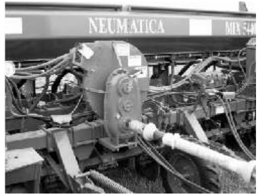
Figura 33. Vista de la turbina encargada de generar la succión necesaria al sistema de distribución por vacío.
