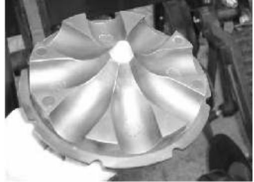
Figura 75. Sistema de distribución de semilla tipo araña con suavizador de impacto especial para semilla de Soja.
