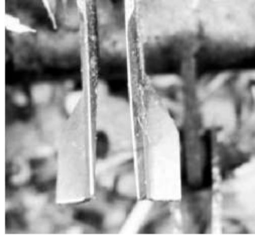
Figura 225. Cuchilla del triturador tipo paleta, que genera una mayor corriente de aire, mayor velocidad de salida del material picado y mejor uniformidad de distribución.
