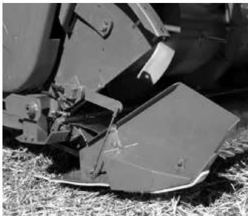
Figura 111. A) Vista lateral del sistema de sensores de los cabezales Hydraflex.
