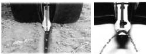
Figura 14. Detalle de la colita plástica fijadora de grano, colocando fertilizante líquido a un costado de la semilla, de manera muy sencilla.
