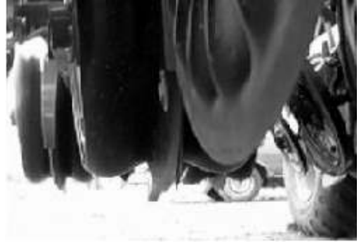
Figura 56. Vista de rueda tapadora, nótese la depresión aledaña al disco abridor.
