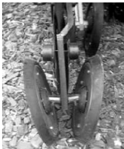
Figura 61. Ruedas tapadoras gemelas de caucho biselado.
