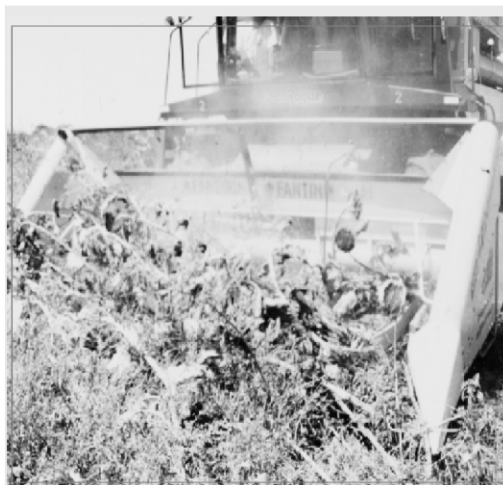
Figura 22: Detalle de la capacidad de recolección del cabezal europeo en girasol volcado y enmalezado.
