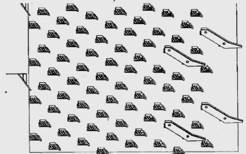
Figura 28: Esquema de la configuración del rotor axial para girasol con cuatro barras helicoidales que aceleran la separación, evitando recargar la limpieza.
