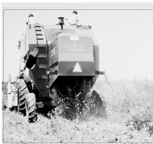
Figura 23: Vista de ensayos de capacidad de recolección, trilla, separación y limpieza, realizado en 1998 por INTA Manfredi.
