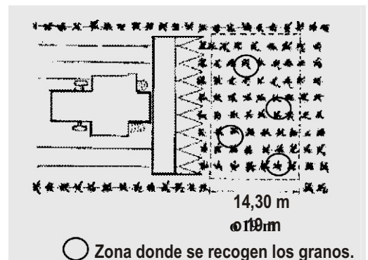
Figura 33: El área determinada por punteo es donde se recogen los capítulos caídos o adheridos a las plantas, en una posición que no pueden ser recolectados y los círculos negros son los aros de 56 cm. de diámetro (4 aros = 1 m 2 ), donde se recolecta lo desgranado de pre-cosecha (pérdida de pre-cosecha).
