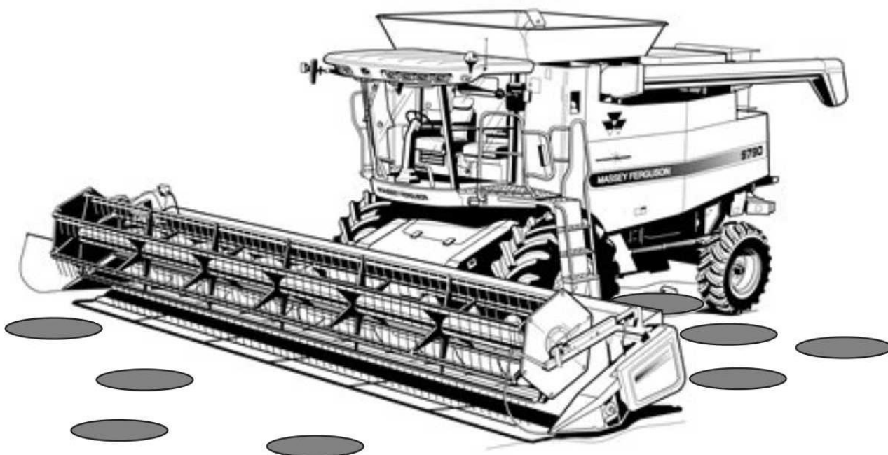
Fig. 75 Previo al paso de la cosechadora se miden pérdidas precosecha y durante el paso de la
