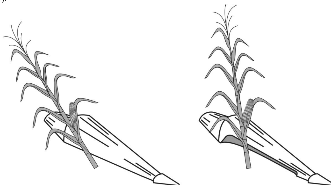
Diseño de puntones. Izquierda: diseño de un puntón convencional. Derecha: diseño del puntón del cabezal multidistancia con la base recortada (Lambertini, 2017).
