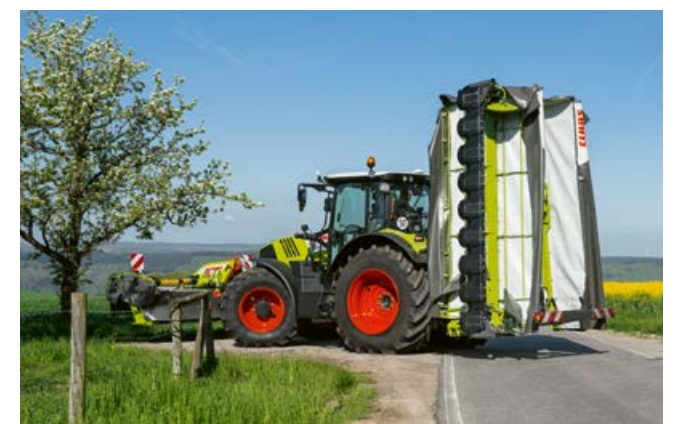
Por debajo de 4 m de altura y absolutamente compacta, como todos los modelos DISCO: Antes de plegarla, las dos unidades segadoras se recogen telescópicamente.
