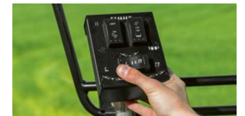
Para DISCO 1100 TREND se ofrece una práctica unidad de mando para la elevación individual, el pliegue a la posición de transporte y opcionalmente para encender y apagar los focos de trabajo.
