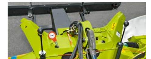
Manómetro para el fácil ajuste de la presión de apoyo para las dos unidades segadoras.
