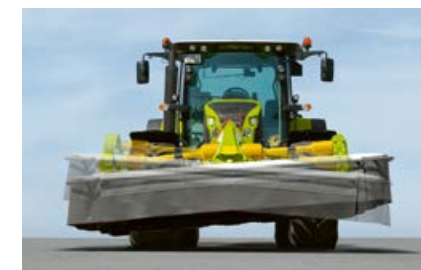
Adaptación transversal al sentido de marcha con el enganche que gira libremente.
