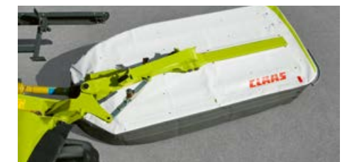
Soltar el seguro mecánico antichoque: La máquina se desplaza en el caso de un choque hacia atrás y también ligeramente hacia arriba (en DISCO 1100 TREND con seguro hidráulico antichoque non-stop).
