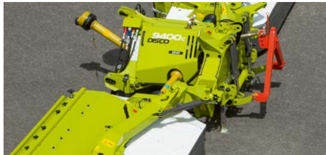
Protección en el caso de choque mediante el seguro antichoque hidráulico Nonstop: La unidad segadora sale y se coloca por si misma en la posición de salida.
