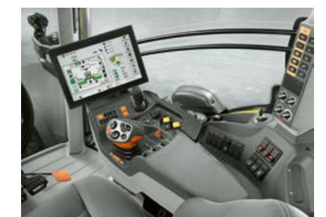
Cuando el tractor está equipado con un terminal compatible con ISOBUS, el manejo preseleccionado para el CONTOUR puede ejecutarse directamente a través de este.
