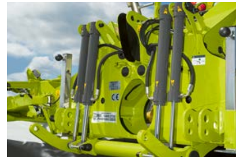
Los cilindros de elevación y de descarga de serie del sistema de descarga ACTIVE FLOAT garantizan un resultado que protege la capa de hierba.
