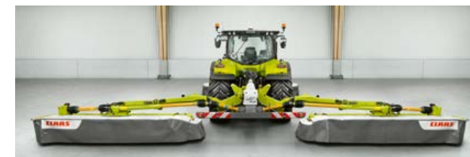
Dos brazos hidráulicos telescópicos conmutables con un ajuste continuo para un solapamiento óptimo en la DISCO 1100 TREND.
