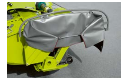
Con el punto de giro bajo, DISCO PROFIL sigue el suelo y no al tractor.
