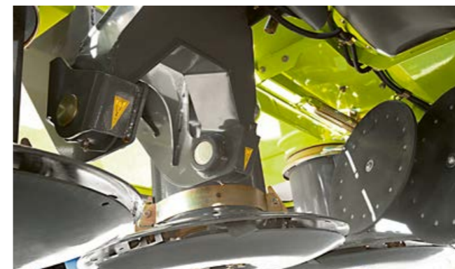
El punto de giro cercano al suelo ofrece una óptima adaptación longitudinal de la segadora.
