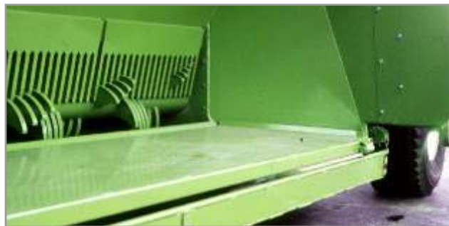
Figura 10.35. Sistema de doble fondo que facilita el vaciado del túnel, dentro de la bolsa.
