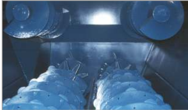
Figura 11.28. Mixer con 4 sinfines, dos cortos y dos largos y que cuentan con cuchillas en la periferia de los sinfines.
