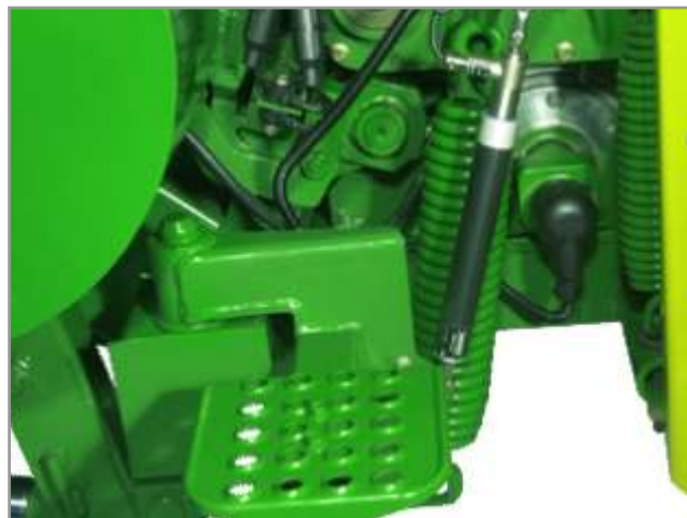
Figura 7.32. Ubicación de sensor de flujo de forraje.
