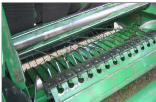
Figura 4.78. Rotores alimentadores o aceleradores del forraje al interior de la cámara de compactación, que se ubican posteriores a los recolectores (vista interna de la cámara de compactación).
