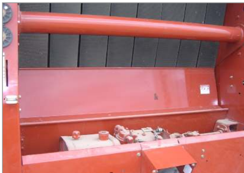
Figura 4.89. Sistema hidráulico independiente con bomba accionada por la TDP del tractor.
