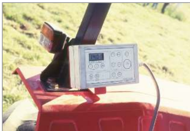
Figura 5.24. Contador de vueltas de la mesa para mayor eficiencia en la envoltura.
