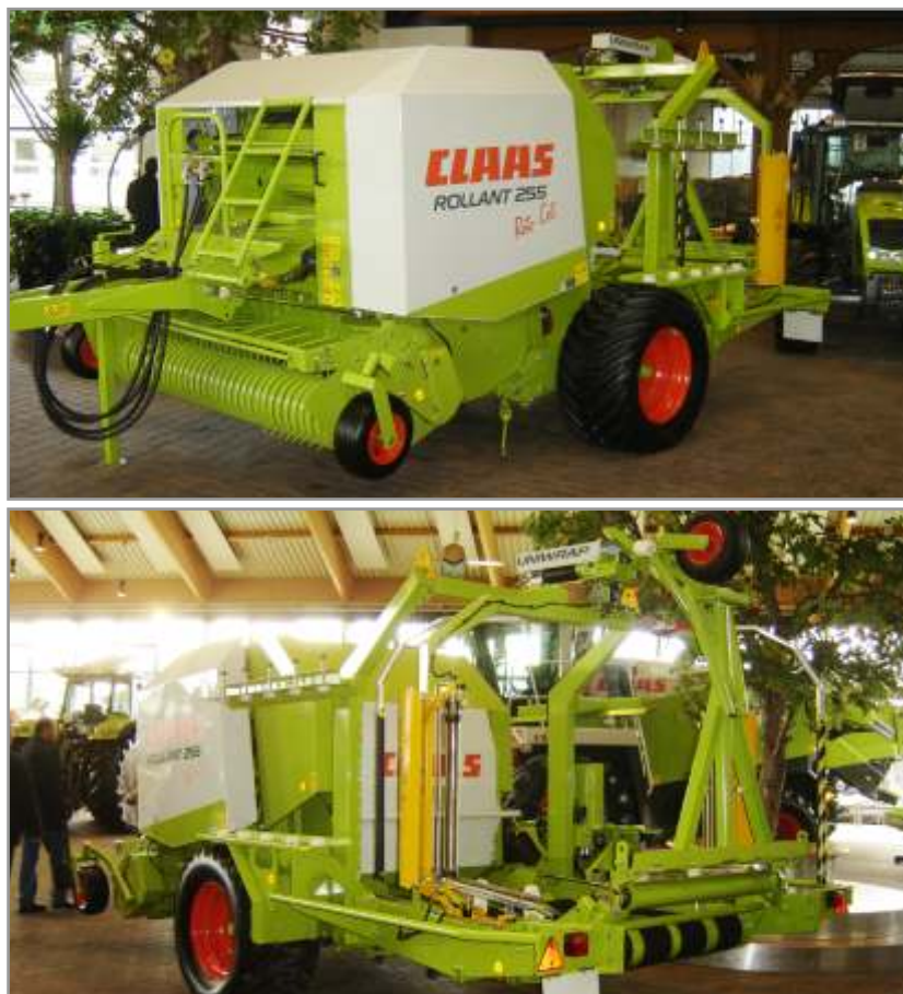
Figura 5.35. Enrolladora europea con empaquetadora en su parte posterior, para agilizar la tarea y reducir el requerimiento de tractores. Arriba: vista delantera. Abajo: vista trasera de la máquina donde se observa la empaquetadora incorporada.
