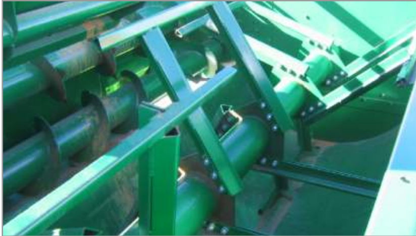
Figura I I.32. Interior de mixer de mezcla vertical con paletas divididas, para repartir el esfuerzo y sinfines para el traslado longitudinal del forraje.
