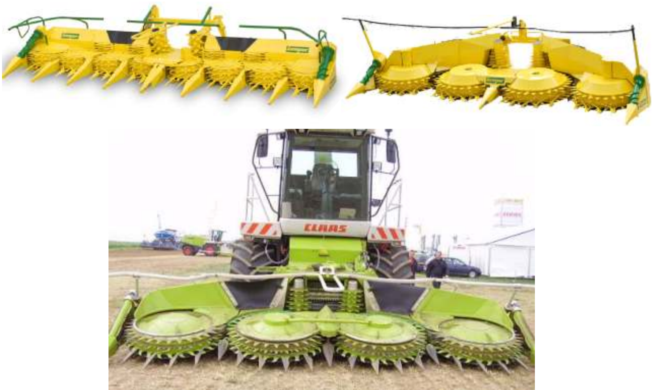
Figura 7.9. Diferentes tamaños de los cabezales de surcos independientes, siendo el más grande que ingresó al país, de 7,5 m o 14 surcos a 52,5 cm.
