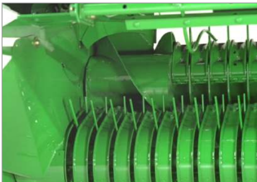
Figura 4.76. Sinfín de alimentación lateral del recolector ancho.
