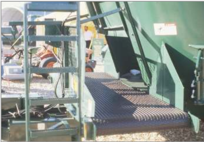
Figura I I.24. Sistema de descarga frontal con cinta de caucho que permite entregar el forraje a ambos lados del acoplado.
