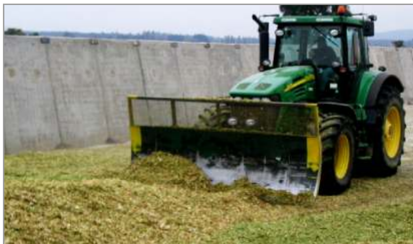
Figura 6.23. Los equipos con caja inversora permiten el trabajo en avance y retroceso haciendo el compactado más eficiente.
