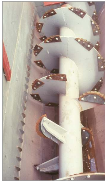
Figura 11.30. Sistema de 1 sinfín con cuchillas y barra batidora central.
