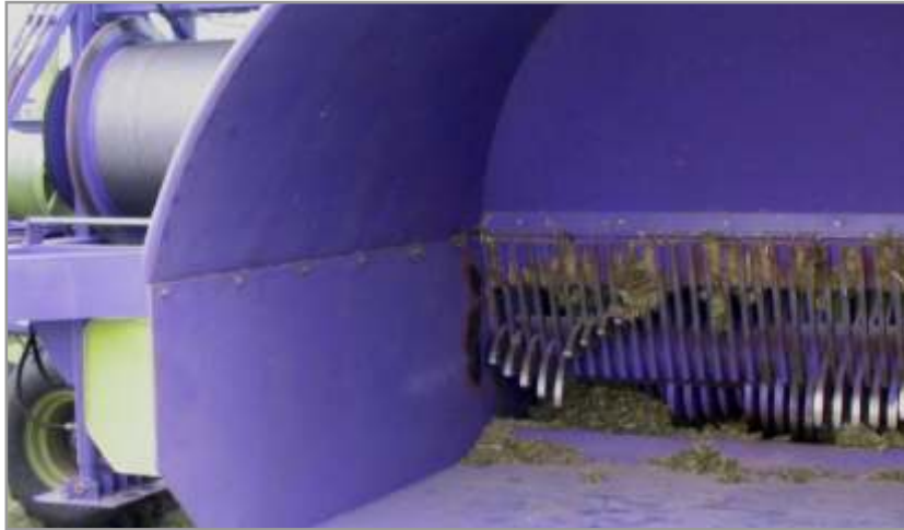
Figura 10.23. Túnel de compactación de largo considerable, que permite incrementar la densidad del silo, con igual estiramiento de las bolsas.
