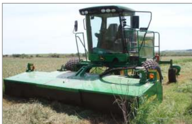
Figura 4.13. En la actualidad se encuentra más justificada la incorporación de máquinas de corta hilerado con acondicionador de mayor ancho de corte, por ello su demanda va en continuo crecimiento.
