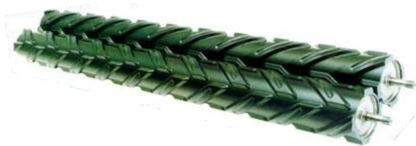
Figura 4.41. Rodillos acondicionadores de caucho.
