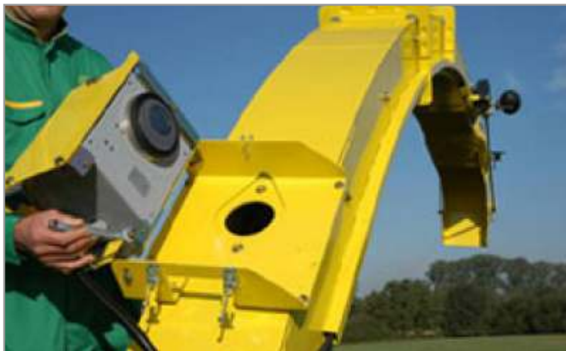
Figura 7.31. Sistema de medición de calidad de infrarrojo cercano (NIRS), montado en el sistema de descarga de la picadora.
