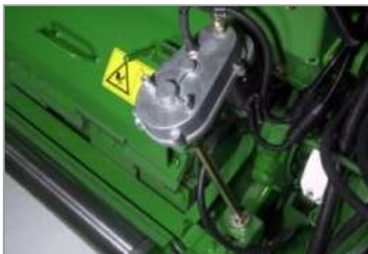
Figura 7.25. Mecanismo de ajuste de la contracuchilla.
