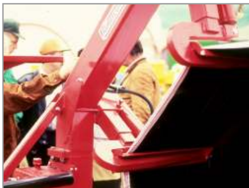
Figura 5.30. Detalle de las uñas que sujetan la bolsa para su estiramiento.
