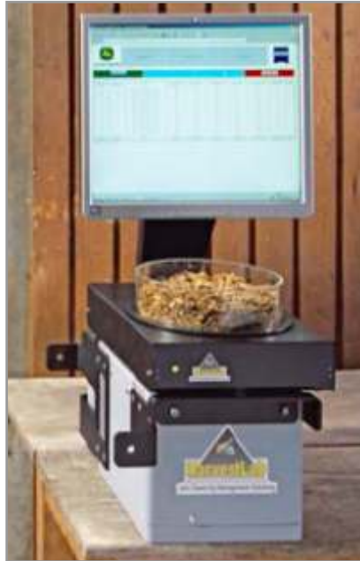
Figura 7.31. El mismo aparato se desmonta de la picadora para ser utilizado, en los establecimientos para medir calidad de otros forrajes.
