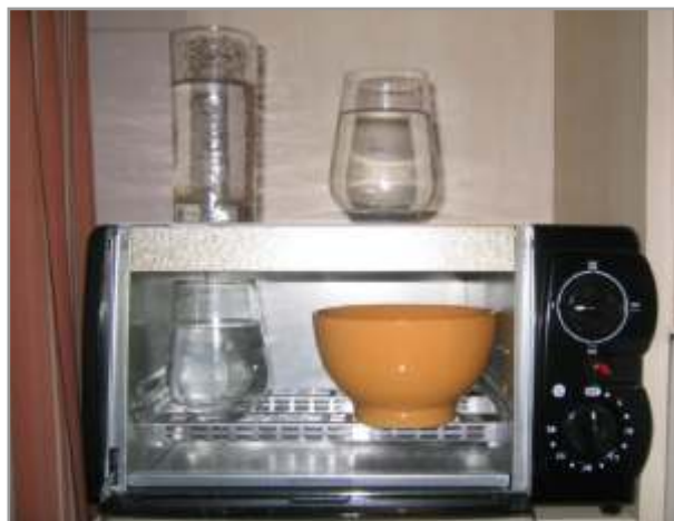
Figura 5.9. El uso del microondas es un método práctico y confiable para la determinación del porcentaje de humedad de forrajes húmedos.
