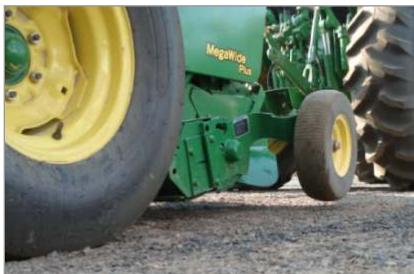
Figura 4.80. Se observa en la correcta regulación que la rueda de copiado no toca el suelo.
