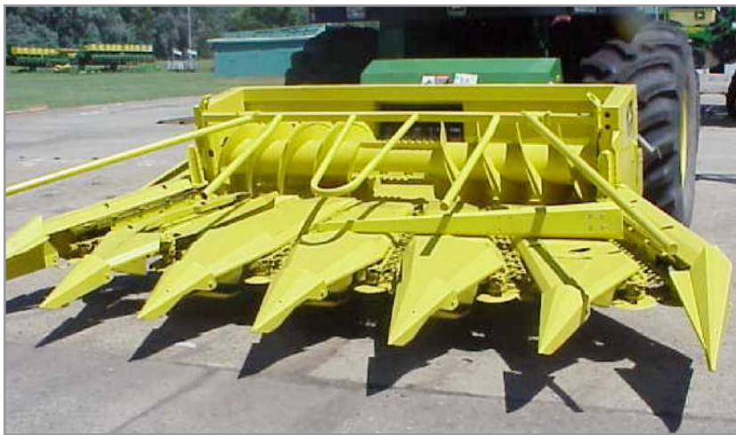
Figura 7.7. Sistema de cabezales de corte para cultivos en hileras.
