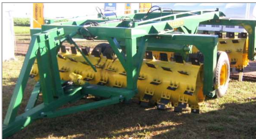
Figura 4.12. Rolo renovador de pasturas doble, con el cuál sería necesario realizar solo una pasada.
