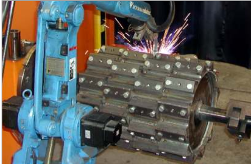
Figura 7.21. Proceso de fabricación del cilindro picador cerrado y con alta inercia.
