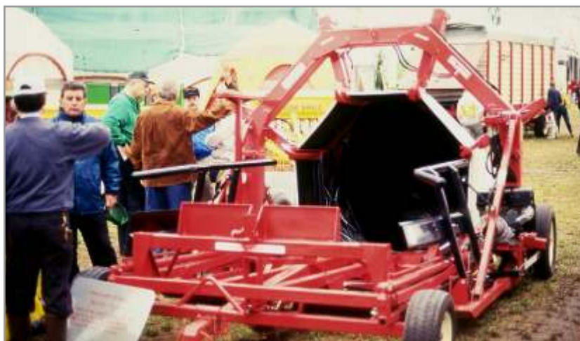
Figura 5.29. Vista de la embolsadora con motor incorporado.
