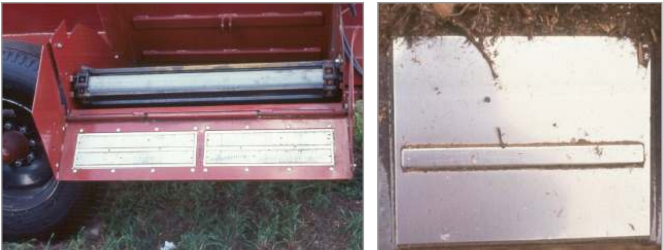
Figura I I.26. Trampas de metal para prevenir accidentes por la ingestión de cuerpos metálicos en la ración.
