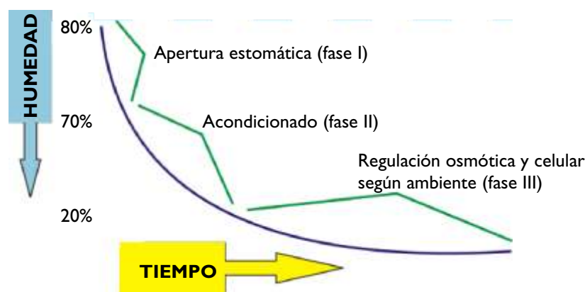
Figura 4.15. Curva de la dinámica de pérdida de humedad del forraje.
