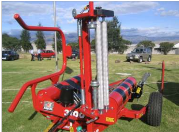
Figura 5.16. Unidad de carga en posición de depositar el rollo sobre la mesa propiamente dicha.
