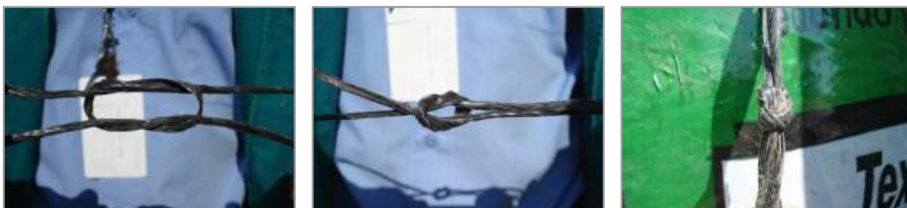
Figura 4.67. Secuencia de formación del nudo plano que facilita el pasaje del hilo.
