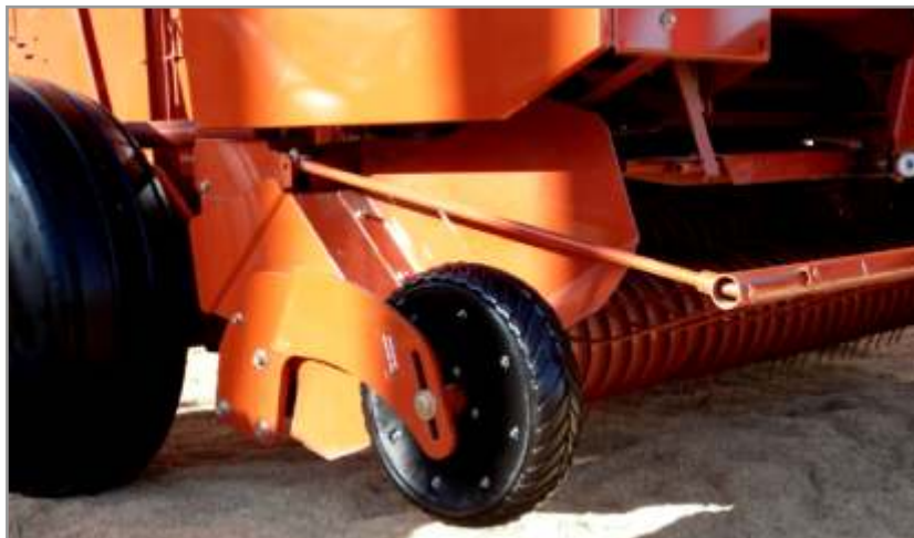
Figura 4.79. Rueda de copiado con regulación de altura de la misma.
