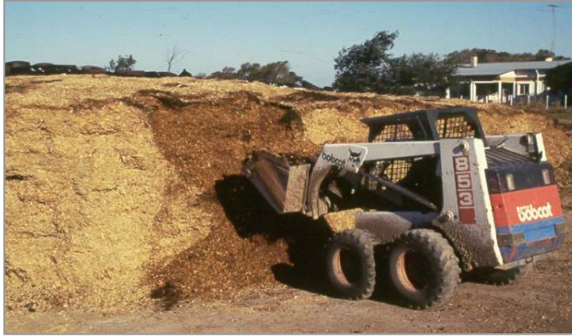
Figura 11.2. Primero se debe raspar la superficie del silo para luego cargar el material disgregado.
