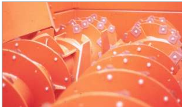
Figura 11.29. Dos sinfines horizontales con cuchillas periféricas.
