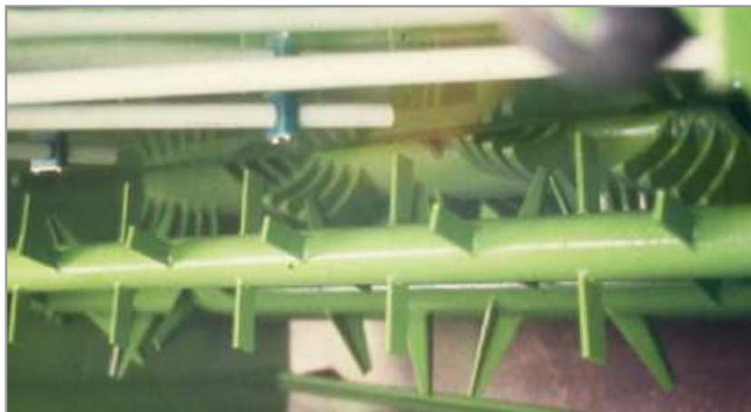
Figura 10.1. La aplicación de aditivos bacterianos sobre los rotores de alimentación de la embolsadora mejora la eficiencia de su uso.
