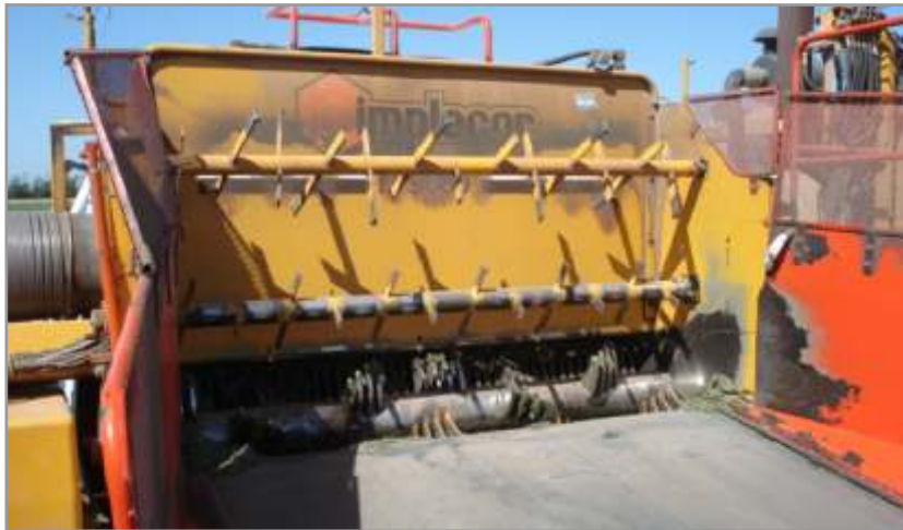
Figura 10.12. Máquina con cinta continua que mejora la uniformidad de la carga.
