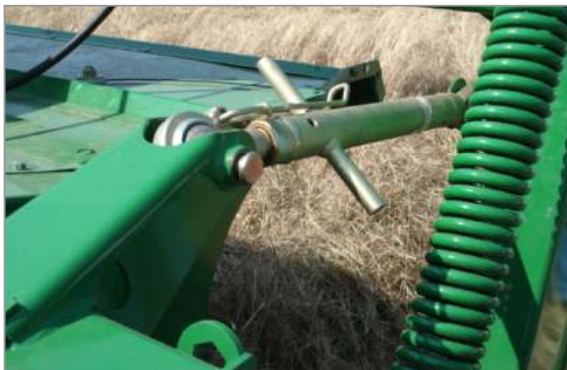
Figura 4.31. Dispositivo de doble rosca para regular la inclinación del ángulo de corte.
