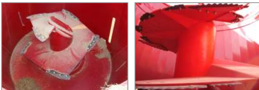
Figura I I.33. Vistas de los sinfines de mezclado y corte de fibra.
