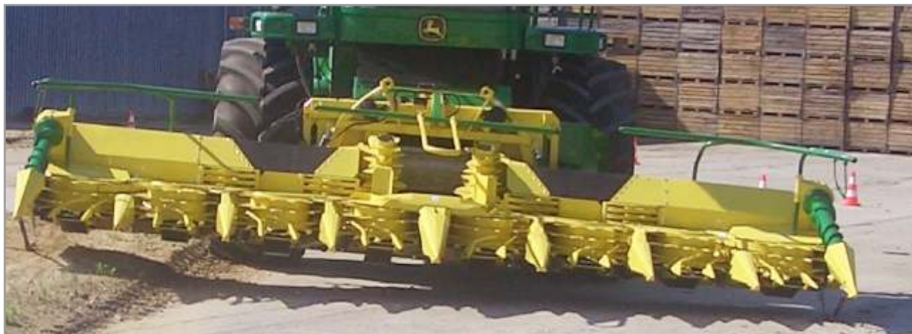
Figura 7.14. Regulación de inclinación y patín lateral de los cabezales.
