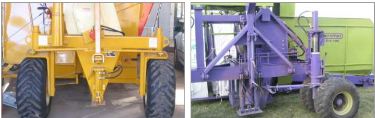
Figura 10.27. Sistemas de levante hidráulico para el cambio de posición de transporte y trabajo de las ruedas de la máquina.
