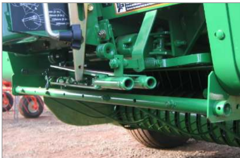
Figura 4.66. Sistema de doble aguja que acelera la operación de atado y mejora la calidad del heno confeccionado.
