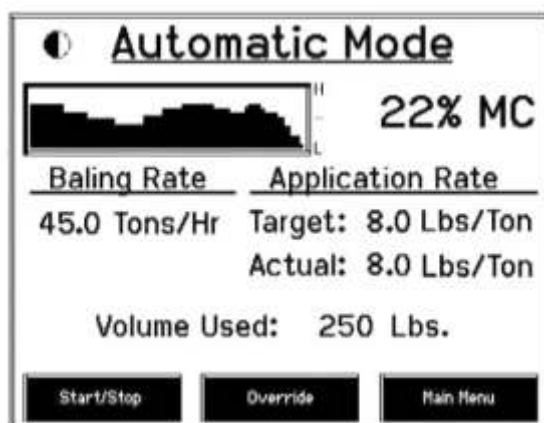
Figura 4.62. Diagrama de lectura del monitor de aplicación de preservante en tiempo real.
