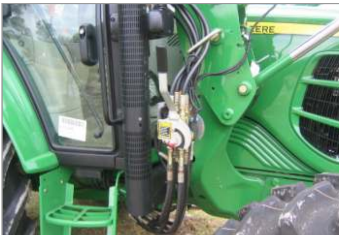
Figura 11.5. Sistema de acople rápido de sistemas hidráulicos para liberar el tractor.
