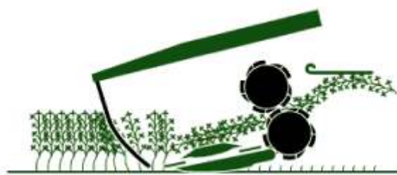
Figura 4.40. Esquema de trabajo de un sistema de acondicionado mediante rodillos.
