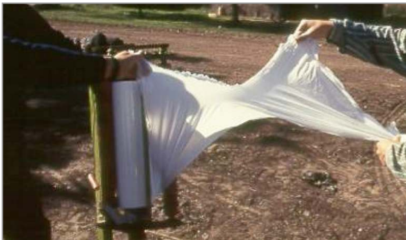
Figura 5.13. Prueba de desgarramiento para verificar la calidad del film.
