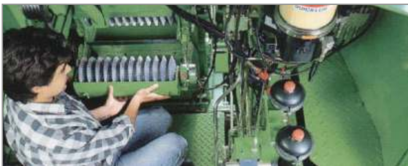
Figura 7.29. Intercambiando los rodillos partidores.
