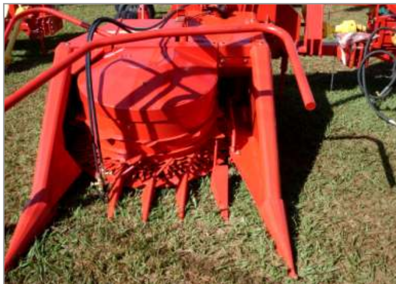
Figura 6.19. Cabezal rotativo de una máquina de arrastre.
