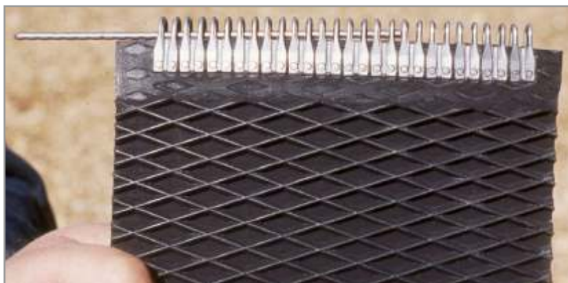
Figura 4.83. Perno acerado de las uniones de correas que les permiten mayor flexibilidad.
