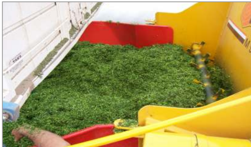
Figura 8.15. El rotor superior ayuda a ir "enrazando" el material en la bandeja de descarga.
