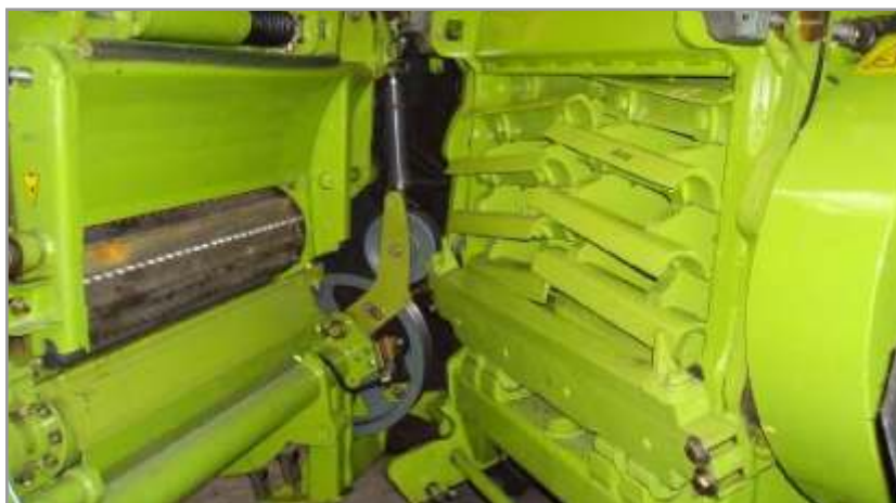
Figura 7.37. Nuevo rotor picador CLAAS Jaguar 980 con filo de corte vertical, más duración del filo y mejor corte. Menos consumo de potencia y mayor rendimiento por CV consumido.
