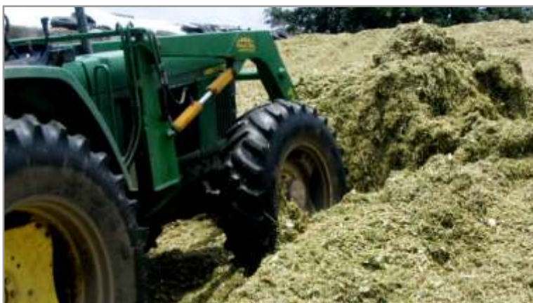
Figura 6.22. Cuando se baja demasiado la herramienta de desparramado o cuando no hay potencia suficiente se puede producir patinaje, creando zonas de baja densidad en el silo.
