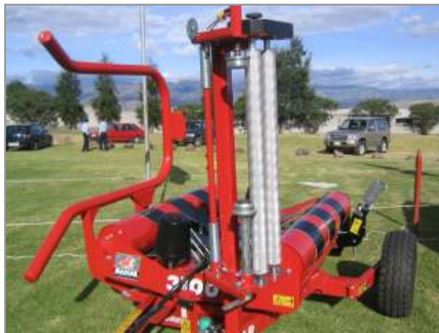
Figura 5.28. Portabobina, para film de 1 m de ancho.
