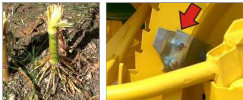
Figura 7.10. El daño de los tallos es conveniente para mejorar las condiciones agronómicas y mecánicas de los lotes picados. A la derecha planchuela que daña el borde del tallo.
