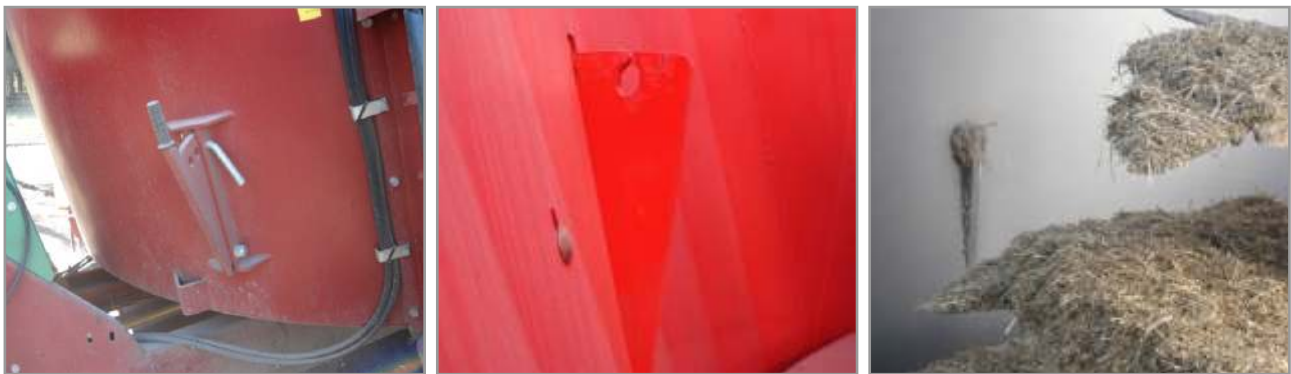
Figura 11.35. Exterior e interior de los frenos que determinan el grado de cortado o desmenuzado de la fibra del incorporada a la ración.
