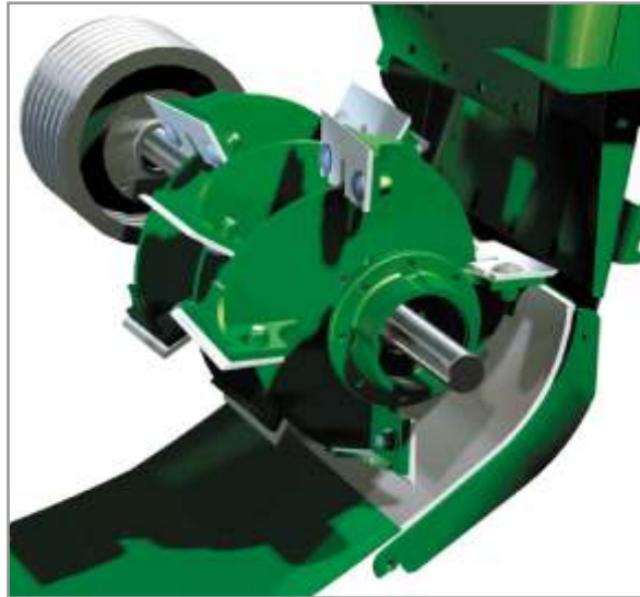
Figura 7.30. Esquema del acelerador o soplador de forrajes de las máquinas picadoras.
