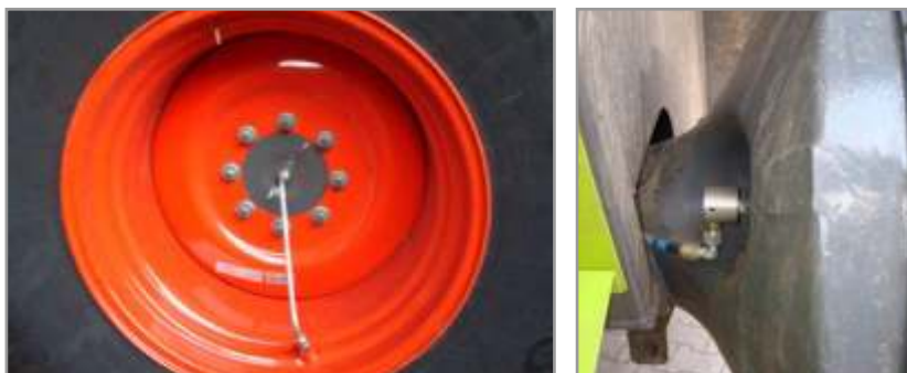
Figura 7.36. (Izq.): Neumático de presión regulable en CLAAS Jaguar 980, el cual disminuye su presión de inflado cuando esta trabajando y aumenta su libraje cuando la maquina se transporta. (Der.): paliere agujereado para pasar aire, esta novedad parece marcar un nuevo paradigma sobre la transitabilidad de las máquinas sobre el suelo agrícola, donde la baja presión de inflado determina el nivel de huellas y compactación.
