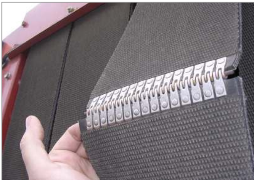
Figura 4.82. Unión de correa flexible que aumentan la vida útil de las mismas.
