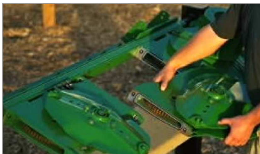
Figura 4.28. Plataforma de corte de secciones independientes.
