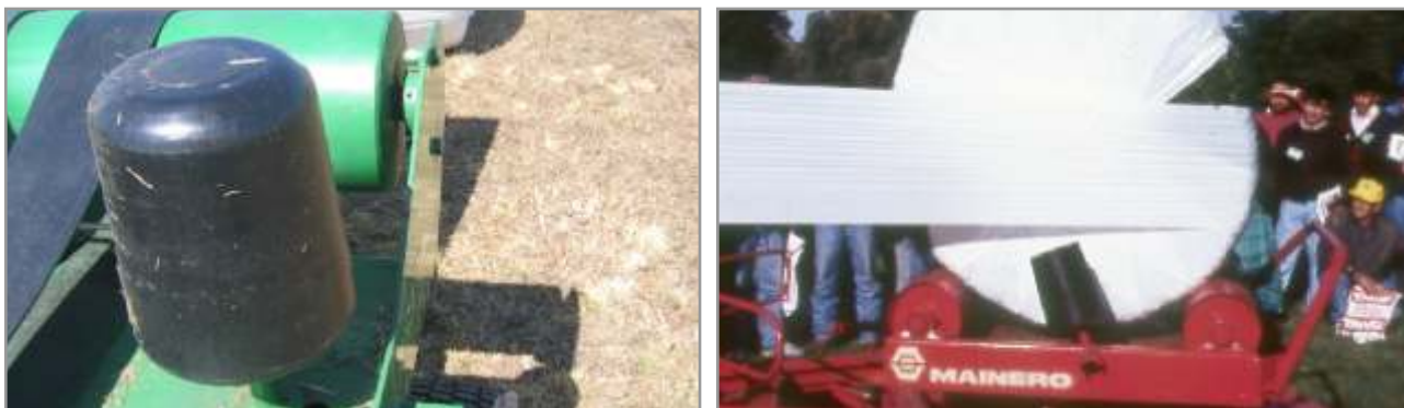
Figura 5.20. Se puede observar contra el rollo, el tope que permite que gire sin desequilibrarse sobre la mesa.
