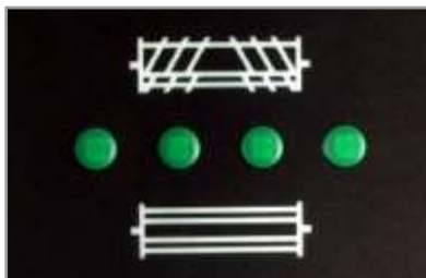
Figura 7.19. Indicador de la sección en la que fue detectado el cuerpo metálico.
