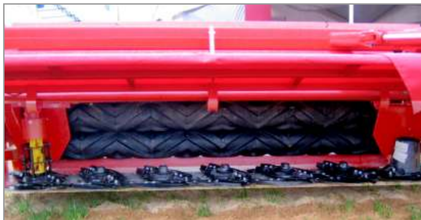
Figura 4.24. Cortadora acondicionadora de discos con cuchillas cortas.
