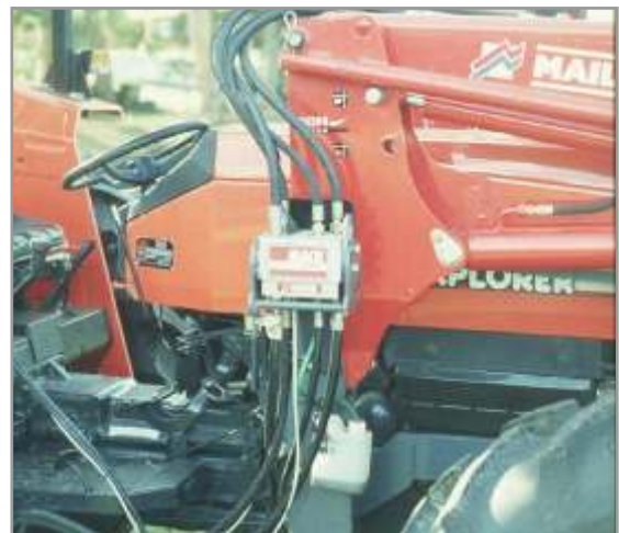
Figura 11.5. Sistema de acople rápido de sistemas hidráulicos para liberar el tractor.
