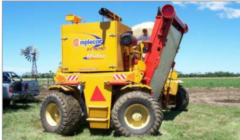
Figura 10.26. Embolsadora autotransportable, con cuatro ruedas móviles y transmisión hidráulica en las mismas.
