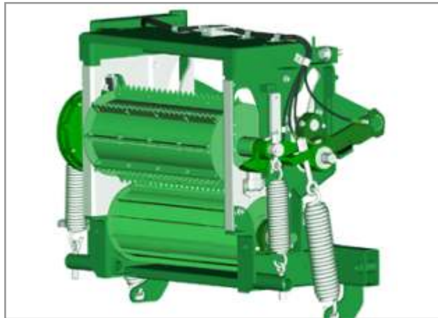
Figura 7.15. Esquema de los resortes de tensión de los rodillos de alimentación.
