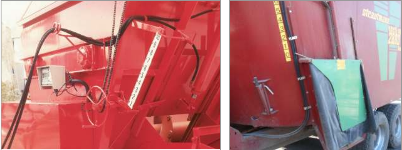
Figura I I.25. Regla indicadora de la apertura de la puerta de descarga.
