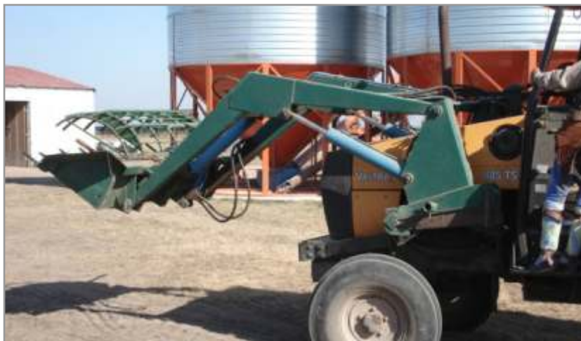
Figura 11.3. La gran distancia del balde al eje del tractor aumenta el brazo de palanca e incrementa la fatiga del tren delantero.
