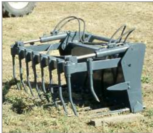
Figura 11.11. Aditamento específico para la extracción de silaje acoplado a un cargador frontal.
