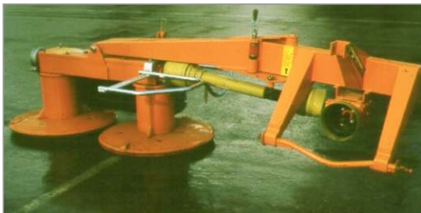
Figura 4.23. Cortadora de tambores con mando superior.
