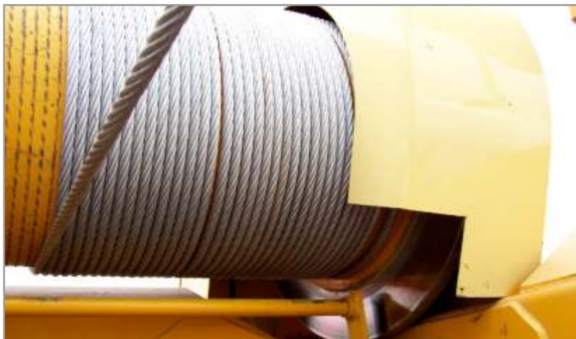
Figura 10.15. Rotor con el cable de acero que se fija a la red para ejercer el "freno" de la máquina.
