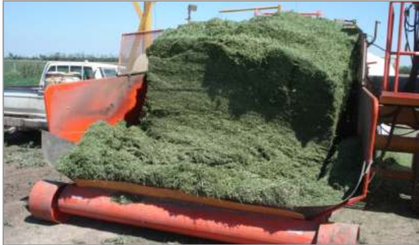
Figura 8.8. Cuando se observa que quedan formadas paredes en material descargado, se puede estimar que se está trabajando en el rango de humedad adecuado.
