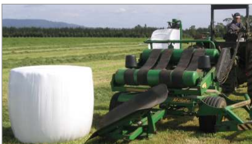
Figura 5.25. Rampa e descarga de doble acción que permite depositar el rollo parado sobre su cara plana.
