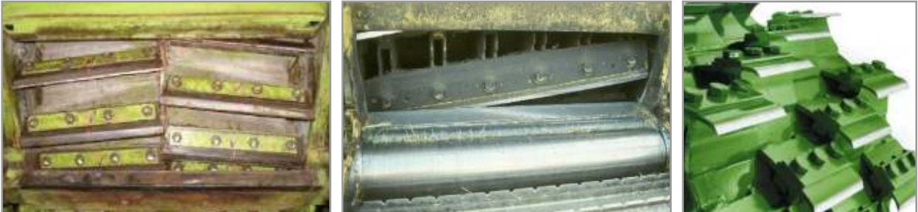
Figura 7.3. Diferentes tipos de cuchillas, Seccionadas en "V", continuas o enteras y seccionadas con ángulo.
