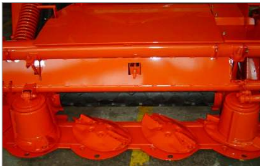
Figura 4.29. Máquina con espacio entre la barra de corte y los rodillos acondicionadores.
