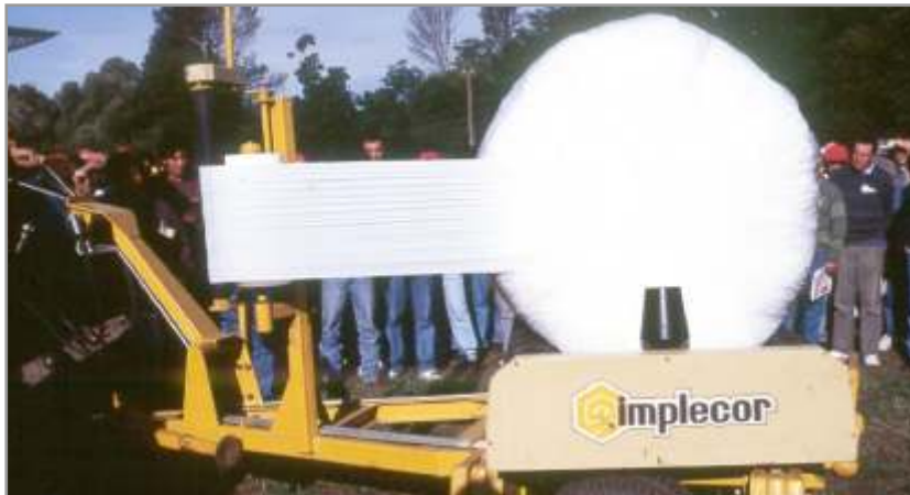
Figura 5.27. La bobina siempre debe estar alineada con el centro del rollo para que la cobertura se aplique correctamente.
