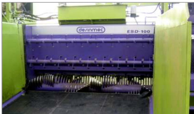
Figura 10.13. Máquina con doble batidor de material para uniformar la carga.
