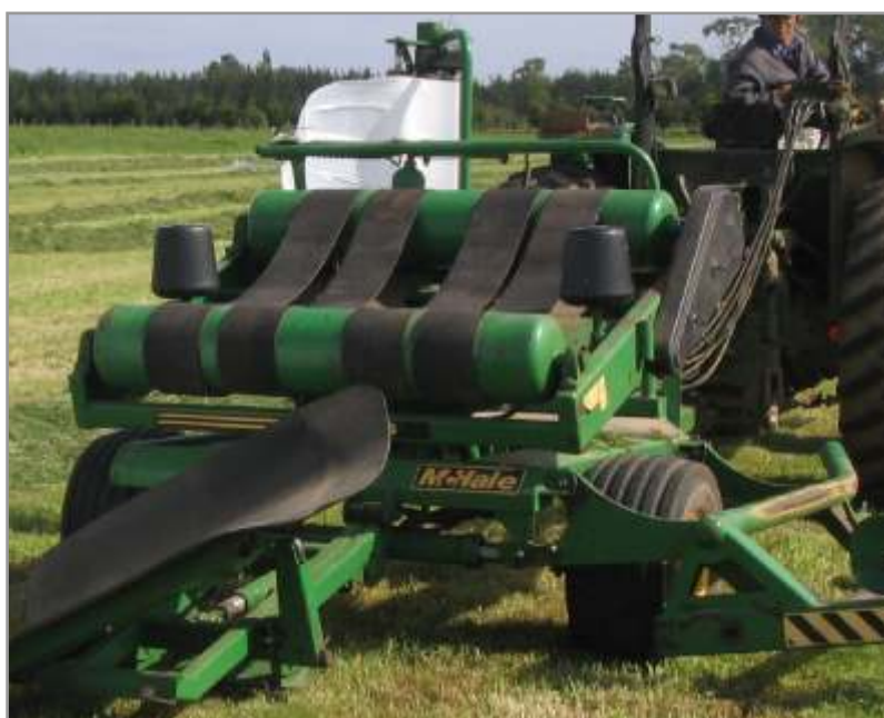
Figura 5.19. Mesa empaquetadora con cuatro correas para la correcta tracción del rollo.
