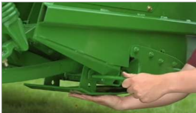
Figura 4.30. Patín de copiado lateral de fácil regulación.
