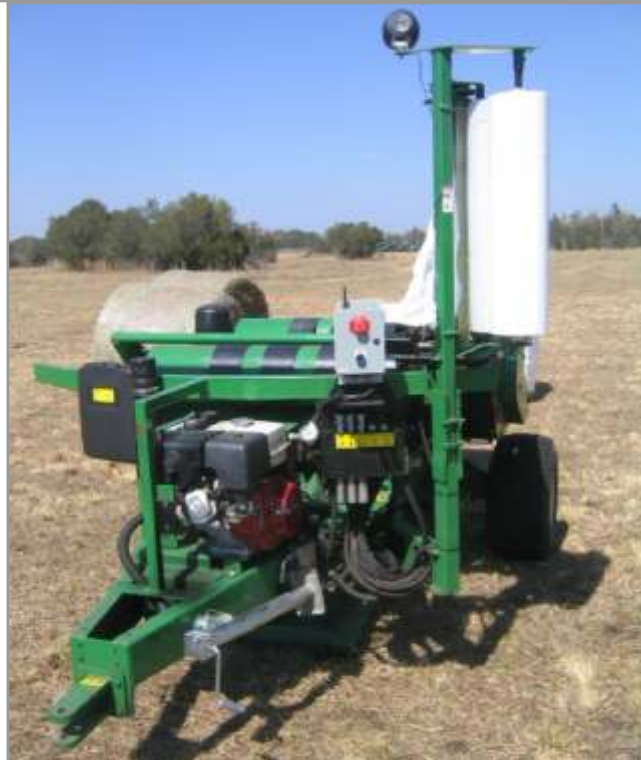
Figura 5.34. Empaquetadora individual con accionamiento a distancia y motor incorporado.
