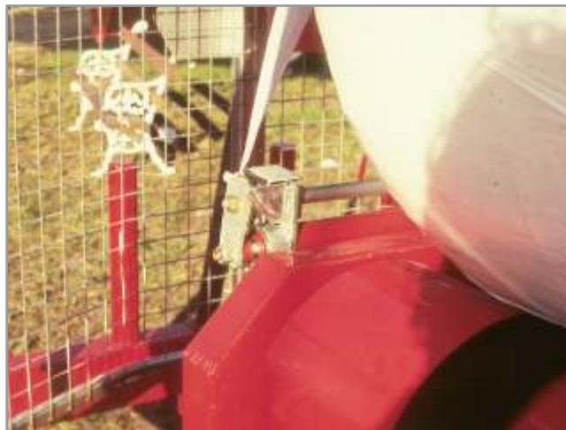
Figura 5.23. Detalle del cortador automático del film.
