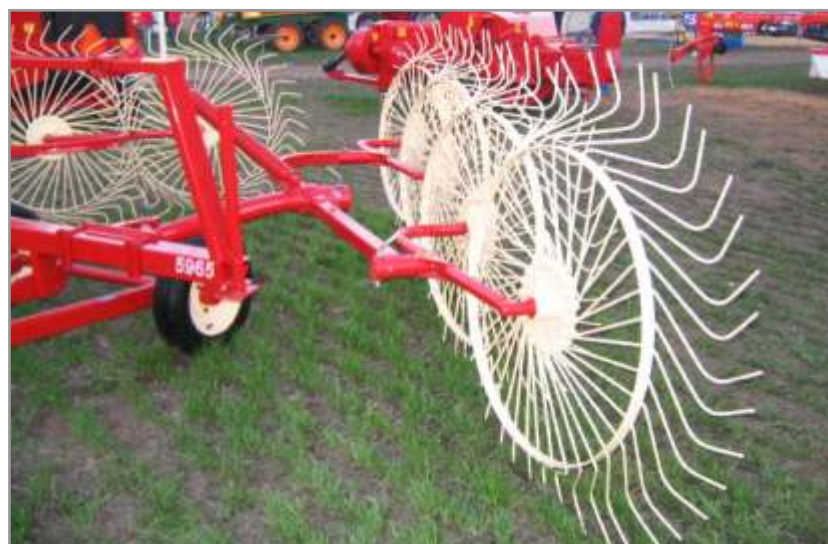
Figura 4.49. Rastrillo estelar (en “V”) con diseño de ruedas montadas sobre balancín.
