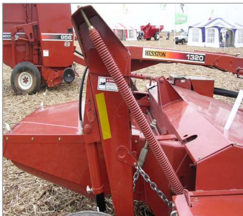
Figura 4.26. Resortes de flotación en los que se encuentra suspendida la plataforma de corte.
