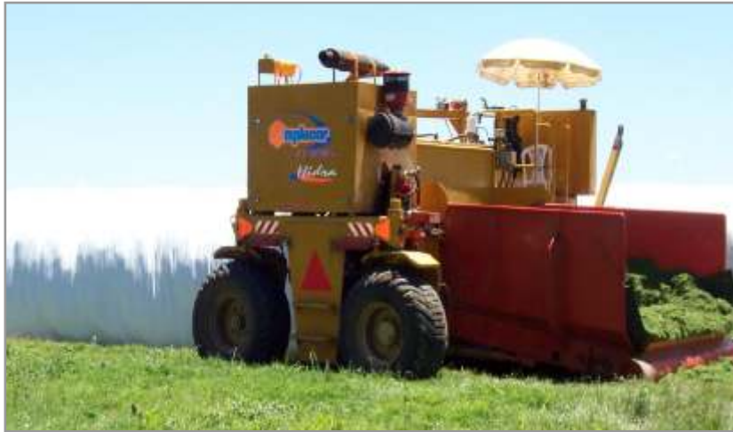
Figura 10.28. Máquina embolsadora con el puesto de comando ubicado en el lateral opuesto al motor.
