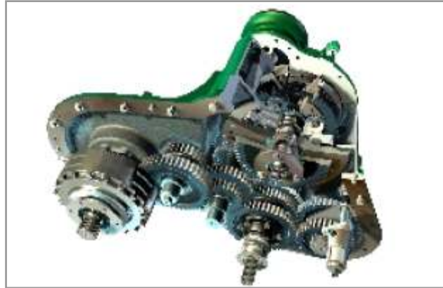
Figura 7.18. Sistema de variación infinita de la velocidad de alimentación del forraje.
