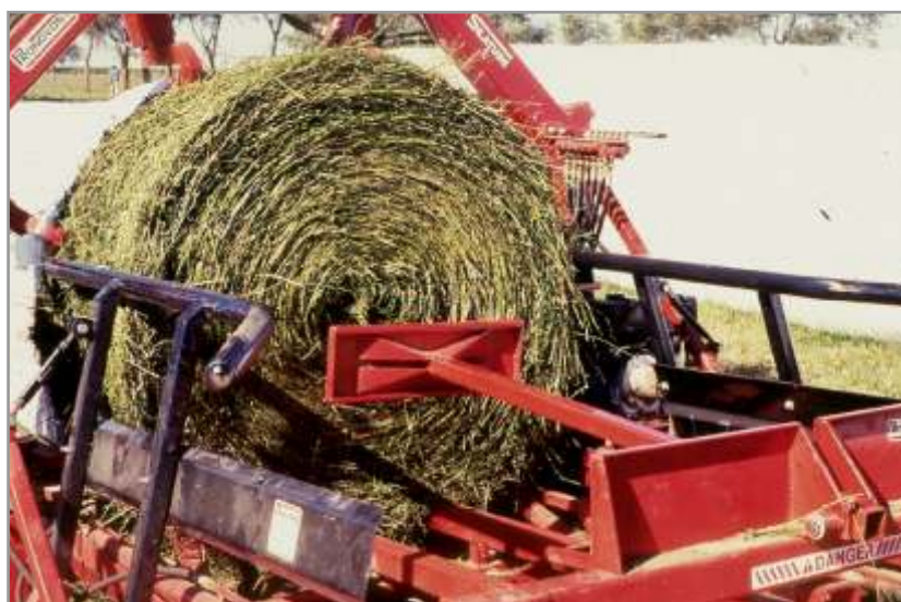
Figura 5.33. Pistón extensión para introducir el último rollo en la bolsa.
