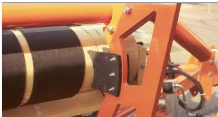
Figura 5.21. Tope/freno de goma que impide que se abran las correas.
