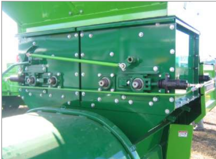
Figura 10.30. Sistema de ajuste de los rodillos quebradores de granos.
