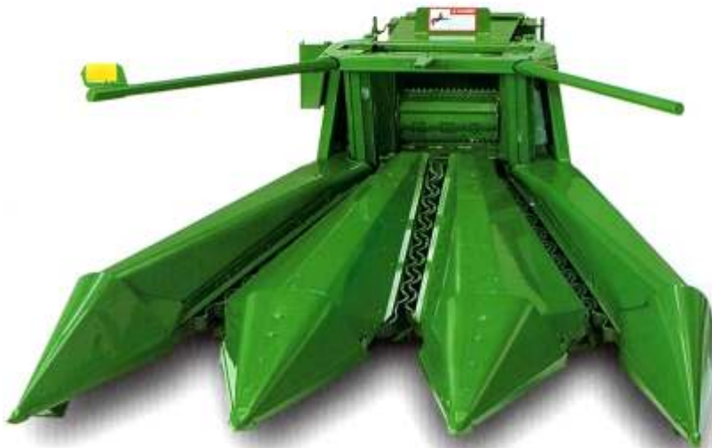
Figura 6.18. Cabezal con sistema de corte en el extremo de los puntones y sistema de espalderas, que evita la caída y el arrancado de plantas además de menor requerimiento de potencia por no traccionar las plantas.
