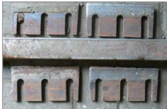
Figura 7.22. Muestras de desgaste de cuchillas y contra-cuchillas en suelos con piedras.
