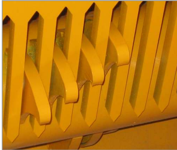
Figura 10.14. Detalle de dientes con frente cambiable para mejorar y reducir costos en el servicio.
