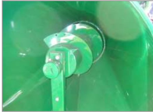
Figura 10.29. Sinfín de compactación dentro del túnel.
