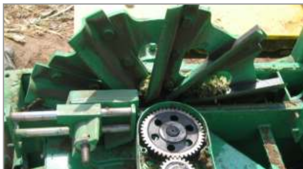
Figura 7.2. Sistema de picado de volante con cuchillas radiales que pican e impulsan el forraje en forma simultánea.
