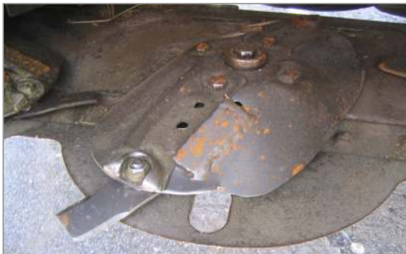
Figura 4.27. Refuerzo soldado en un disco de corte. Esta es una práctica perjudicial para la vida útil de la máquina (desbalanceo perjudicial para la vida útil del sistema de mando).
