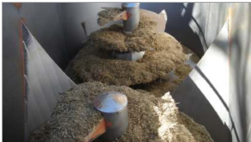
Figura 11.36. Doble sinfín de mezclado en acoplado de mayor capacidad de carga y trabajo.
