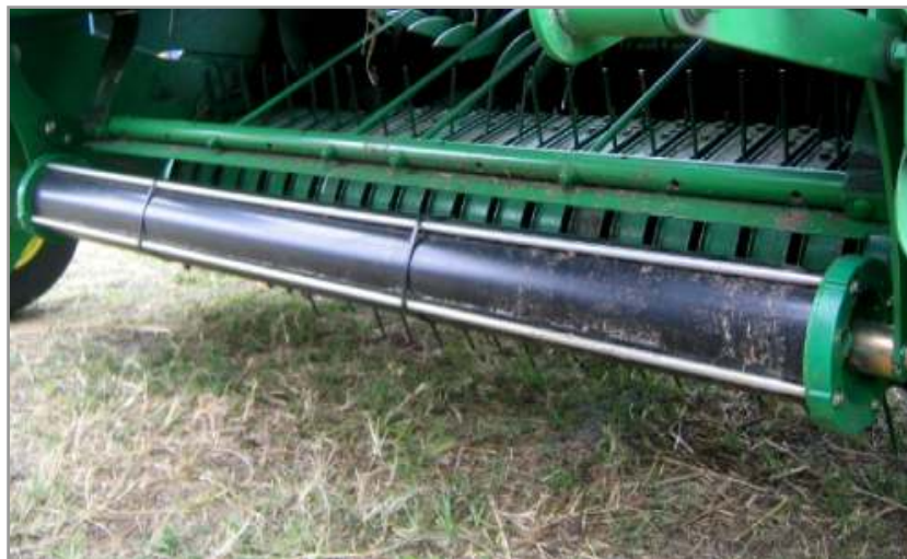
Figura 4.74. Rodillo flotante de precompresión del forraje que mejora las condiciones de recolección.
