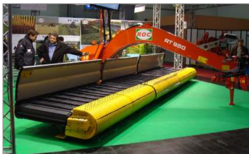
Figura 4.54. Innovación: juntador de andana de forraje ROC de 9,5 metros de ancho. Aluminio, caucho, plástico, polímeros, hidráulico, sistema electrónico; todo un equipo de alta tecnología al servicio del forraje conservado.
