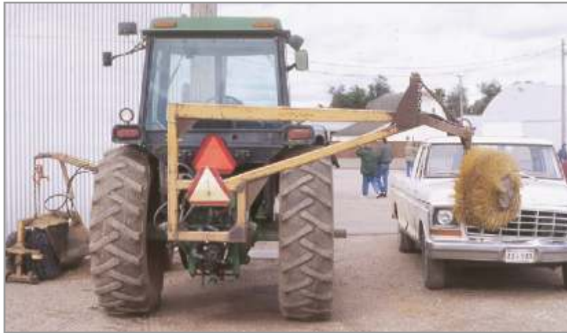
Figura 11.41. Herramienta para limpieza mecánica de comederos de sección continua.
