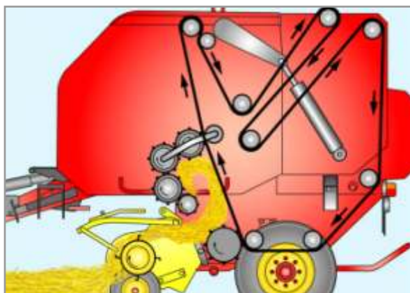
Figura 4.72. Máquina con sistema de compactación mixto, de rodillos y correas.
