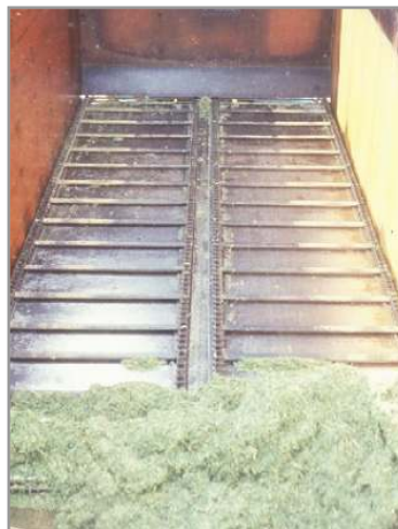
Figura 8.13. Los acoplados con cadenas en el piso mejoran la descarga y confección de las bolsas de pasturas.
