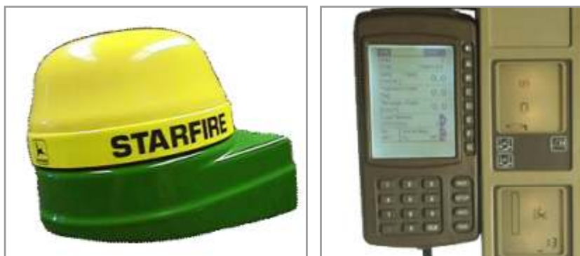
Figura 7.33. Monitor que capta la información del sensor de flujo (der) y de la antena GPS (izq).
