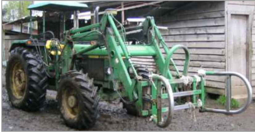
Figura 5.36. Dispositivo para mover rollos empaquetados sin riesgo de rotura del plástico.
