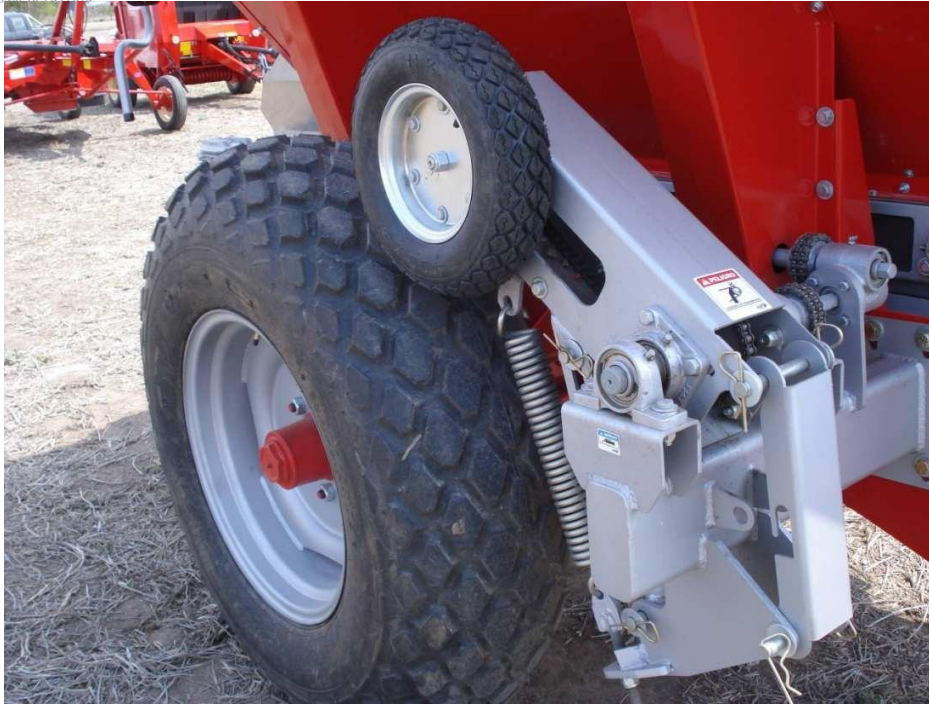
Figura 6: Cuando la velocidad de la cinta es controlada por una rueda vinculada a la rueda de transporte se mantiene la dosis por hectárea aunque se modifique la velocidad de avance.
