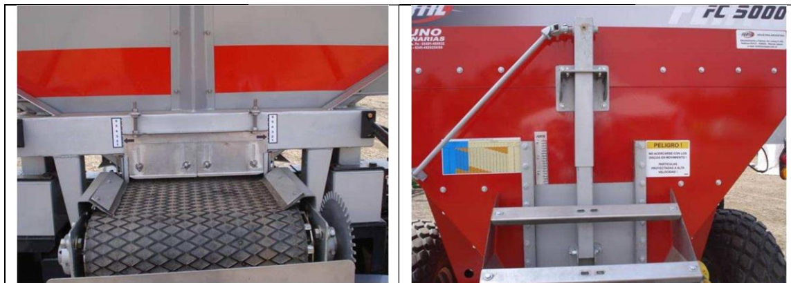
Figura 5: Variación del caudal erogado en fertilizadoras de gran ancho de trabajo. Se modifica la apertura de la compuerta y/o la velocidad de la cinta transportadora. En la imagen de la derecha se observa una tabla indicativa del caudal erogado en función de la altura de la compuerta y la velocidad de la cinta
