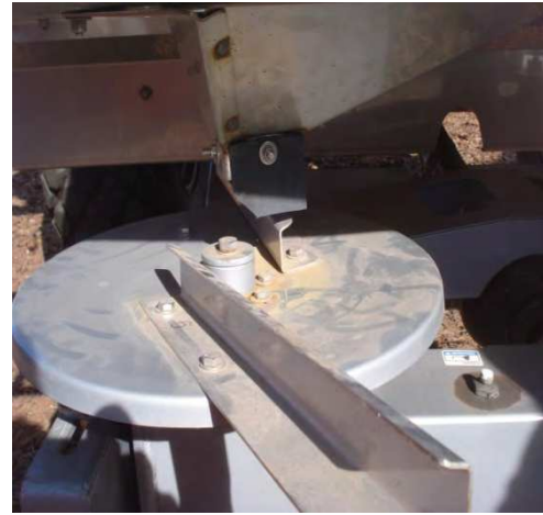
Figura 55. a) Modificación del largo de las paletas de forma continua. b) Presencia de paletas de distinta longitud
