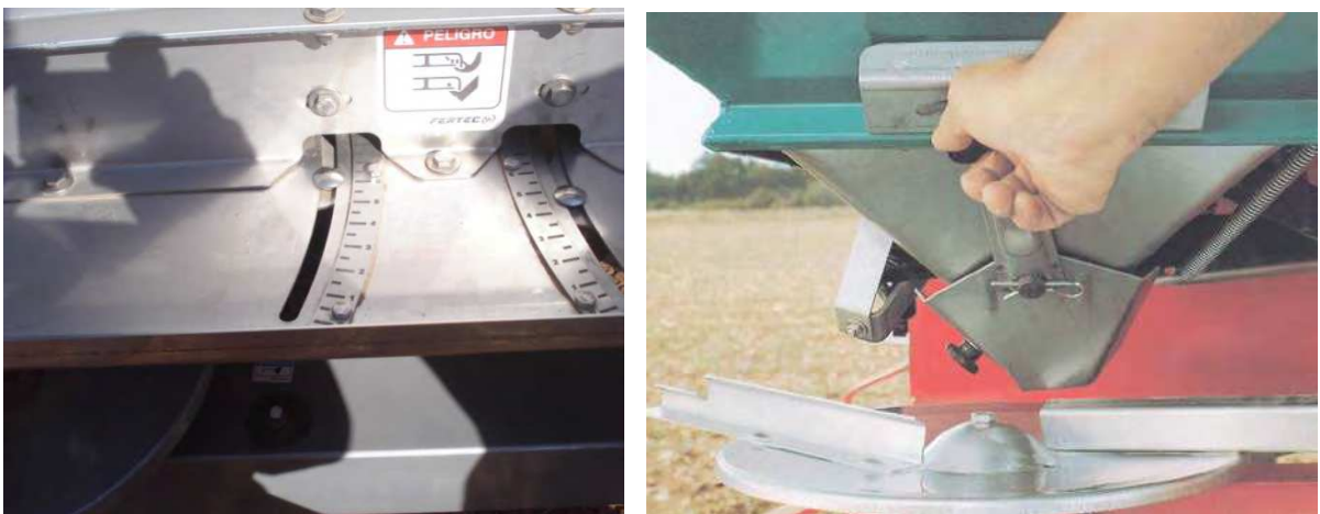
Figura 54. Regulación en función del ángulo y del radio en forma conjunta.
